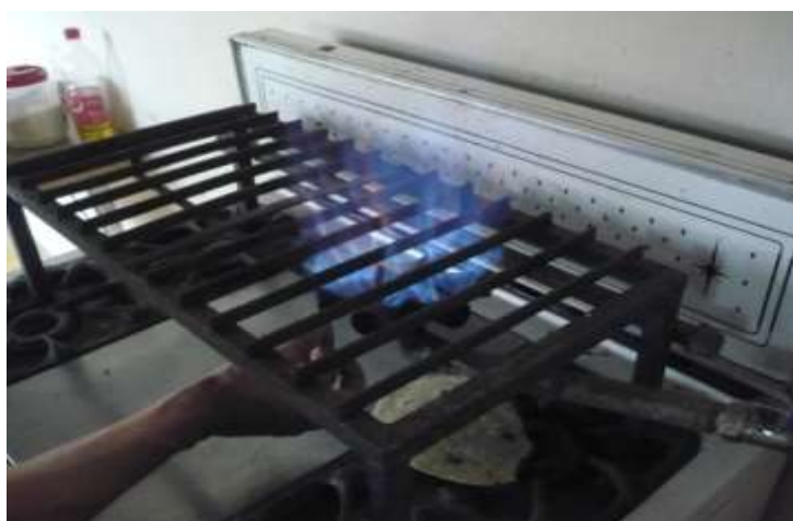
Imagen 5.22.- Quemador encendido a base del biogás producido.
