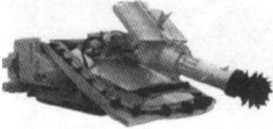
Imagen IV.4.4.3. Rozadora (Milling), vista lateral
