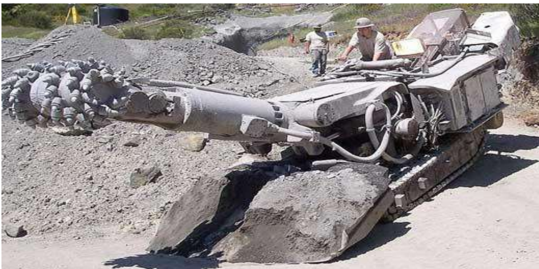
Imagen IV.4.4.2. Rozadora (Milling), carga de escombros de carrusel con paleta
