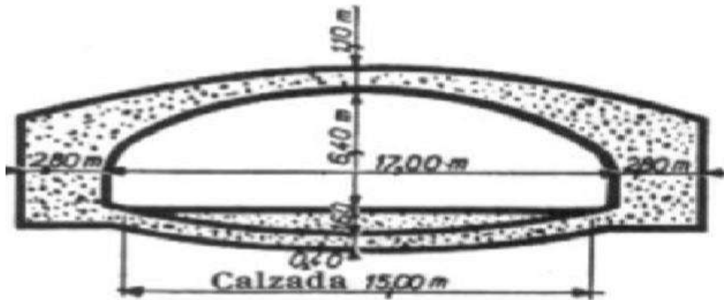
Figura III.5.2.2. Túnel de carretera en Saint-Cloud (Paris)
