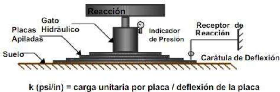
Figura 2.5.2 Prueba de Placa (ASTM D1195 y D1196).
