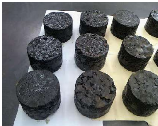
Fig.-4.2.12. Pastillas de diferente % C.A.
