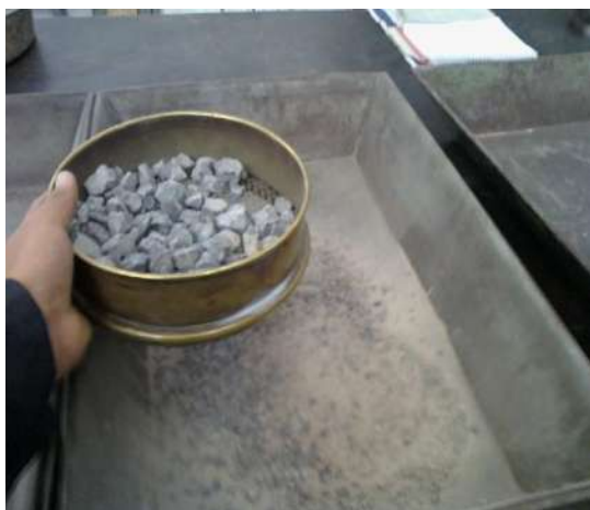
Fig. 2.4.1.- Cribado de material
