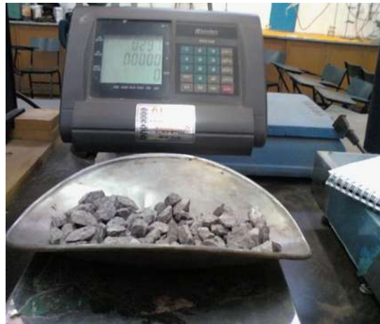
Fig. 2.5.4 Peso material Seco
