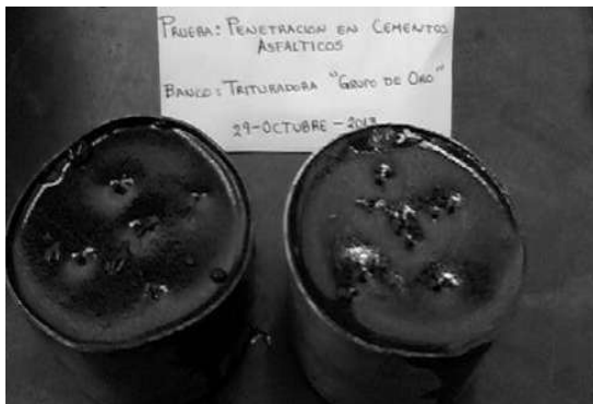
Fig.-3.3.7. Penetraciones en Cemento
