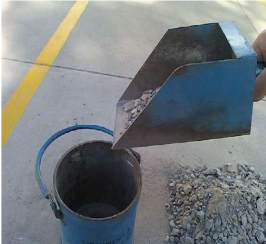
Fig. 2.3.3.- Llenado de Material
