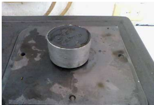
Fig.-3.3.8. Capsula con el cemento asfáltico.
