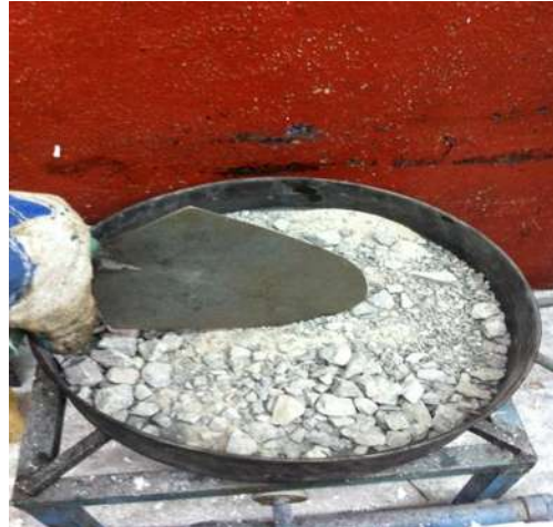
Figura 5.2.4.- calentamiento del pétreo.
