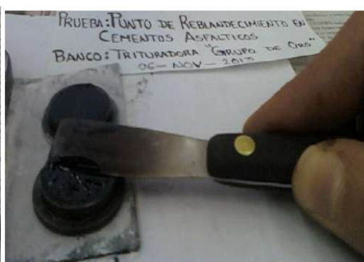
Fig.- 3.5.2. Enrasado de cemento en anillo.
