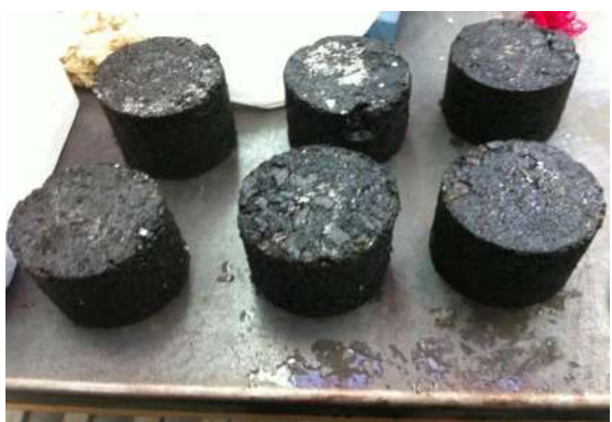
Figura 5.4.6.- Pastillas a saturar en agua.
