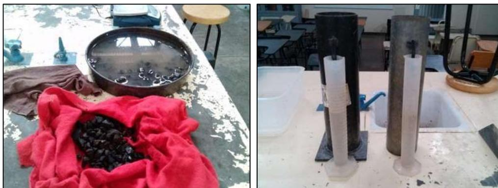
**Figura 1.31 prueba de la densidad en gravas**
