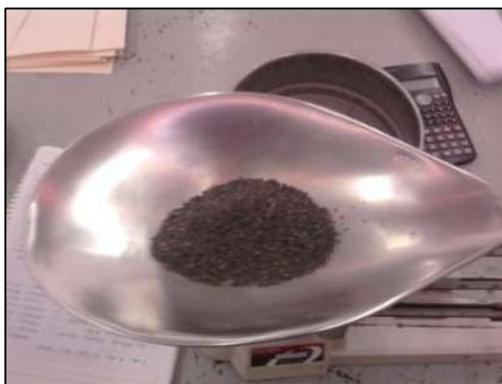
**Figura 1.25 Muestra de 500 gramos de arena para prueba de granulometría**
