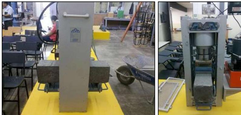
**Figura 1.42 Resistencia a flexión en vigas de concreto**
