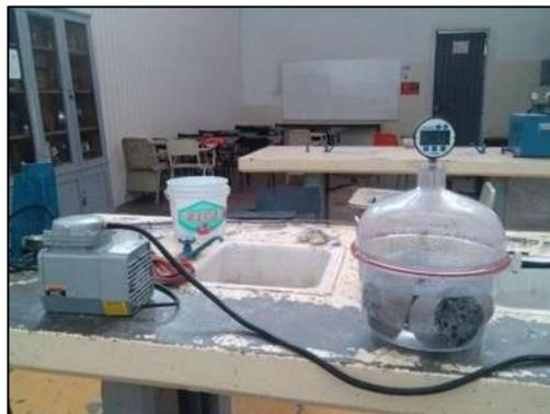
Figura 1.38 Especímenes en vacío durante 18 horas.
