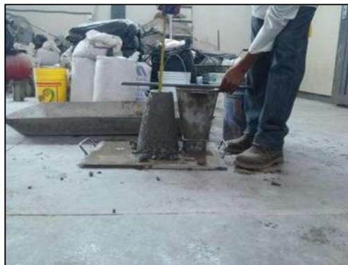
Figura 1.34 Determinación de revenimiento
