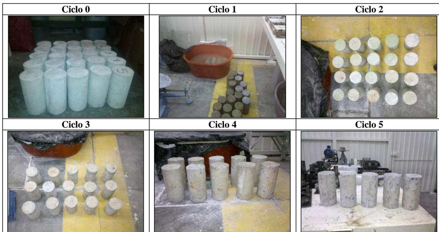
**Figura 1.43 Ciclos en la prueba de ataque acelerado con sulfato de sodio anhidro**
