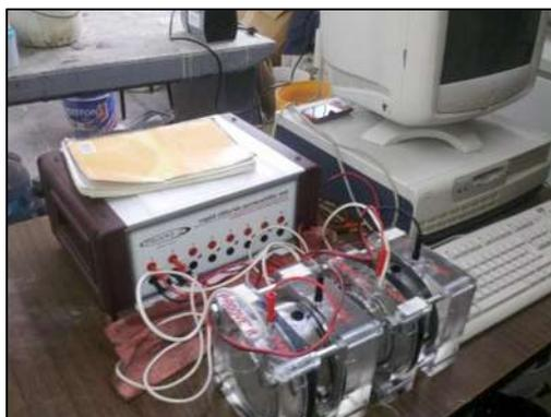
**Figura 1.37** Equipo de prueba para permeabilidad rápida a la penetración de cloruros.
