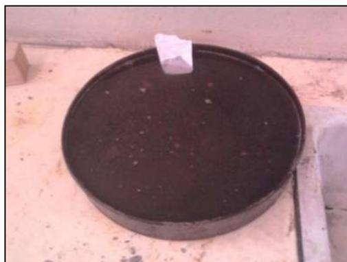
**Figura 1.20 Muestra de arena saturada**
