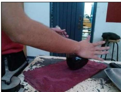
**Figura 1.22 Expulsando burbujas de aire de la muestra**
