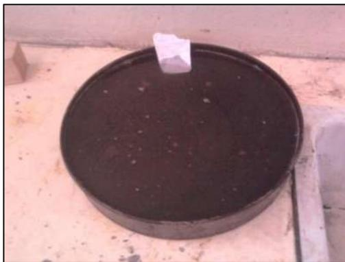
**Figura 1.16 Muestra de arena saturada**
