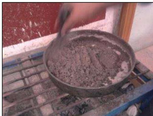
**Figura 1.19 Secando arena para eliminar el contenido de agua**
