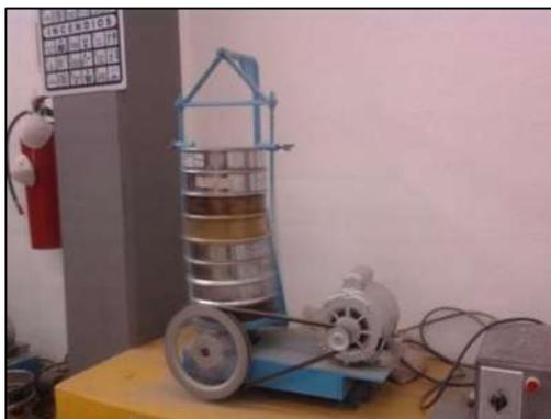
**Figura 1.26 Agitando el juego de mallas durante 10 minutos mecánicamente**
