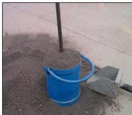
**Figura 1.24 Llenando recipiente para la prueba de MVSV en arena**
