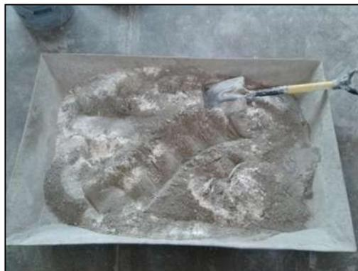
**Figura 1.32 Mezclado del cemento y el metacaolín**
