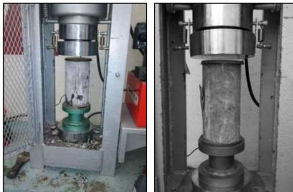
**Figura 1.41 Resistencia a compresión simple en cilindros**
