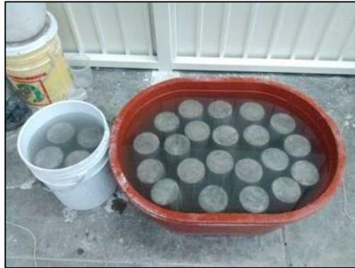
**Figura 1.40** Especímenes sometidos al sulfato de sodio anhidro
