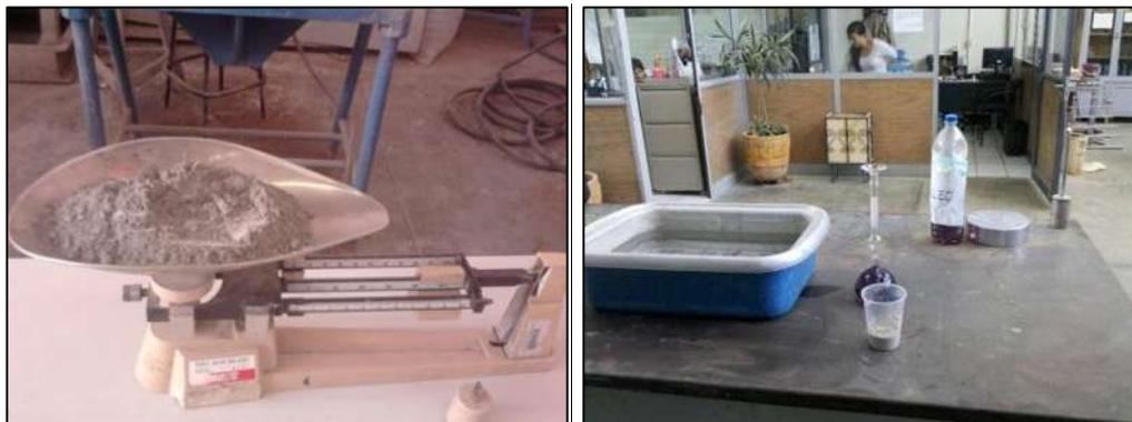
**Figura 1.11 Densidad aparente del Cemento Portland**
