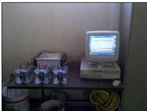
**Figura 1.39** Especímenes sometidos a la permeabilidad de los cloruros.
