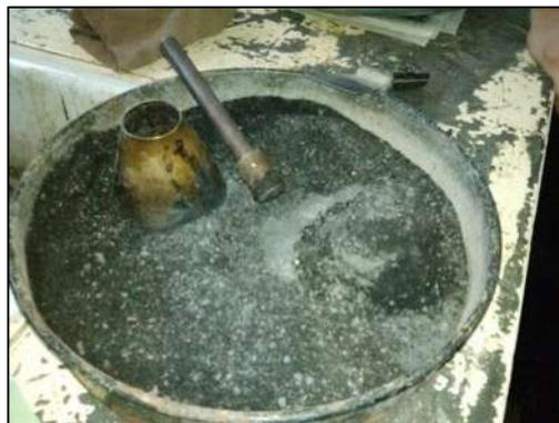
**Figura 1.17 Humedad superficial y de absorción en arenas**
