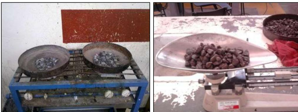
Figura 1.30 Secado y pesado de la grava para la prueba de humedad de absorción
