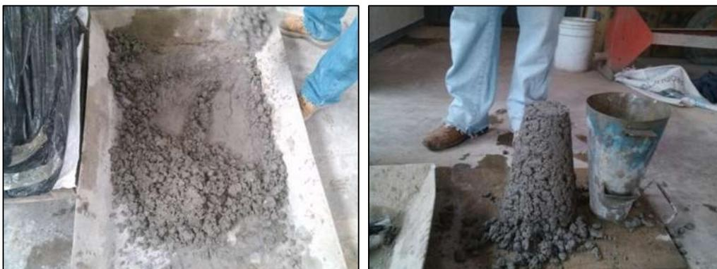
**Figura 1.33 Mezclas poco trabajables en sustitucion al 10 %**
