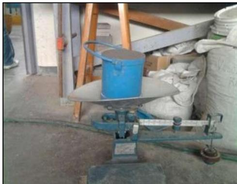
**Figura 1.23 Pesando muestra de arena para obtener MVSS en arena**
