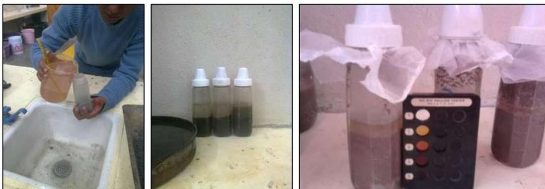
Figura 1.29 Prueba de colorimetria en arena
