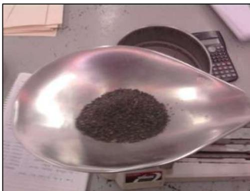
**Figura 1.28 Pesando las muestras de los materiales retenidos en las mallas**
