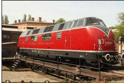
*Locomotora alemana V200 Diesel-hidráulica.*
