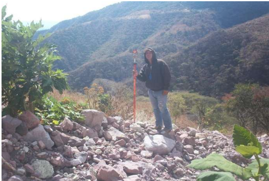
Levantamiento topográfico de terreno natural para obtener secciones transversales
