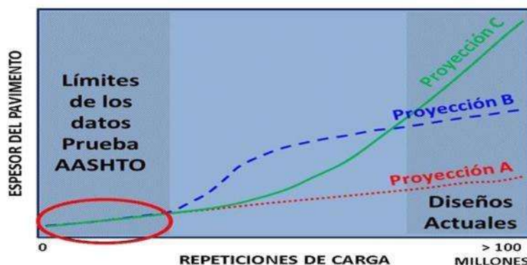
Imagen5.- Esquema con las limitantes de los ábacos de diseño de AASHTO. (Referencia: IMT - p.t. N° 258)
