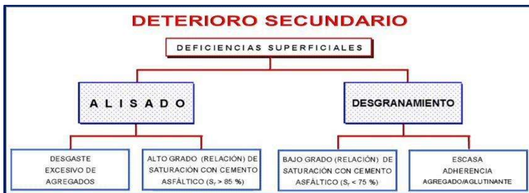
Imágenes 8 y 9. - Deterioros Primarios y Secundarios. Referencia: "Curso Mantenimiento y Rehabilitación de Pavimentos" - Dr. Raúl Vicente Orozco Santoyo.
