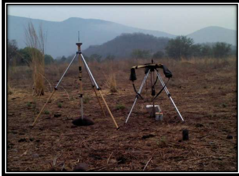
Figura 5.- Equipo utilizado para el levantamiento topográfico, GPS.
