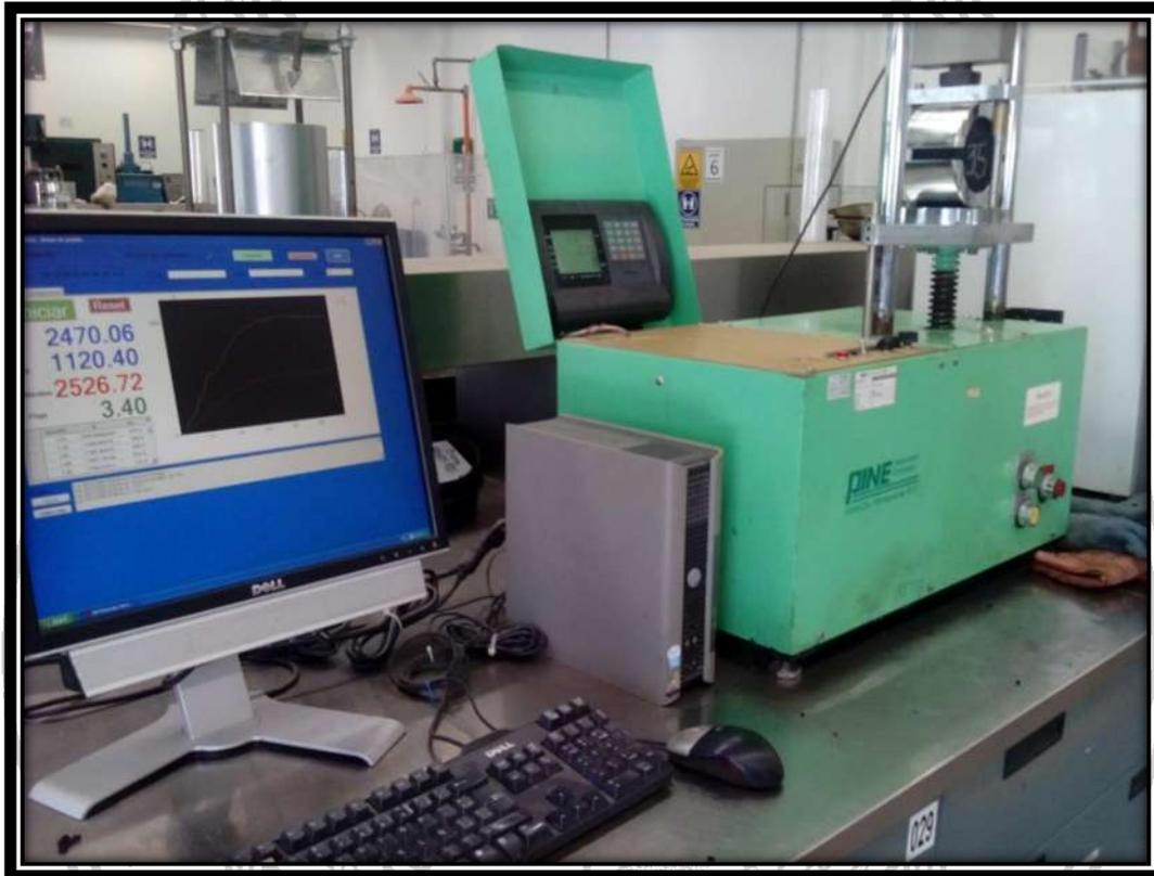
FIG. 4.23 Máquina automatizada Marshall.
