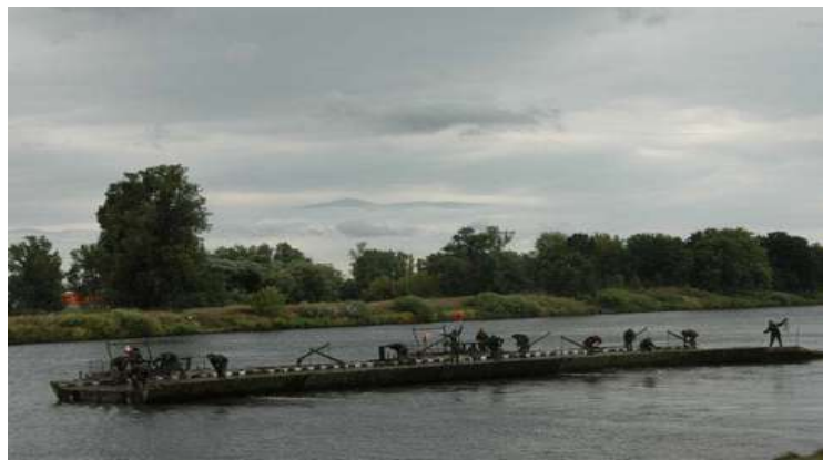
Ilustración 18 Plataforma Flotante Diseñada Para Un Máximo De 80 Toneladas De Peso, Transportada En Camiones Militares.
