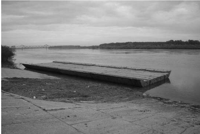
Ilustración 17 Plataforma Flotante Utilizada Para Librar Ríos Y Soportar Alta Cantidad De Peso.
