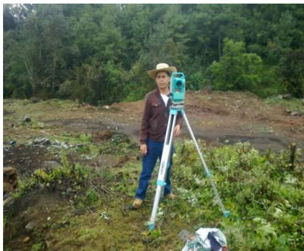
Levantamiento topográfico con Estación Total.
