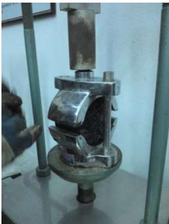
Fig.- 57.-Prueba de de la pastilla (Marshall).
