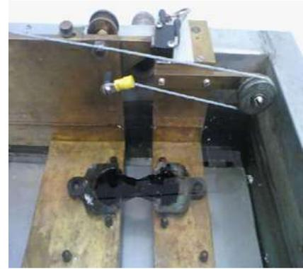
Fig.- 41.-Maquina de prueba de ductilidad.
