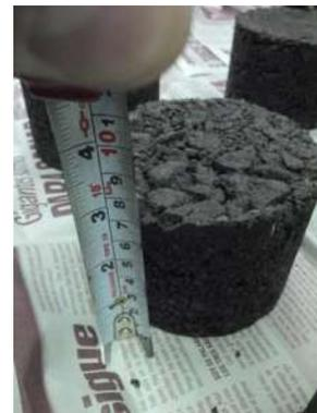
Fig.-74.-Altura de las pastillas.
