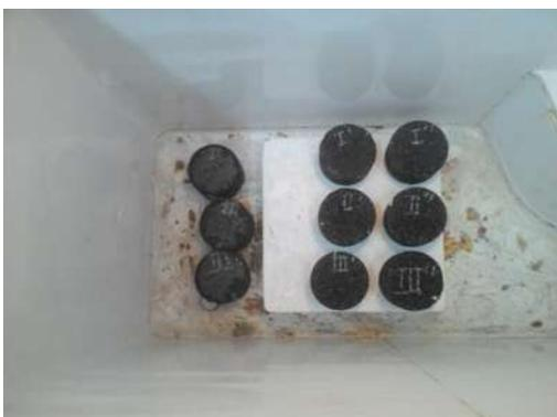
Fig.-71.-Cogelado de las pastillas a temperatura 0°C.
