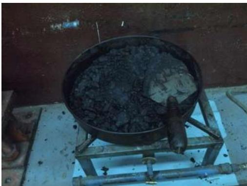
**Fig.-67.-**Mezclado del material pétreo y asfalto.
