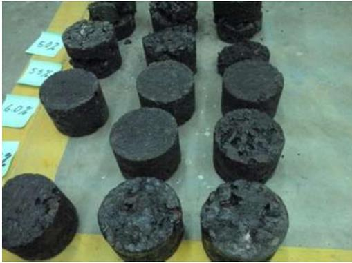
**Fig.- 59.-**Pastillas probadas en la prensa Marshall.
