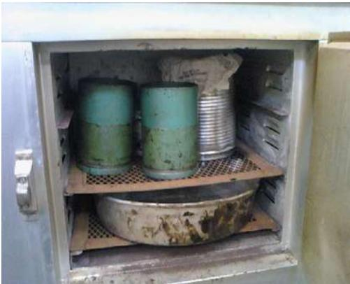
**Fig.-65.-**Calentamiento de moldes y material pétreo.
