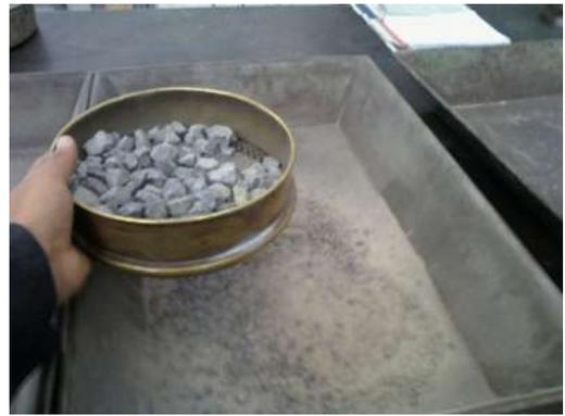
**Fig.- 7.-** Cribado de material.
