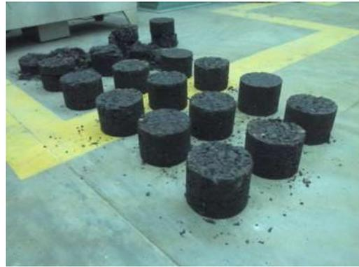
**Fig.- 48 y 49.-**Muestras o pastillas de mezcla asfáltica a diferentes % de cemento asfáltico.
