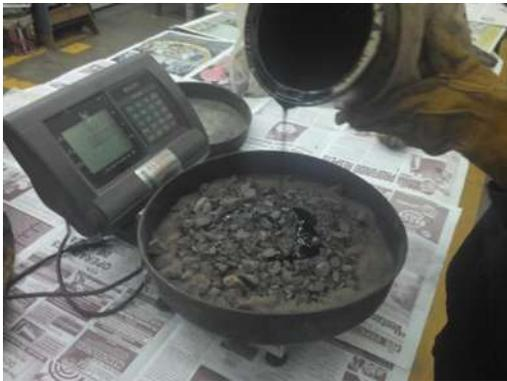
**Fig.- 44.-**Vertido de de cemento asfáltico.
