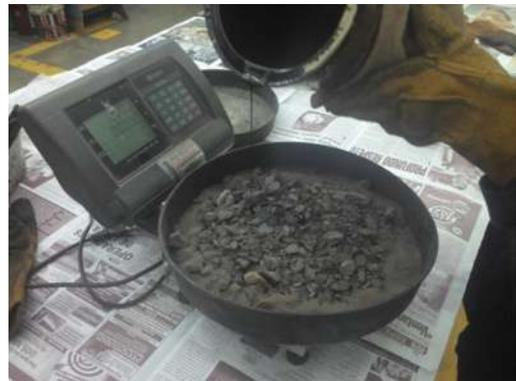
**Fig.-66.-**Vertido del % de contenido asfáltico (optimo).
