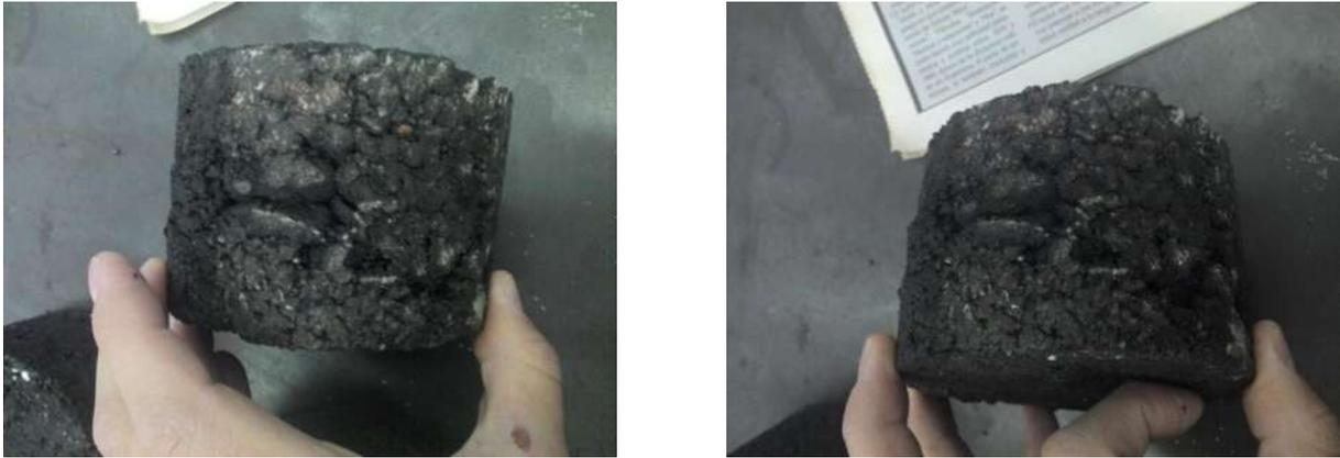
Fig.-81 y 82.-Practura o falla de las pastillas o espécimen.
