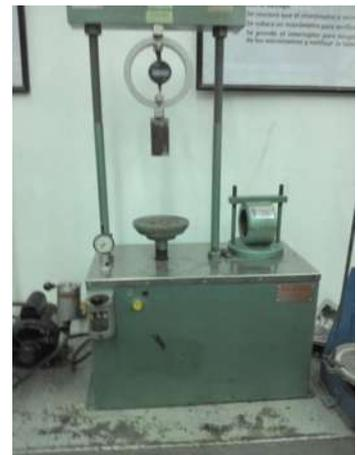
Fig.- 58.-Maquina de prueba Marshall.
