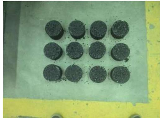
Fig.-70.-Enfriado de las pastillas a temperatura ambiente.
