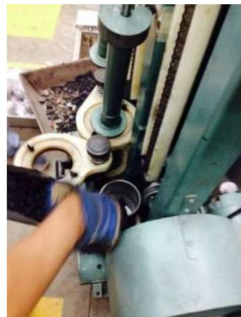
**Fig.-68.-**Vertido de la mezcla al molde para compactación.
