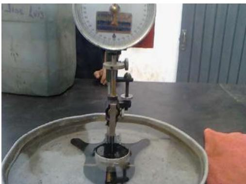
Fig.- 26.- Prueba de penetración.
