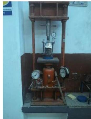
**Fig.-79 y 80.**-Prueba de las pastillas en la prensa.
