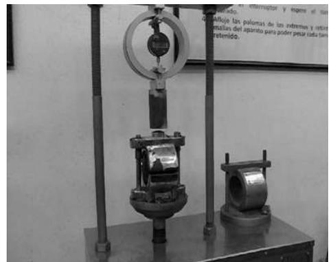
Fig.- 56.-Prueba de de la pastilla (Marshall).
