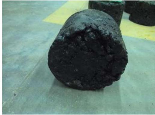
**Fig.-60.-**Deformación de las pastillas después de la prueba.
