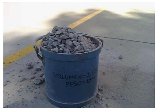
**Fig.- 3.-** Llenado de recipiente para la prueba.
