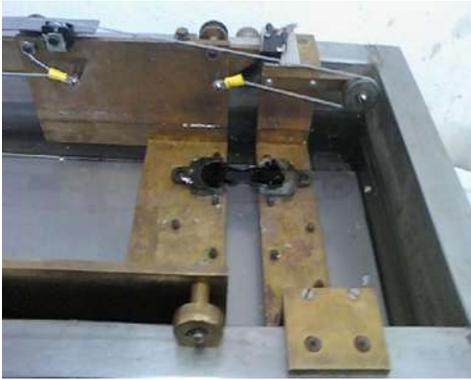
Fig.- 40.-Prueba de ductilidad con briquetas.
