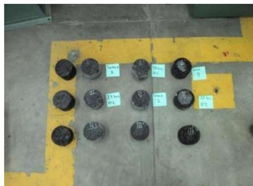
Fig.-72.-Pastillas separadas en series de 3.
