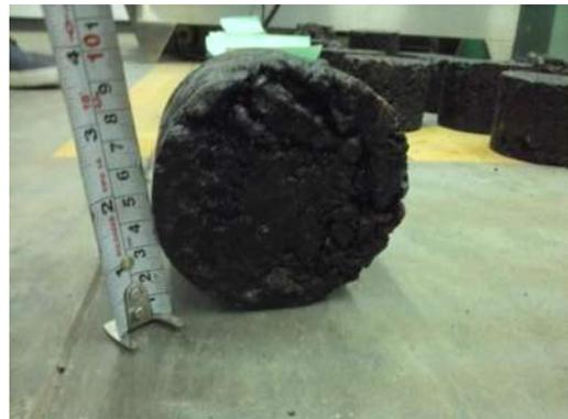
**Fig.-61 y 62.-**Deformación de las pastillas después de la prueba Marshall.
