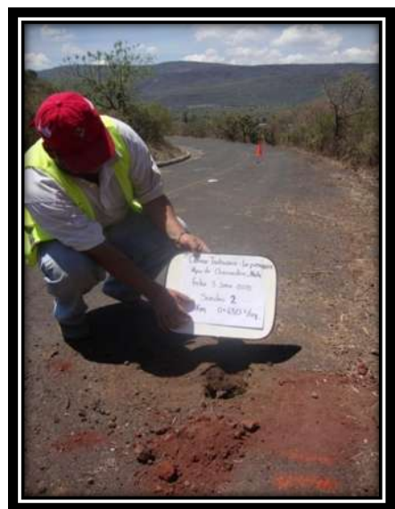
Foto. 16 Vista del sondeo 2 realizado con su respectiva identificación.
