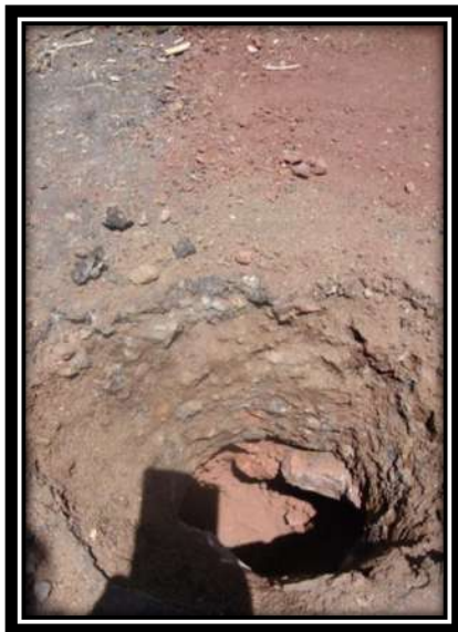
Foto. 15 Se observa el espesor y estratigrafía del sondeo realizado en el km 0+650.
