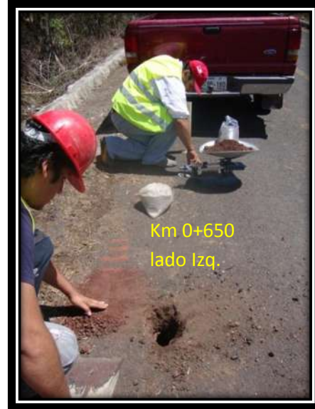
Foto. 14 Se determinó el grado de compactación en cada una de las capas encontradas.
