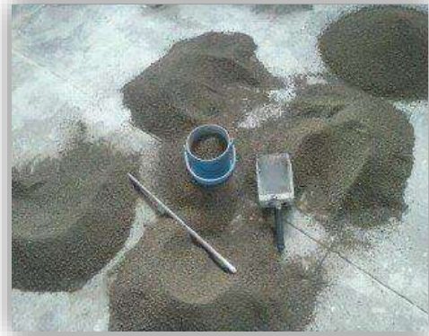
Ilustración 4-IV "M.V.S.V de la arena"
