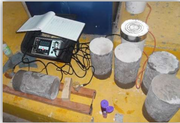
Ilustración 4-XVII"Prueba de velocidad de pulso"
