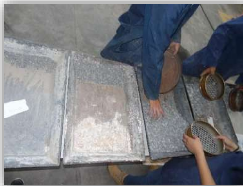
Ilustración 4-XII "Prueba de granulometría en arenas"
