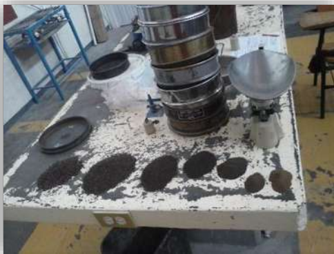
Ilustración 4-VI "Muestra de arena dividida por tamaños"
