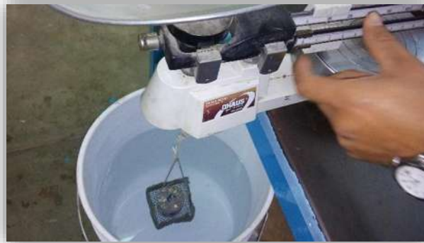
Ilustración 4-XVIII "Prueba de porosidad total"
