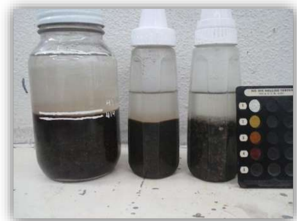
Ilustración 4-VII "Comparación colorimétrica de la arena"
