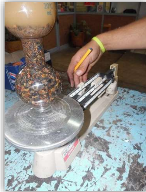
Ilustración 4-V "Prueba de densidad en arenas"
