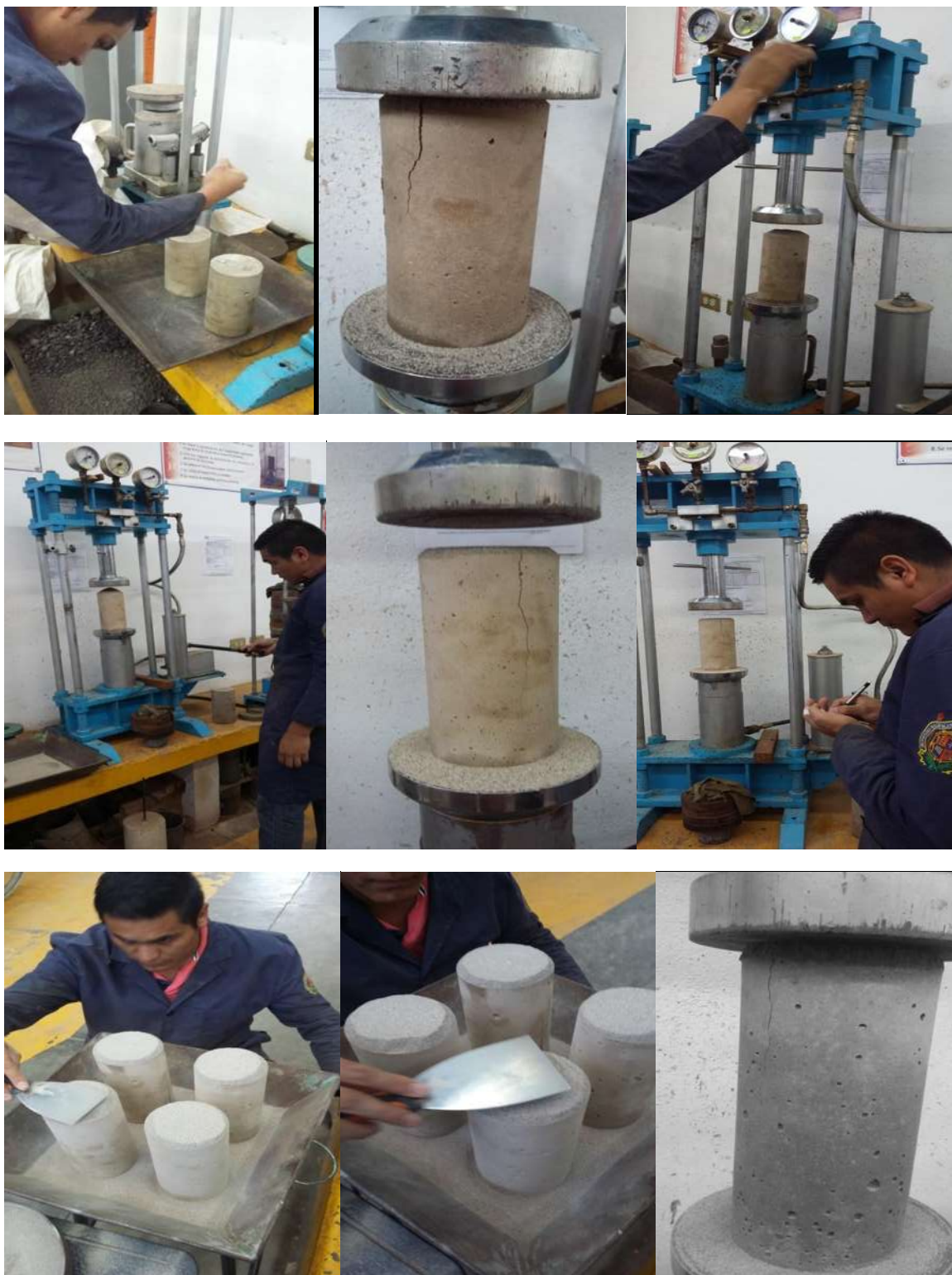
Reporte fotográfico de especímenes saturados y no saturados, probados a compresión simple a 3 y 7 días en la prensa de compresión hidráulica.
