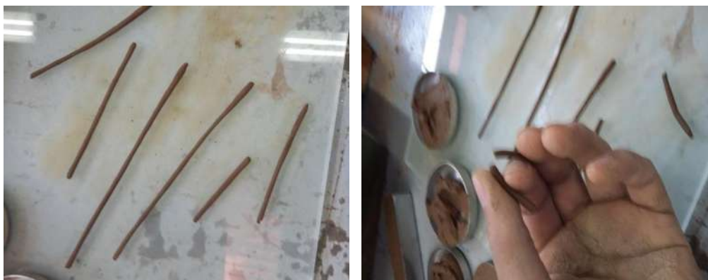
FIGURA 48: Formación y fragmentación de cilindros en su contenido óptimo de humedad.
