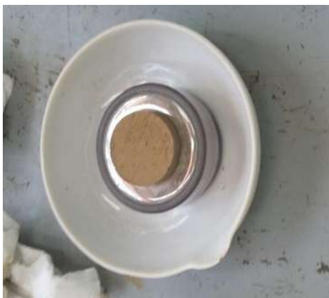
FIGURA 52: Colocación de la pastilla de material seco para obtener su volumen.
