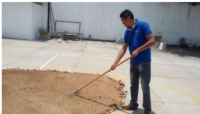
FIGURA 31: Proceso de secado al sol del material en estudio.
