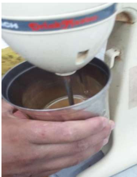
FIGURA 69: Colocación de la suspensión en el mezclador mecánico.
