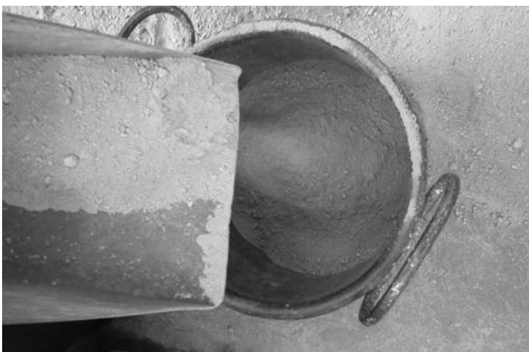
FIGURA 96: Se muestra la forma de llenar el recipiente.
