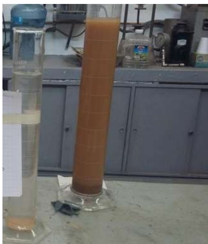
Figura 75: Probeta de 500 cm 3 con agua limpia para lavar el hidrómetro después de cada lectura de la suspensión.
