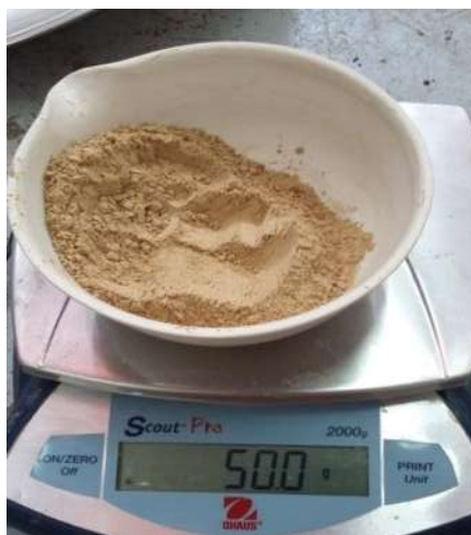
FIGURA 64: 50 gr de material cribado por la malla N° 200.
