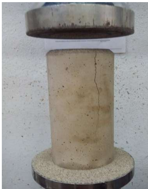
Figura 129: Muestra la falla del cilindro por carga a compresión simple.
