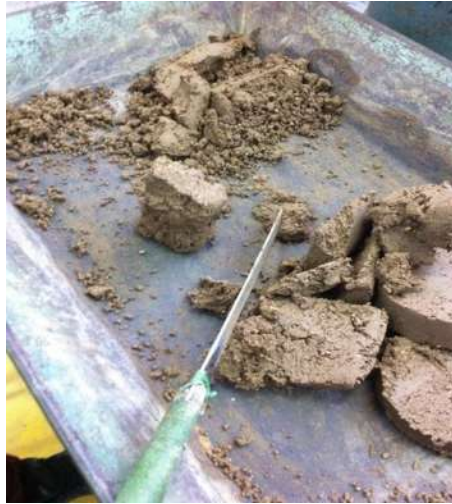
FIGURA 82: Obtención de la porción de material para determinar su contenido de agua.
