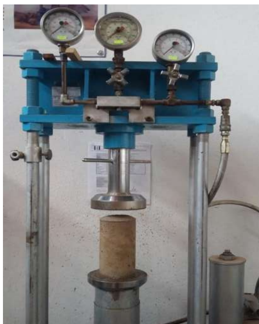
FIGURA 128: Especimen colocado en la prensa para ser probado.
