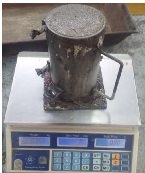
FIGURA 117: Peso del espécimen fresco.
