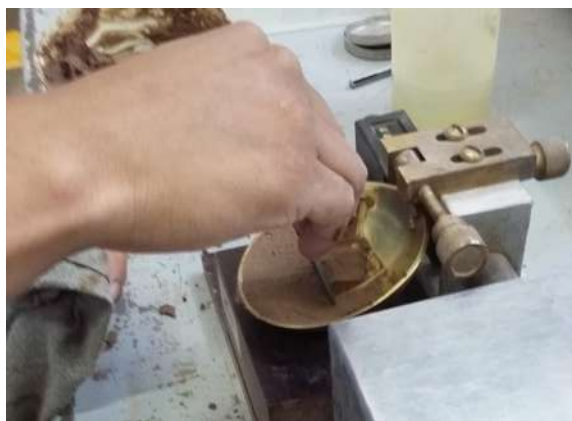
FIGURA 46: Forma de ranurar la muestra.
