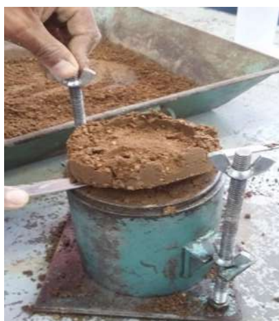
FIGURA 79: Muestra la forma de enrasar el espécimen.
