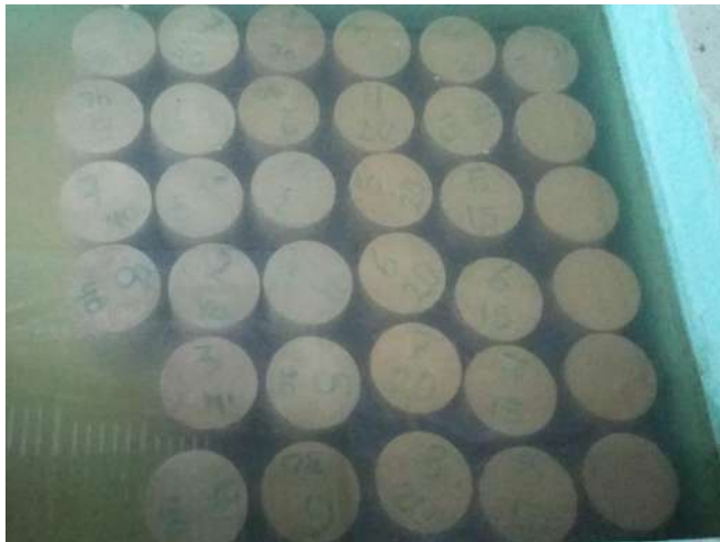
FIGURA 121: Especímenes curados en pila de saturación, hasta la edad de prueba.
