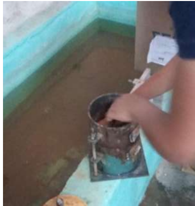
FIGURA 88: Colocación del papel filtro sobre el espécimen.
