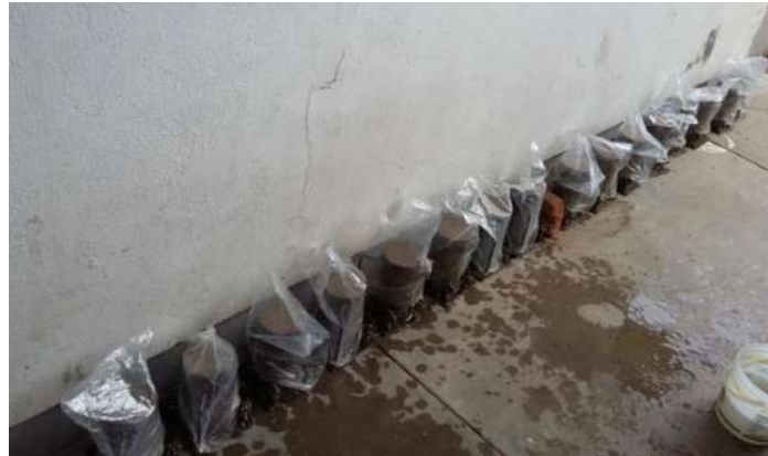
FIGURA 118: Especímenes curados con bolsas húmedas durante 24 horas.
