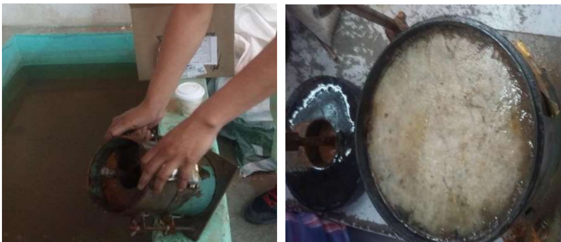
FIGURA 91: Muestra la forma de escurrir el espécimen y el retiro de las placas.
