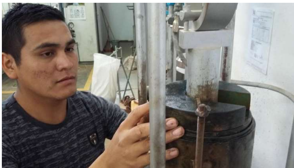
FIGURA 92: Colocación del molde en la prensa.
