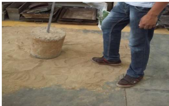
FIGURA 32: Disgregación y pulverización del material (tepetate).
