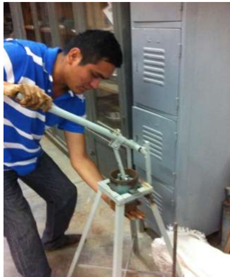
FIGURA 81: Forma de sacar el espécimen del molde.
