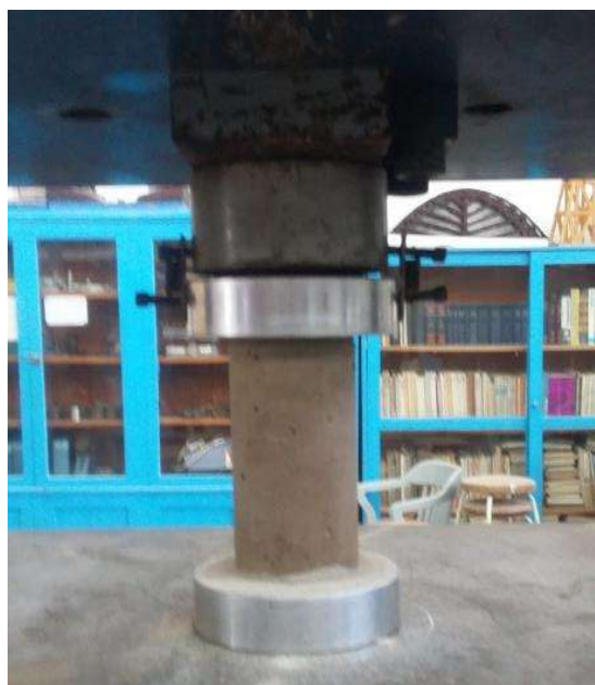
FIGURA 131: Muestra la colocación del espécimen en la maquina universal Forney.
