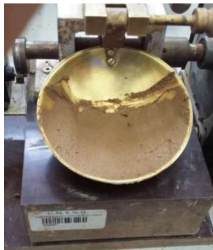
FIGURA 45: Material extendido en la copa Casagrande.
