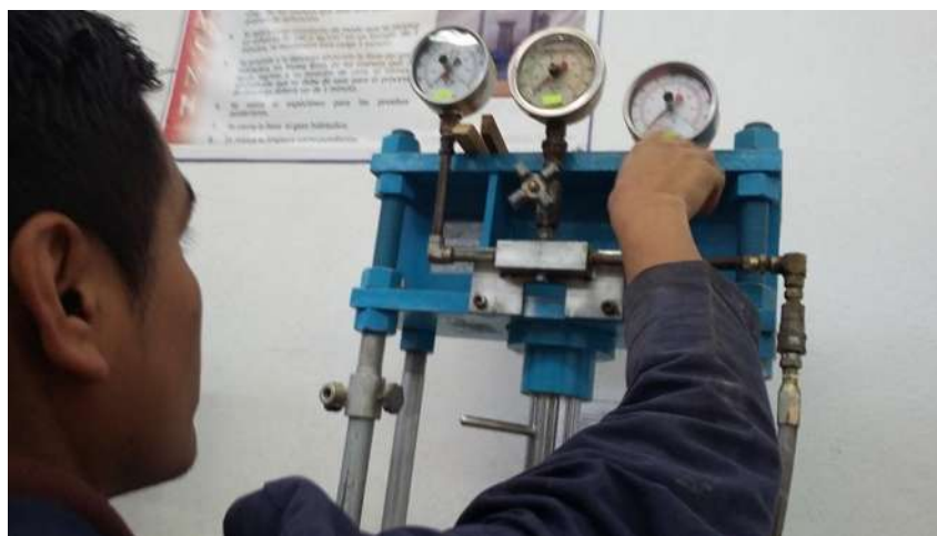
FIGURA 130: Muestra la forma de tomar la lectura de la carga.
