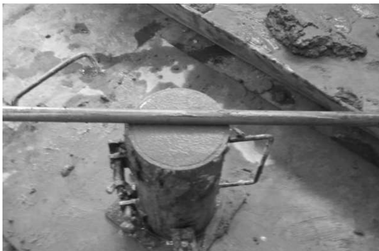
FIGURA 116: Enrase del espécimen con la varilla metálica.
