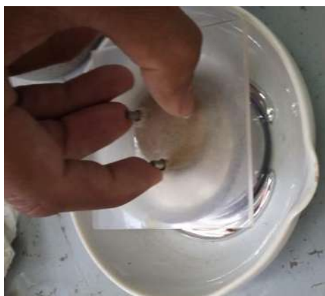
FIGURA 53: Sumergir la pastilla con la placa de vidrio.
