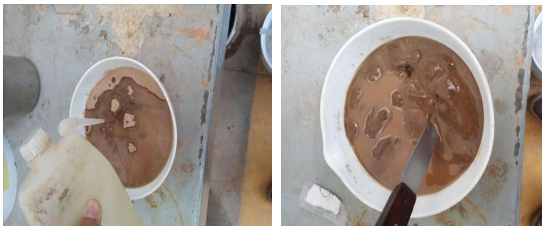
FIGURA 43: Saturación y reposo del material.
