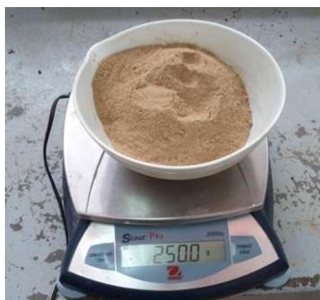
FIGURA 42: Material cribado por la malla N°40.
