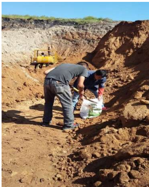
FIGURA 30: Segundo muestreo de material (tepetate) en el Banco Torreón Nuevo.
