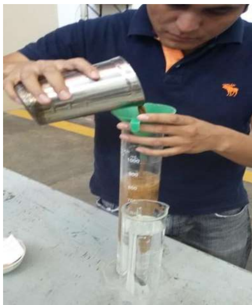
FIGURA 71: Agregación de la suspensión en la probeta Bouyoucos.
