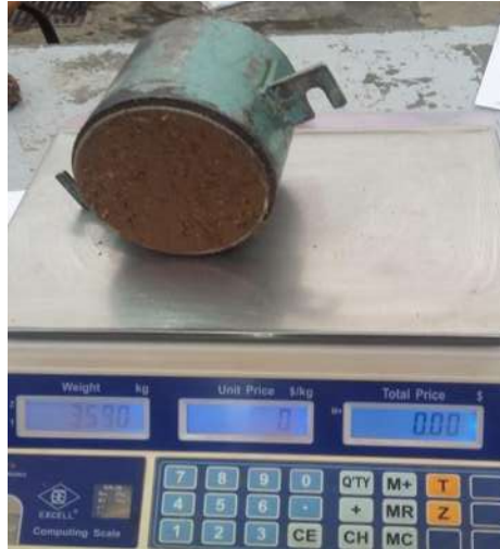
FIGURA 80: Peso del molde más el material compactado.
