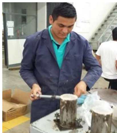
FIGURA 119: Forma de descimbrar los especímenes.
