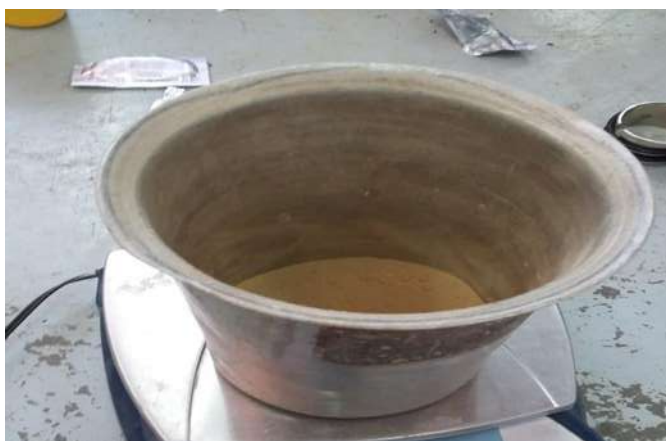
FIGURA 35: 300 gr de material para ser secado.
