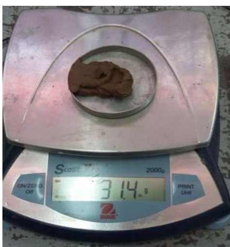
FIGURA 47: Porción de material para obtener el contenido de agua.
