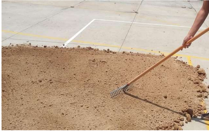
FIGURA 12: Inspección del suelo (tepetate), para elaboración de suelo-cemento fluido.
