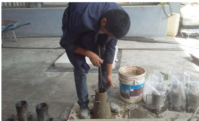
FIGURA 110: Varillado de la capa de mezcla en forma de espiral.
