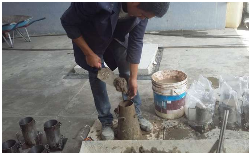
FIGURA 109: Llenado del cono para determinar el revenimiento.
