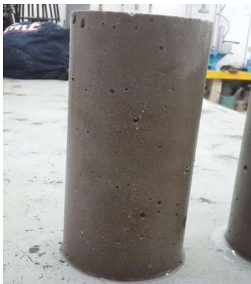
FIGURA 124: Espécimen saturado, secado superficialmente listo para ser cabeceado y probado.
