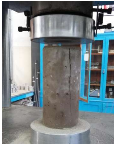
FIGURA 133: Muestra la falla del espécimen por compresión simple.
