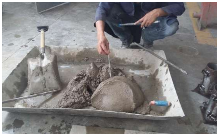
FIGURA 108: Colocación del termómetro para tomar la temperatura de la mezcla.
