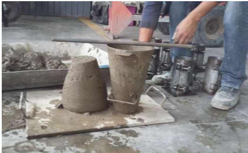
FIGURA 112: Desmolde de la mezcla, para medir el revenimiento.
