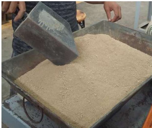
FIGURA 100: Tepetate para elaboración de la mezcla.
