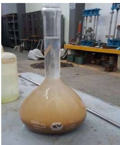
FIGURA 60: Llenado del matraz con agua destilada hasta la marca de aforo.
