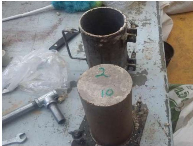
FIGURA 120: Espécimen descimbrado y numerado.
