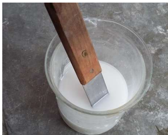
FIGURA 104: Dilución del aditivo Maxe y puesto en reposo.
