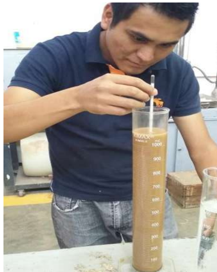
FIGURA 73: Colocación del hidrómetro y toma de lecturas.
