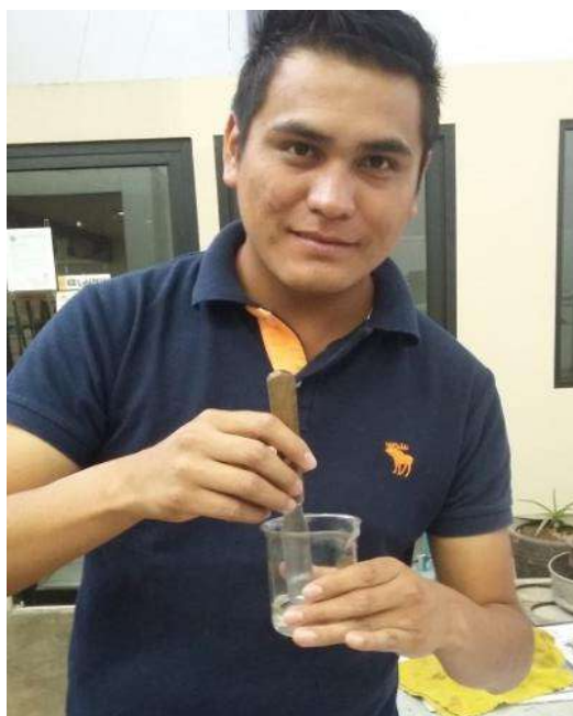
FIGURA 66: Dilución del defloculante 50gr de agua.
