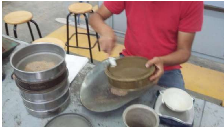
FIGURA 40: Limpieza de la malla.
