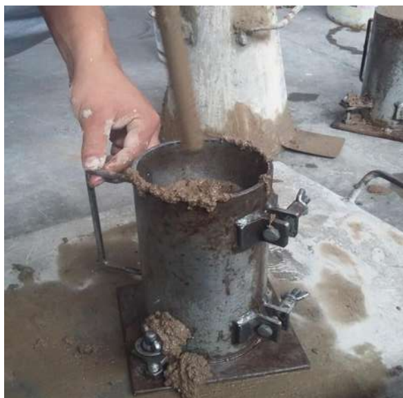
FIGURA 114: Llenado y varillado del espécimen.
