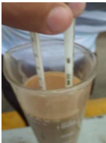
FIGURA 74: Colocación del termómetro para toma de temperatura de la suspensión.
