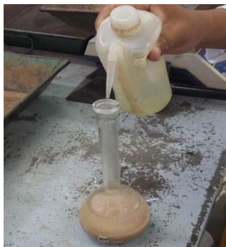
FIGURA 57: Vertido del material y agua en el matraz.
