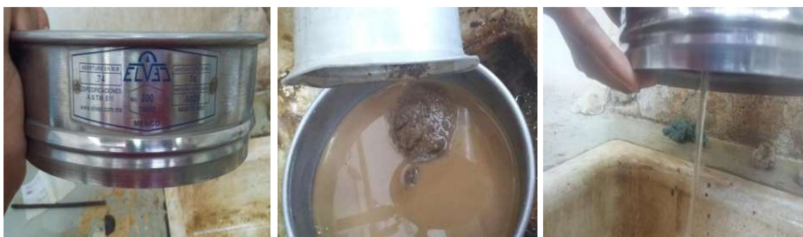
FIGURA 37: Lavado del material por la malla N°200.
