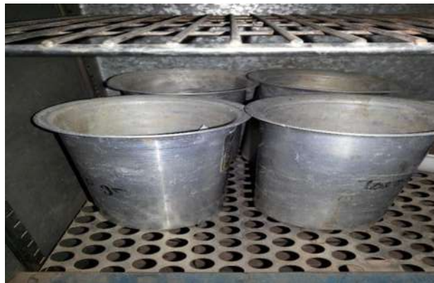
FIGURA 83: Se realiza el secado de las porciones de material en horno durante 24 horas.
