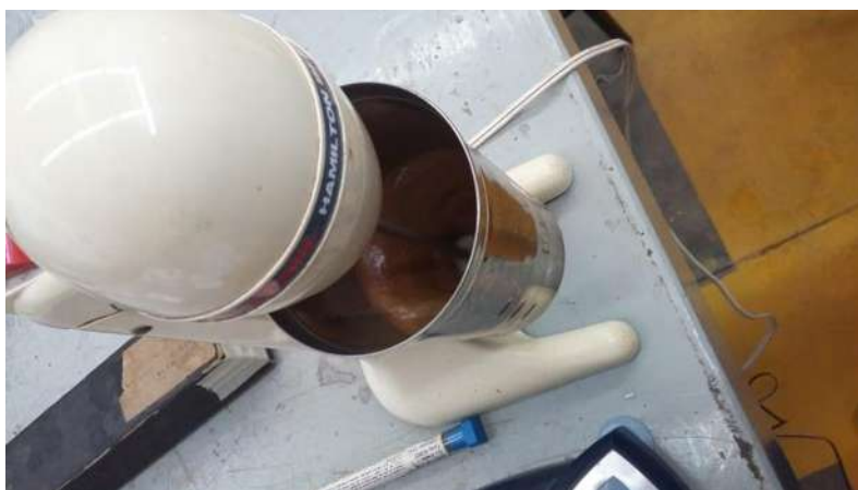
FIGURA 70: Mezclar por un tiempo mínimo de 15 minutos.
