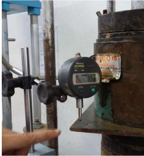
FIGURA 93: Forma de colocación del extensómetro.
