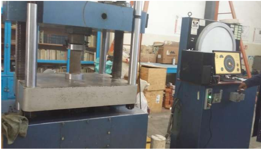
FIGURA 132: Aplicación de la carga de compresión simple con la maquina universal Forney.
