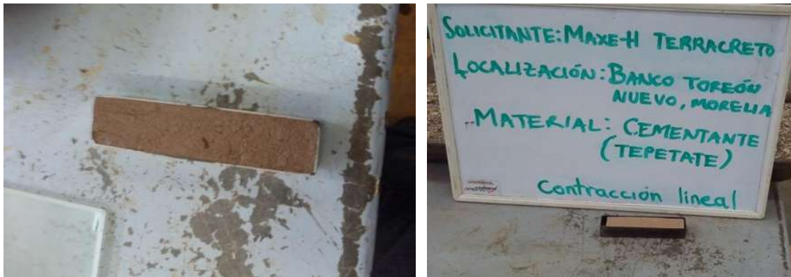
FIGURA 50: Muestra las longitudes inicial y final de la barra.
