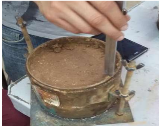
FIGURA 87: Forma de medir la altura entre la cara superior del espécimen y el borde superior del molde.
