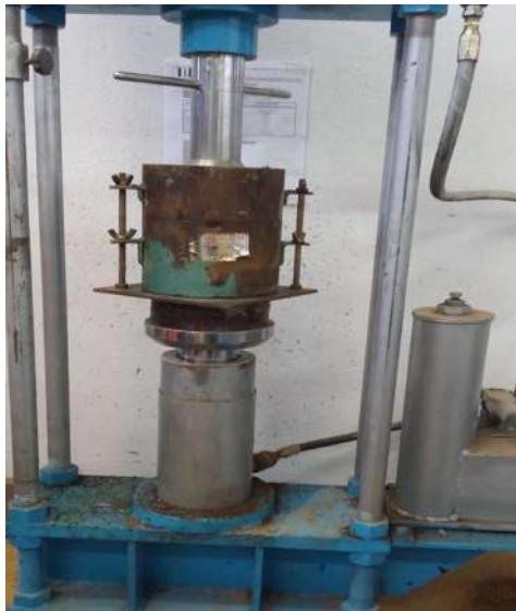
FIGURA 85: Colocación del molde en la prensa, para aplicación de la carga.
