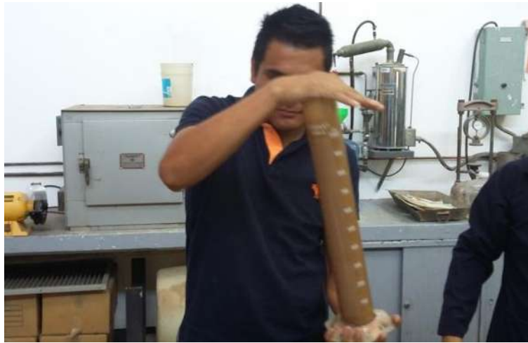
FIGURA 72: Forma de agitar la probeta.
