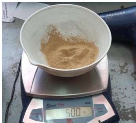
FIGURA 56: Material cribado por la malla N°40.
