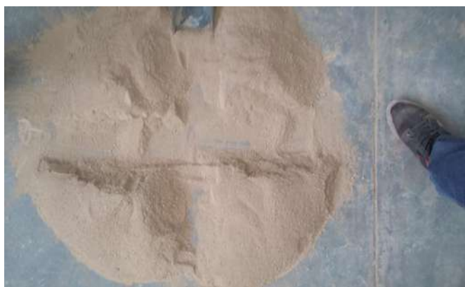
FIGURA 33: Cuarteo del material (tepetate).
