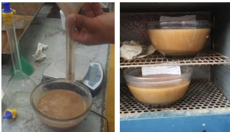
FIGURA 63: Vertido del material en la cápsula y puesto en horno para su secado hasta masa constante.
