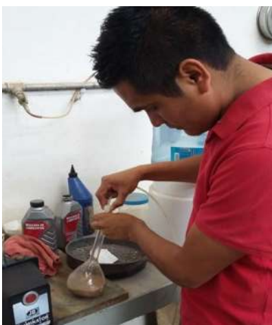
FIGURA 59: Forma de aplicar succión con la bomba de vacío.
