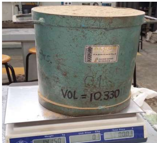
FIGURA 98: Pesado del material.
