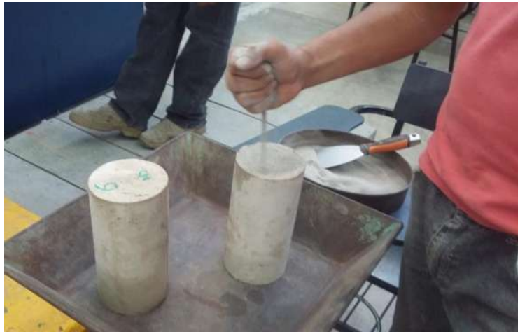
FIGURA 125: Especímenes no saturados, listos para cabecear y ser probados.
