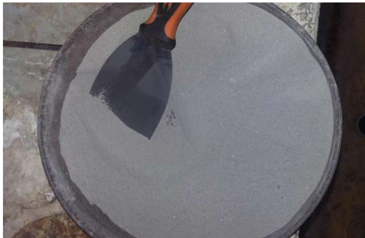
FIGURA 126: Mezcla de arena y cemento, para cabecear los especímenes.
