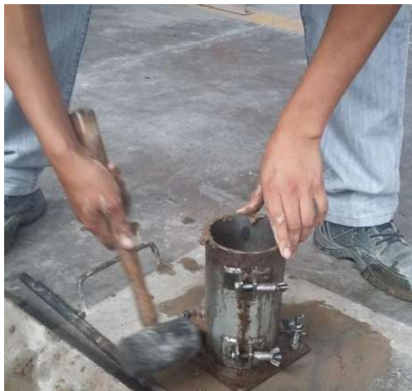
FIGURA 115: Uso del martillo de hule para expulsar el aire contenido en la mezcla.
