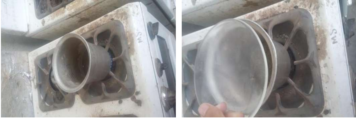
FIGURA 38: Secado del material retenido en la malla N° 200.
