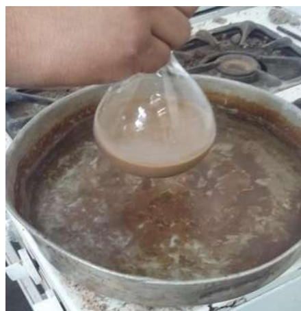
FIGURA 58: Expulsión del aire atrapado en el matraz mediante ebullición del agua.
