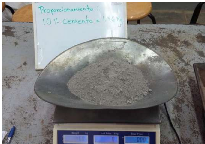
FIGURA 102: Cemento pesado para los porcentajes propuestos.
