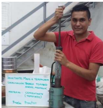
FIGURA 78: Muestra la compactación de una de la capas.
