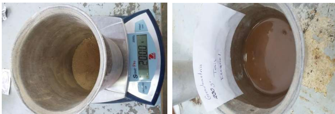
FIGURA 36: Pesado y saturación del material.
