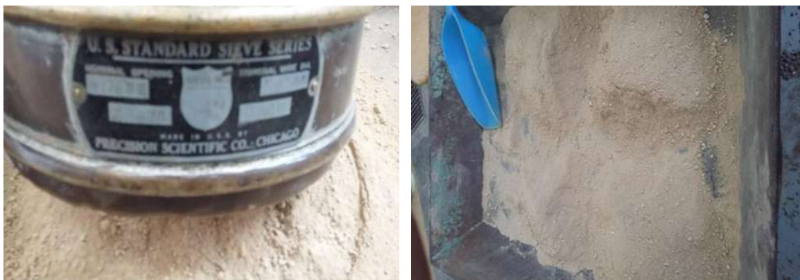
FIGURA 34: Cribado del material por la malla N°4.
