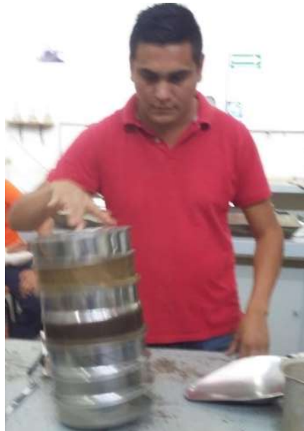
FIGURA 39: Colocación y cribado manual del material.
