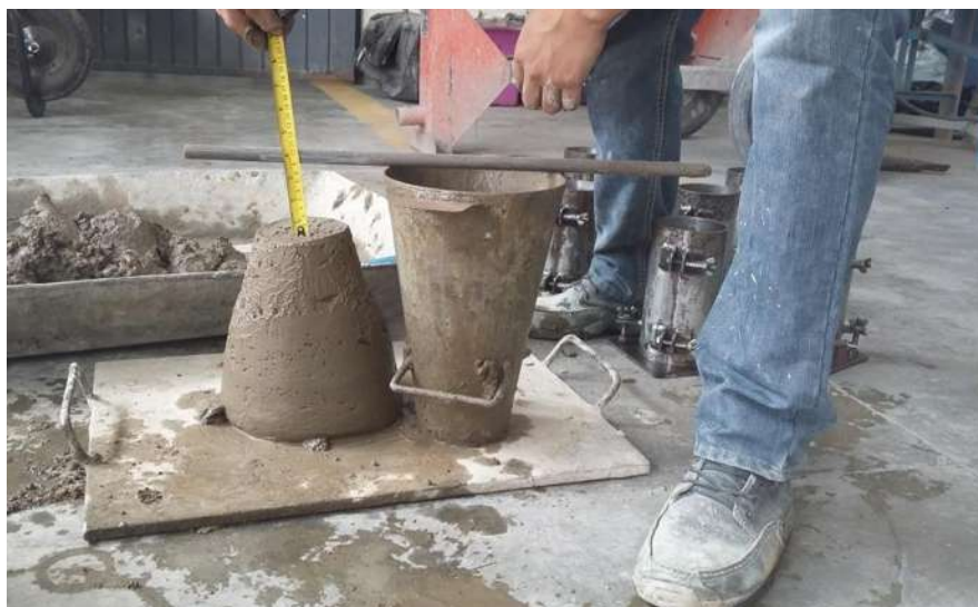
FIGURA 113: Forma de medir el revenimiento de la mezcla.
