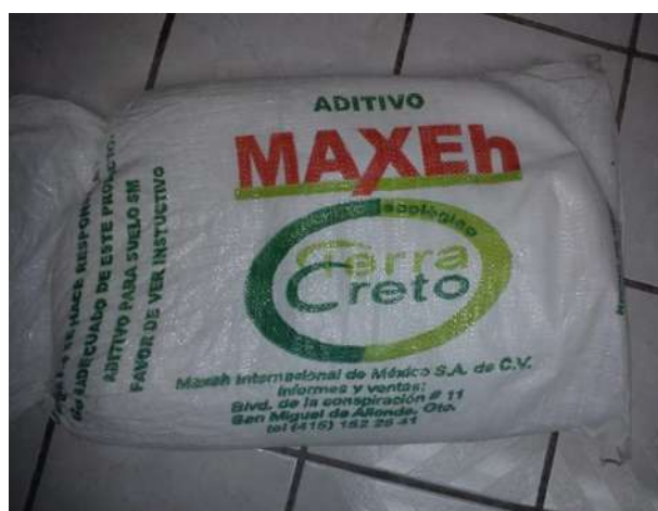
FIGURA 5: Aditivo Maxe-h empleado en la mezcla de suelo-cemento fluido.
