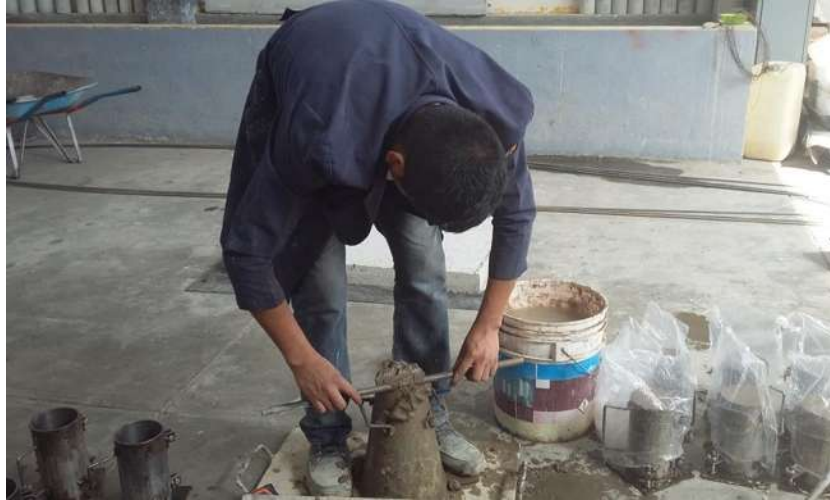
FIGURA 111: Forma de enrasar el cono de revenimiento.
