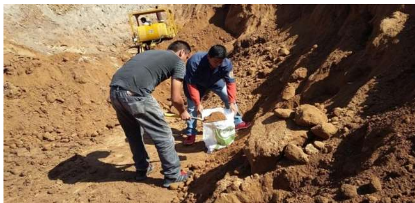
FIGURA 29: Primer muestreo de material (tepetate) en el Banco Torreón Nuevo.
