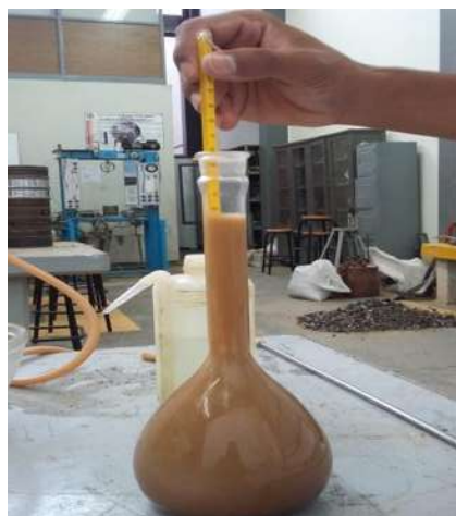
FIGURA 62: Forma de obtener la temperatura de la prueba.
