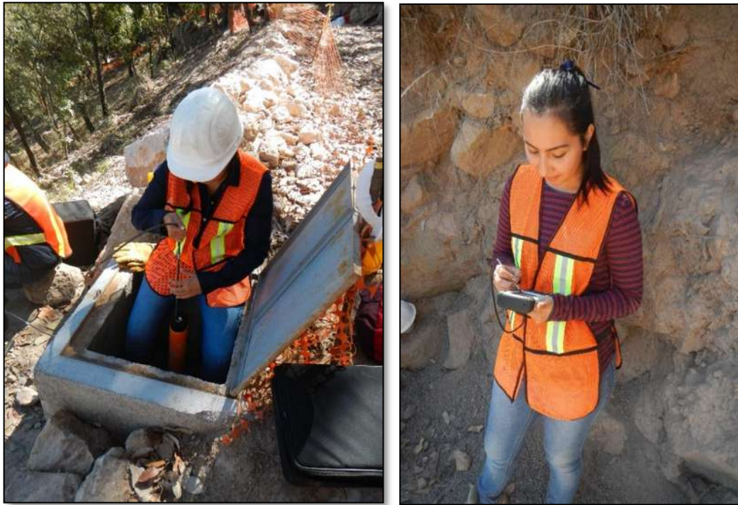
FIGURA 12. Toma de lecturas con inclinómetro.
