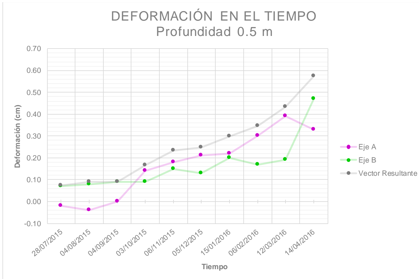
FIGURA 22. Vectores de deformación. Inclínómetro 1 Túnel II.
