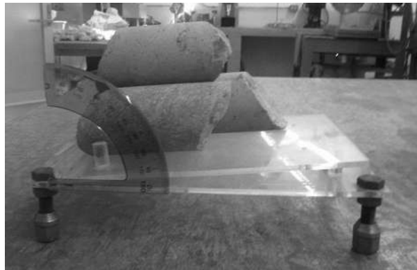
Figura 3.18 Ensayo del ángulo de rozamiento, aplicado a especímenes cilíndricos.
