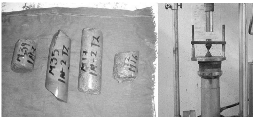
Figura 4.40 Especímenes por ensayar y equipo para la carga puntual.
