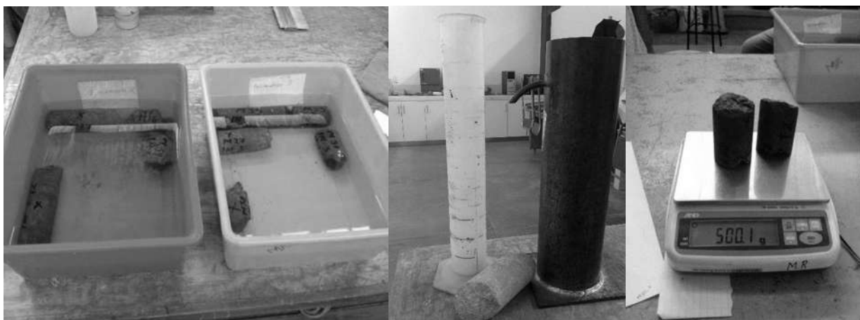
Figura 4.32 Secuencia fotográfica de izquierda a derecha, saturación de los especímenes, probeta, picnómetro y peso final de la muestra.
