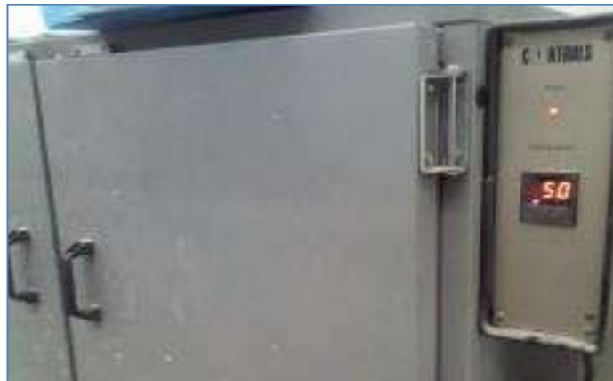
Figura 41 Horno para secar probetas con funcionamiento a los 50°C.
