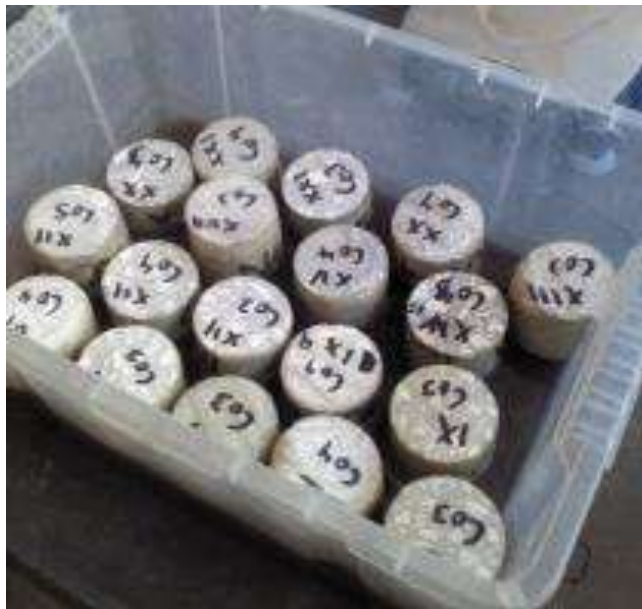
Figura 55 Especímenes durante la prueba de Fagerlund.
