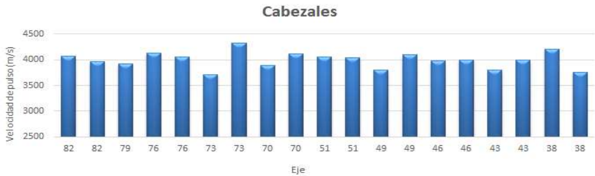
Figura 67. Gráfica de barras de resultados promedio de prueba VPU para corazones extraídos de cabezales.
