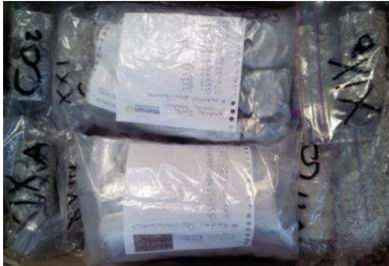
Figura 51 Testigos ensayados sin material de cabeceo empacados para enviar a IMT con anotaciones dentro de las bolsas.
