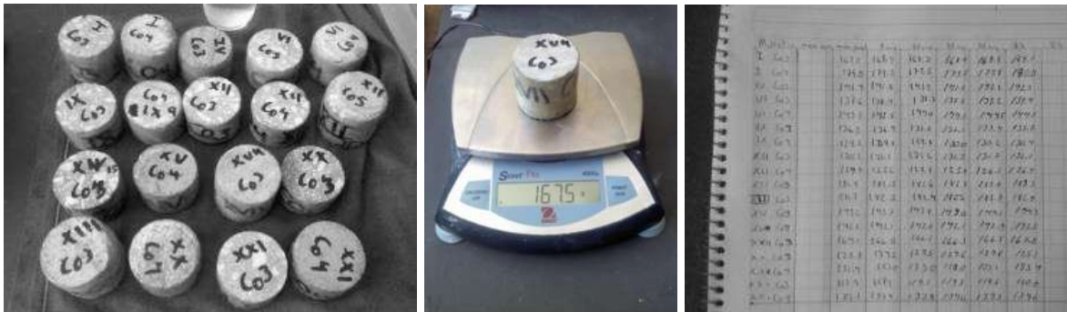
Figura 57 Especímenes siendo secados superficialmente para pasar a pesaje y posteriormente a registro de datos.
