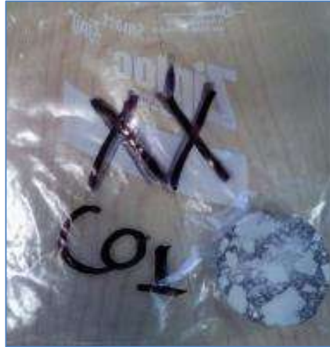
Figura 38 Remanente de cilindro empaquetado para enviar a probar químicamente al IMT.
