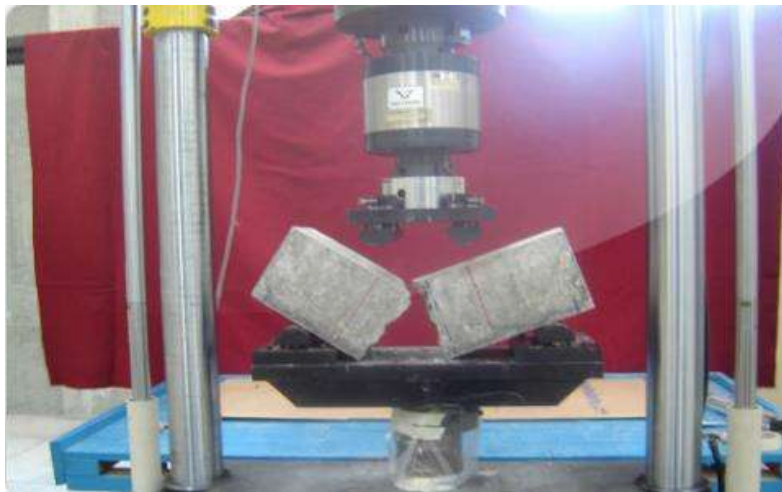
Figura 4 Máquina Universal Instron del Instituto Mexicano del Transporte. Imagen tomada de la página del IMT donde se muestran instalaciones y equipos. (IMT, Página Oficial del Instituto Mexicano del Transporte, 2013)
