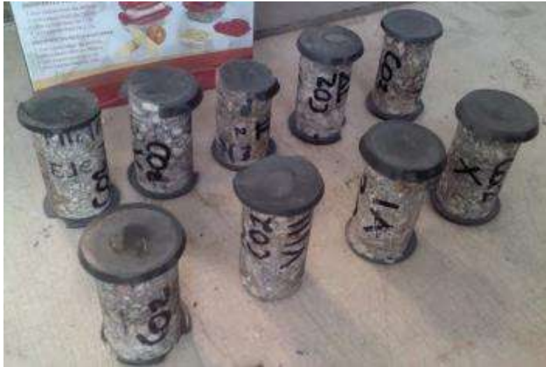
Figura 49 Imagen de especímenes que ya han sido probados por compresión en la máquina Universal.
