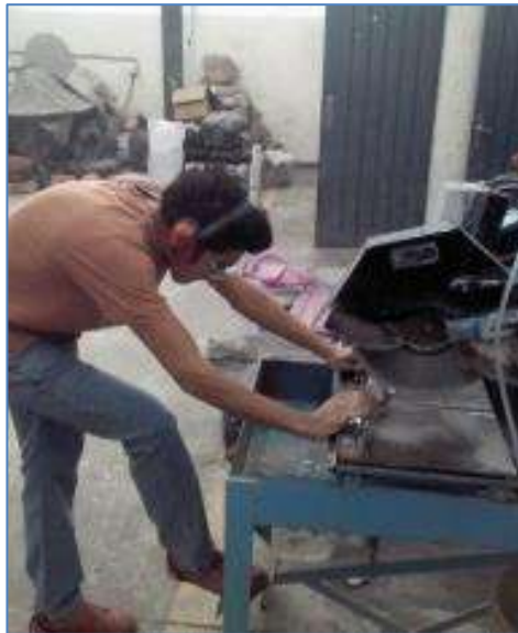
Figura 37. Manipulación de máquina cortadora de concreto usada con probetas recibidas e imagen de remanente de cilindro producto de corte empaquetado para enviar a probar químicamente al IMT.
