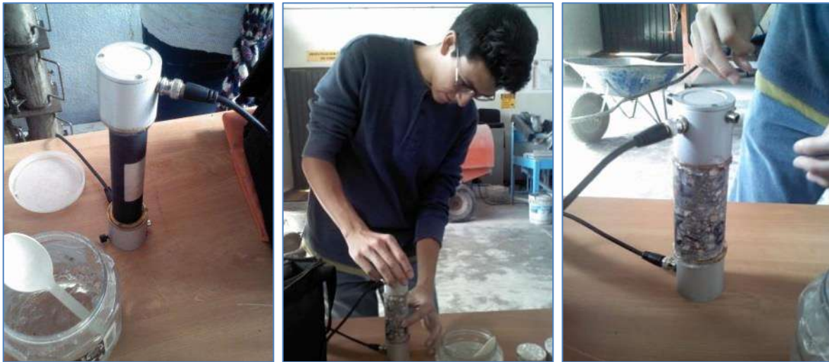
Figura 45 Colocación y acoplamiento de especímenes para realizar ensayos de Velocidad de Pulso Ultrasónico.
