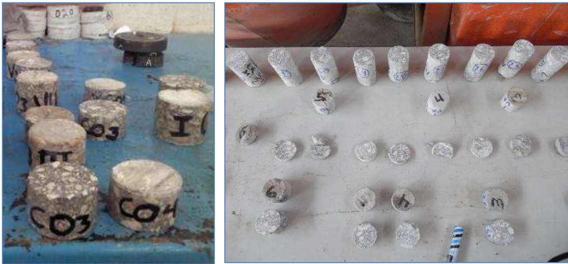
Figura 40 Rodajas de testigos provenientes de corte de dos entregas, destinadas para pruebas de tipo Co3, Co4 y Co5.
