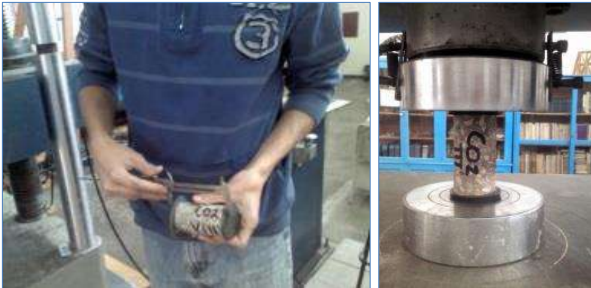
Figura 47 Medición de longitud de especímenes con material de cabeceo para registro en las tablas y probeta colocada en placa de máquina lista para prueba de compresión simple
