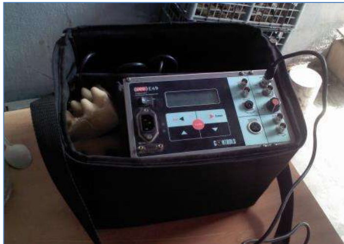
Figura 44 Aparato para medición de Velocidad de Pulso Ultrasónico en especímenes.
