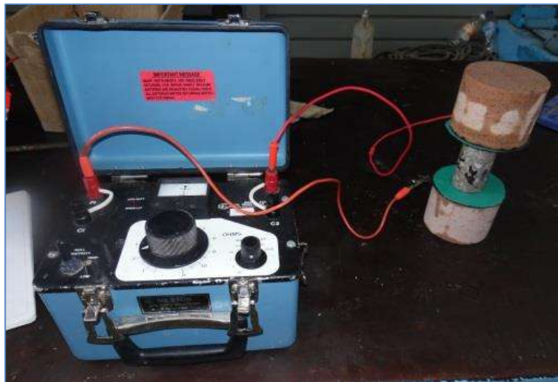
Figura 43 Máquina destinada a ensayo de resistividad eléctrica utilizada para el concreto a caracterizar.
