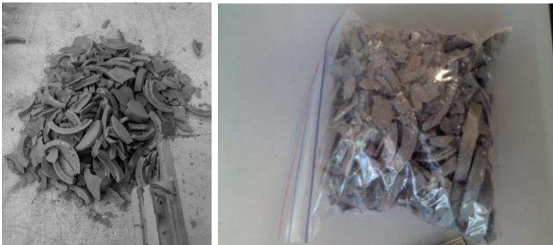
Figura 52 Material de reciclaje para cabeceo de cilindros de concreto.
