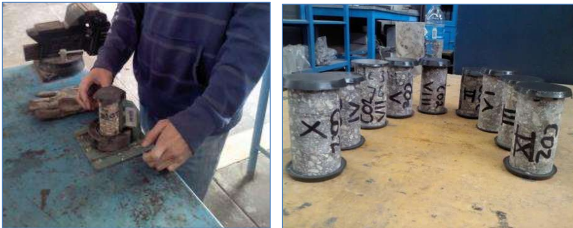
Figura 46 Colocación de material de cabeceo para pruebas de compresión simple y especímenes ya listos para ensayar.
