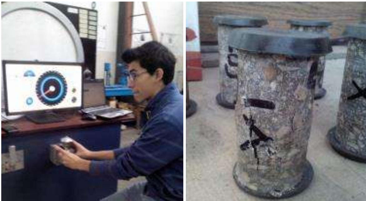
Figura 48 Manipulación de controles de máquina universal durante prueba de compresión simple y espécimen tronado.
