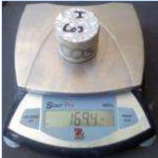
Figura 42 Pesaje de especímenes para registro en tablas.
