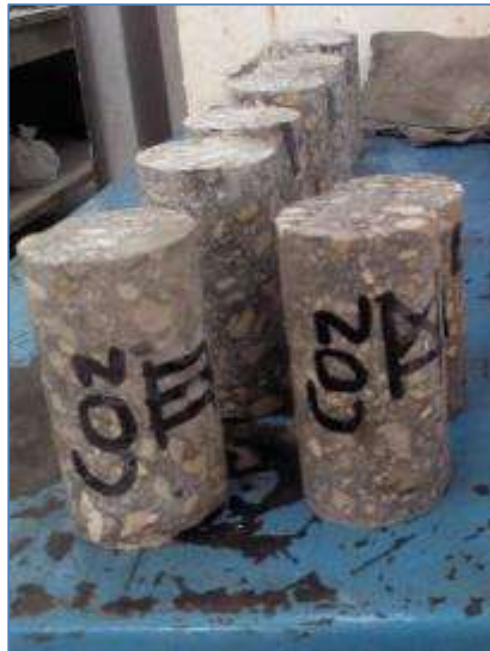
Figura 39 Testigos cortados, partes destinadas para pruebas tipo Co2.
