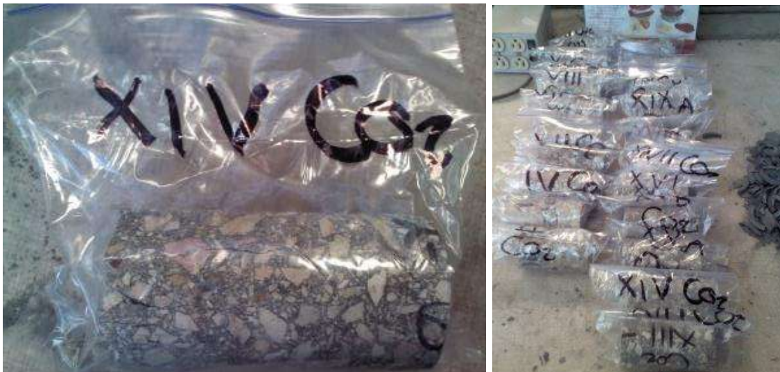
Figura 50 Testigos ensayados sin material de cabeceo empacados para enviar a IMT.
