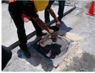
Figura 15 Suministro, prueba in situ de trabajabilidad y colocación de tubo Tremie para verter el concreto de pilas.
