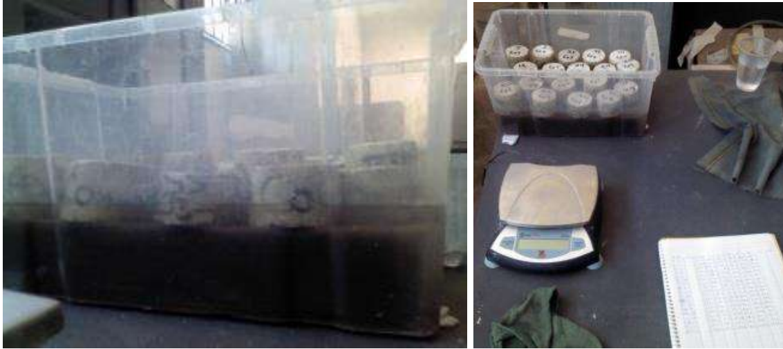
Figura 56 Testigos en proceso de aplicación de la prueba de Fagerlund.
