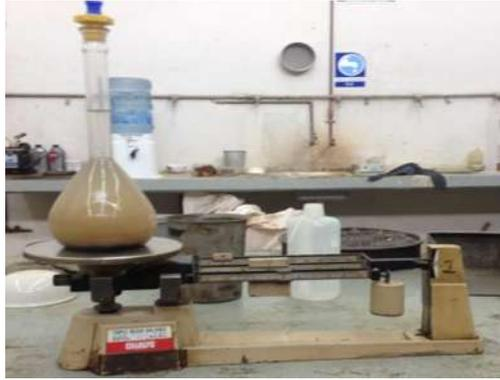
Fig. 2.8.8.- Muestra el matraz después de llenarlo y su pesado.
