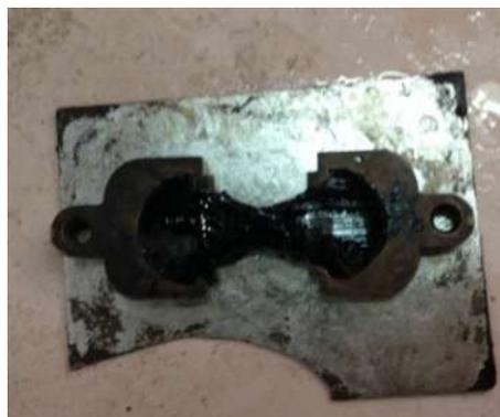
Fig. 3.8.3.- Briqueta de cemento asfáltico.
