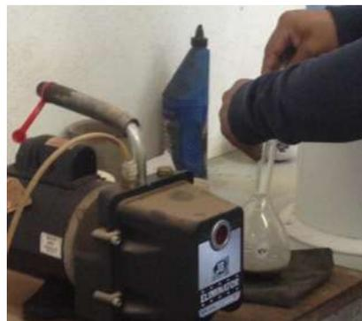
Fig. 2.8.7.- Muestra cómo se aplica la succión.
