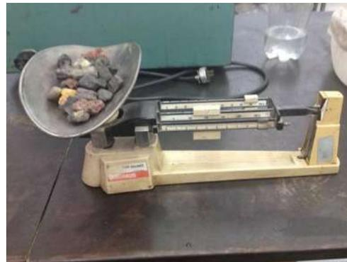
**Fig. 2.8.4.-** Peso material Volcánico Seco
