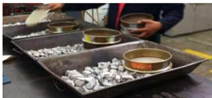
Fig. 2.7.1.- Cribado de material
