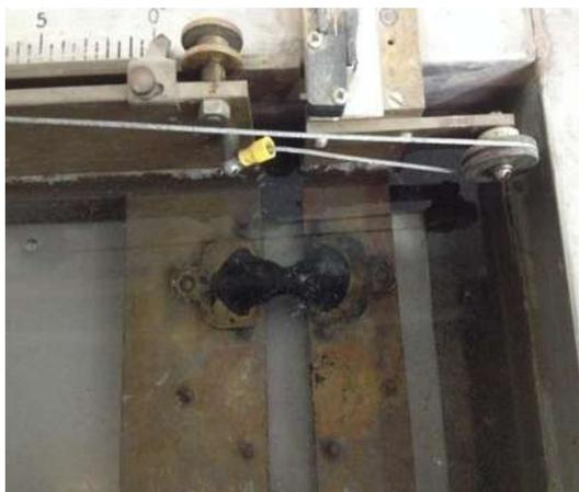
**Fig. 3.8.4.-** Ductilómetro e inicio de estirar briqueta.
