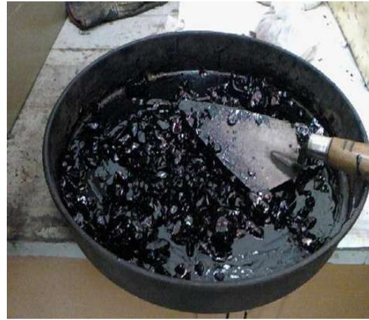
Fig.- 4.2.8. Mezclado del material C.A.
