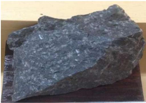
**Fig. 2.5.1.-** Roca ígnea intrusiva: ANDESITA PORFÍDICA
