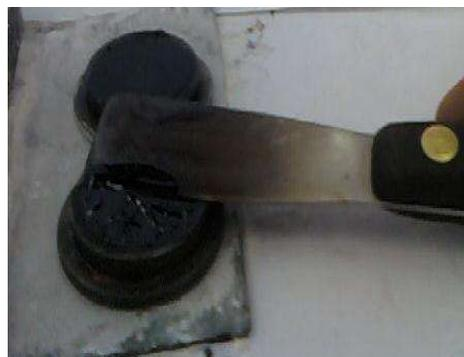
Fig. 3.7.2.- Enrasado de cemento en anillo.
