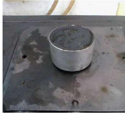
**Fig. 3.5.6.-** Capsula con el cemento asfáltico.
