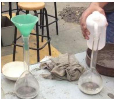
Fig. 2.8.5.- Muestra cómo se introduce el material y agua destilada
