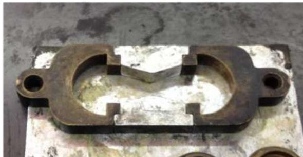
Fig. 3.8.1.- Molde de latón para elaborar las briquetas, compuesto de (2) dos mordazas y (2) dos elementos laterales.
