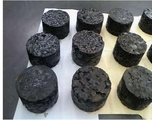
Fig.-4.2.12. Pastillas de diferente % C.A.
