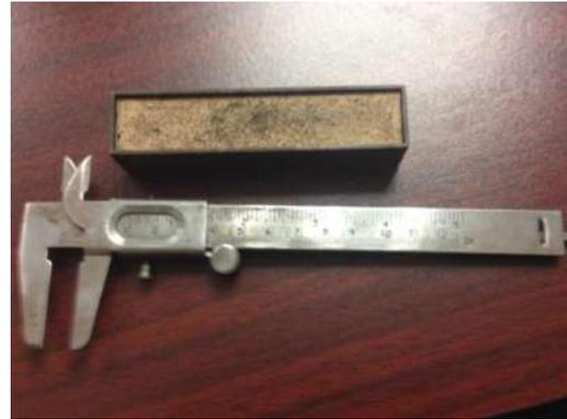
**Fig. 2.8.11.-** Muestra el molde enrazado.
