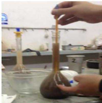
Fig. 2.8.9.- Muestra la forma de colocar el termómetro.
