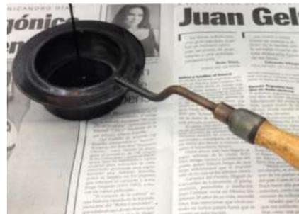
**Fig. 3.6.4.-** Copa con cemento asfáltico
