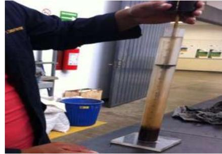
**Fig. 2.9.4.-** Cilindro y Pisón para la prueba
