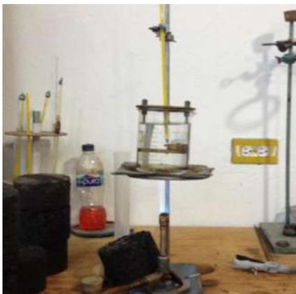
Fig. 3.7.5.- Aparato de anillo y bola, esfera, termómetro
