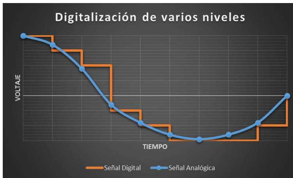
Figura III.20 "Digitalización de señal analógica a varios niveles digitales"
