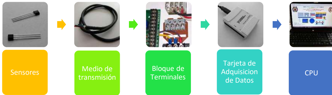
Figura II.6 "Componentes del Hardware de la instrumentación virtual"
