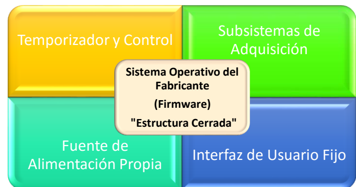
Figura II.4 "Estructura de un instrumento tradicional"
