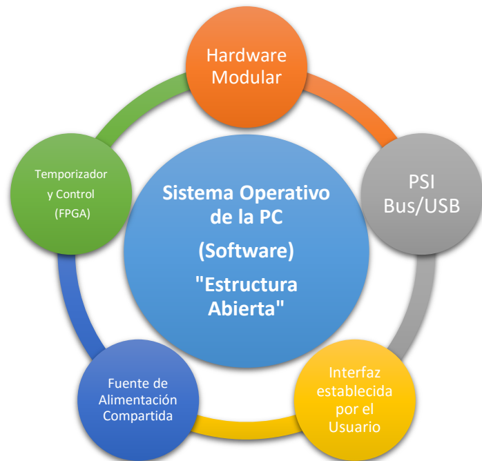
Figura II.5 "Estructura de un Instrumento Virtual" [19]
