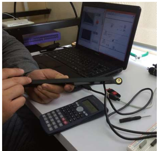
Figura IV.2 "Proceso de calibración de Sensor de desplazamiento lineal"
