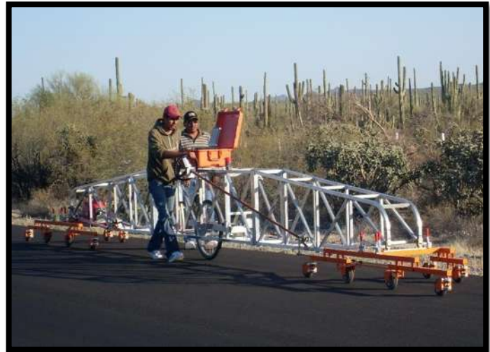
Figura I.16 "Perfilógrafo tipo California" Imagen obtenida de http://constructoracien.com
