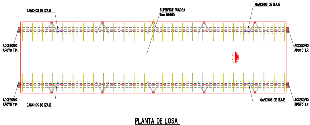
Imagen V.21. Planta de losa TT
