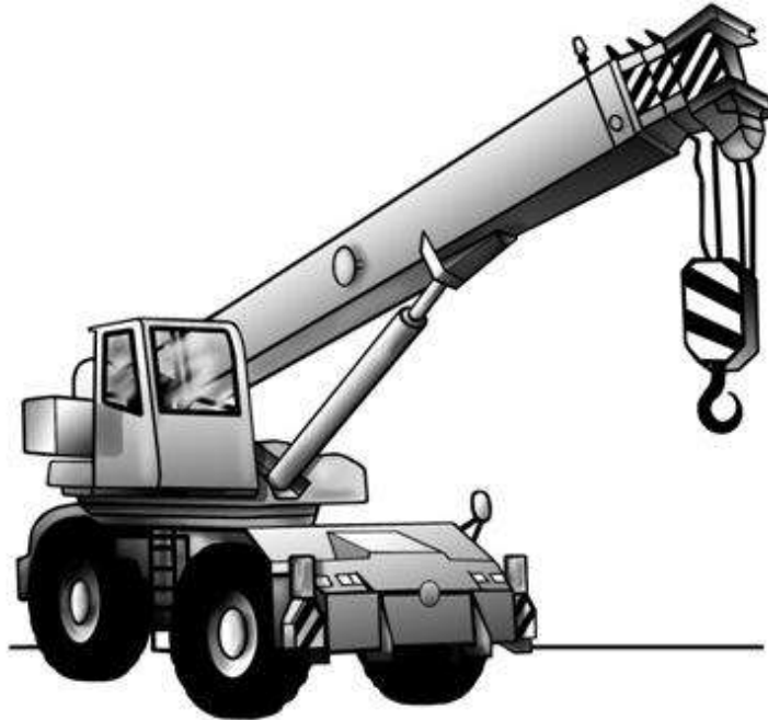
Imagen II.9. Grúa sobre neumáticos
