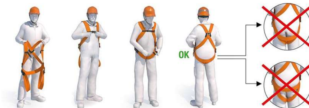
Imagen IV.18. Colocación de arnés anti-caídas
