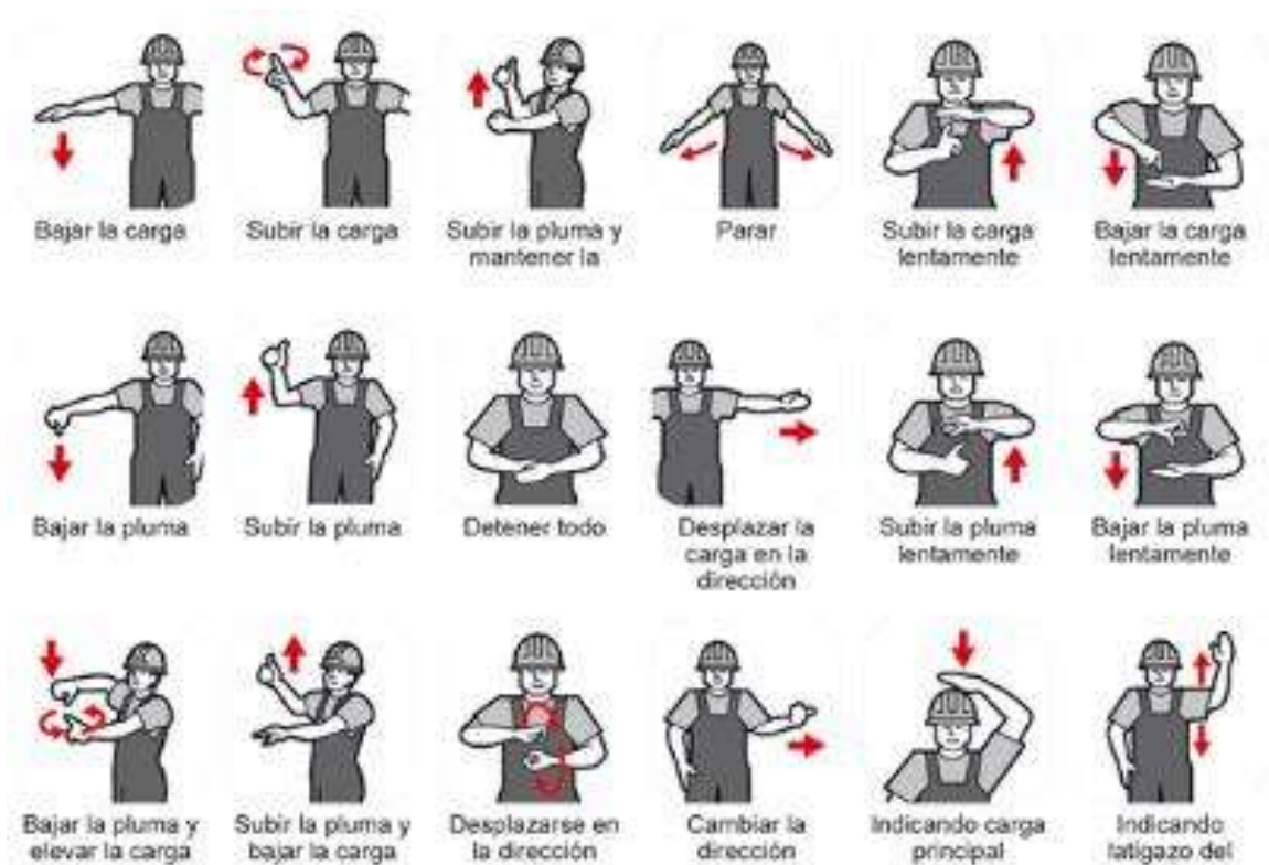
Imagen V.2. Principales señalizaciones de montador
