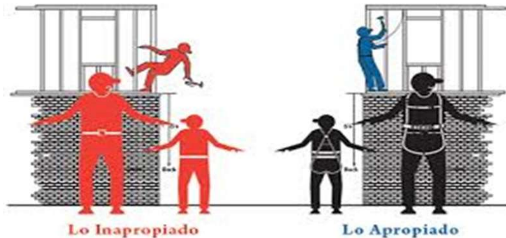
Imagen IV.5. Caídas a distinto nivel, izquierda inapropiada, derecha apropiada
