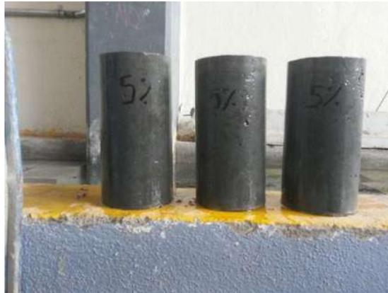
Figura 64. Cilindros de la mezcla CPC-5%CBC. (Fotografía: E. González Castro).
