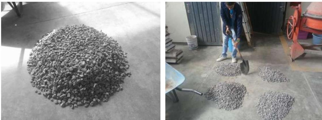
*Figura 34. Agregado grueso triturado apilado en forma cónica sobre una superficie dura y limpia (izquierda). Mezcla dividida en 4 partes iguales (derecha). (Fotografías: E. González Castro).*
