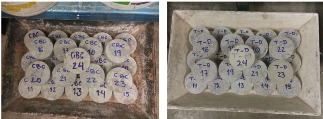
Figura 101. Rodajas obtenidas de cilindros. A la izquierda rodajas de la mezcla CPC-10%CBC, y a la derecha rodajas de la mezcla testigo. (Fotografías: E. González Castro).
