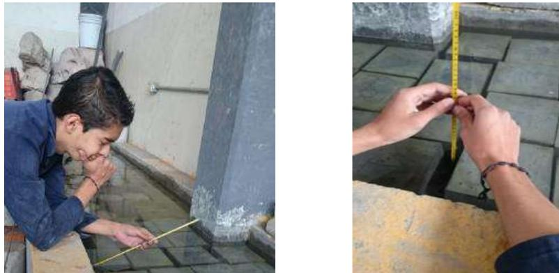
Figura 74. Medición de la temperatura del agua de la pila de curado. (Fotografías: E. González Castro).
