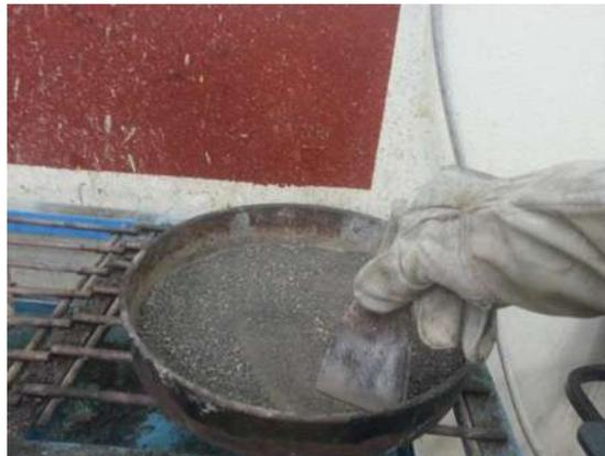
Figura 35. Secado de la muestra representativa (arena volcánica). (Fotografía: E. González Castro).
