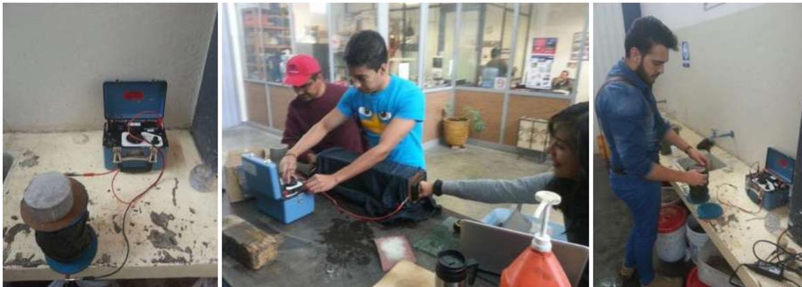
Figura 95. Medición de la resistividad en cilindros y prismas (Fotografías: E. Glez. Castro).
