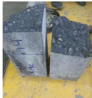
Figura 89. Estructura interna de vigas de CPC-10%CBC. (Fotografías: E. González Castro).
