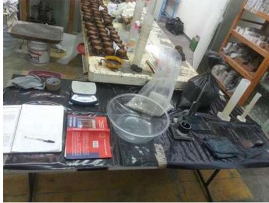
Figura 58. Material necesario para el ensaye de Consistencia Normal de la mezcla CPC-CBC. (Fotografía: E. González Castro).
