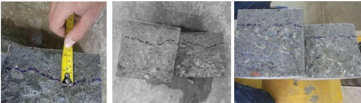
Figura 111. Segregación de agregados gruesos en vigas testigo. (Fotografías: E. González Castro).
