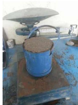
Figura 36. Comparación de los recipientes utilizados para los ensayos de masa unitaria en grava arena, respectivamente. (Fotografías: E. González Castro).
