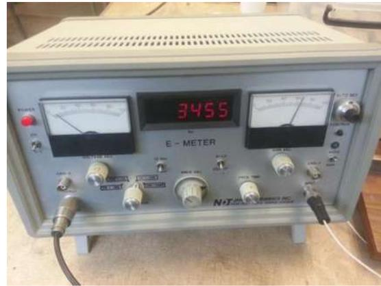
Figura 92. Vibración del espécimen y registro de la frecuencia más alta. (Fotografías: E. González Castro).
