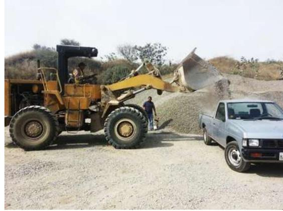
Figura 32. Muestreo del agregado grueso en el banco de material triturado. (Fotografías: E. González Castro).
