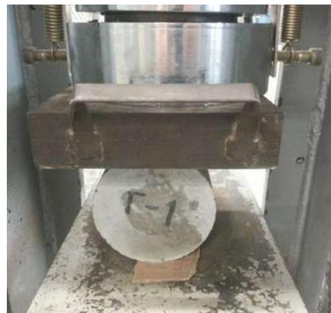
Figura 85. Cilindro Testigo fallado a la edad de 14 días (izquierda). Cilindro Testigo a tensión indirecta a la edad de 90 días (derecha). (Fotografías: E. González Castro).
