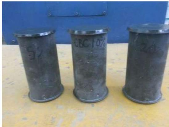
*Figura 67. Cilindros cabeceados con azufre. (Fotografía: E. González Castro).*
