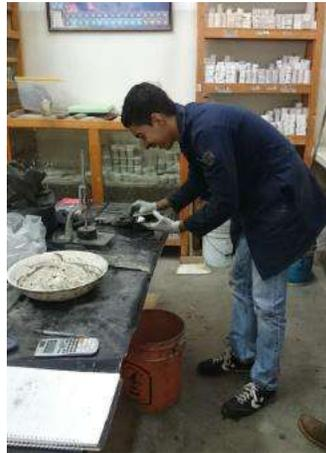
Figura 61. Moldeado de la pastilla CPC-5% CBC para la determinación de los tiempos de fraguado. (Fotografía: A. Flores Ponce).
