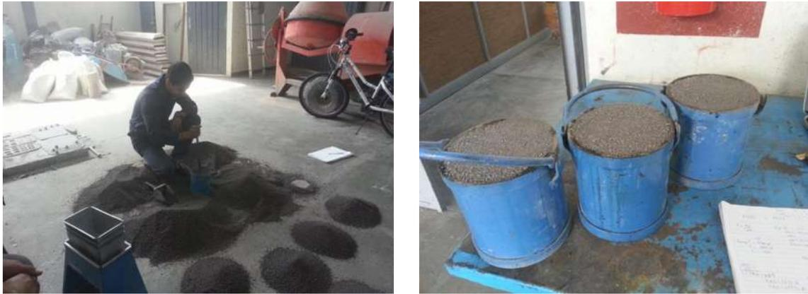
Figura 37. Llenado del recipiente en 3 capas dando 25 golpes por capa (izquierda). El procedimiento se repite 3 veces para obtener un valor confiable (derecha). (Fotografías: E. González Castro).
