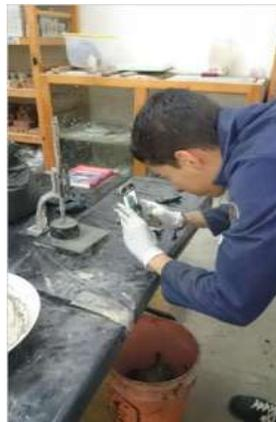
Figura 59. Medición de la penetración con el aparato de Vicat en la pasta CPC-5% CBC. (Fotografía: A. Flores Ponce).
