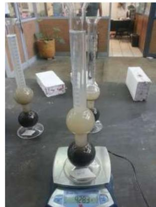
Figura 39. Muestra de 300 g arena seca superficialmente (izquierda). Matraz de Chapman con la muestra de arena una vez que se han sacado las burbujas de aire (derecha).
