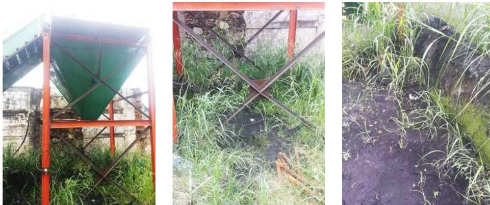
Figura 27. Tolva de almacenamiento y canalización de la CBC producida (izquierda). CBC en estado húmedo debajo de la tolva (centro). CBC que se extrajo para su traslado y posterior análisis y empleo en el laboratorio de resistencia de materiales de la U.M.S.N.H. (derecha). (Fotografías: E. González Castro).
