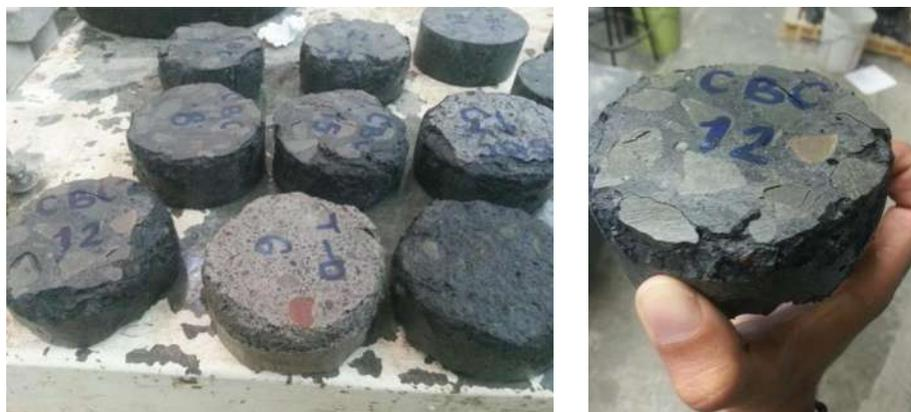
Figura 104. Deterioro por la expansión de cristales al final del cuarto ciclo. (Fotografías: E. González Castro).
