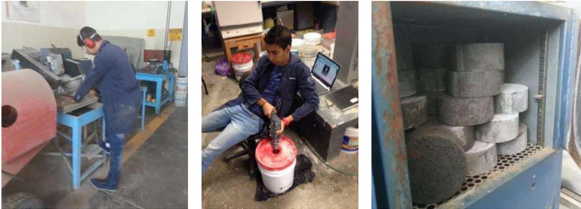
Figura 100. Corte de los cilindros (izquierda). Preparación de la solución de sulfato de sodio (centro). Secado en el horno a temperatura de 50°C (derecha). (Fotografías: E. González Castro).
