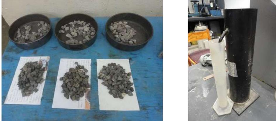
Figura 40. Muestras representativas de agregado grueso superficialmente seco (charolas) y material seco en la parrilla (hojas de papel, izquierda) (Fotografía: E. González Castro). Picnómetro en prueba de densidad (derecha). (Fotografía: F. López Regalado).
