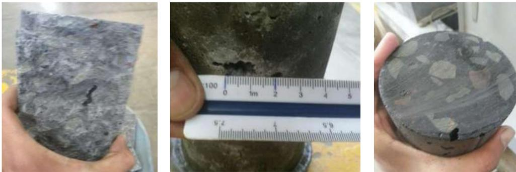
Figura 110. Poros internos en concreto CPC-10%CBC. (Fotografías: E. Glez. Castro).
