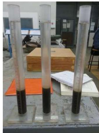
*Figura 44. Probeta conteniendo la solución de trabajo hasta una altura de 10 cm (izquierda). Probetas reposando después de haber sido agitadas (derecha). (Fotografías: E. González Castro).*
