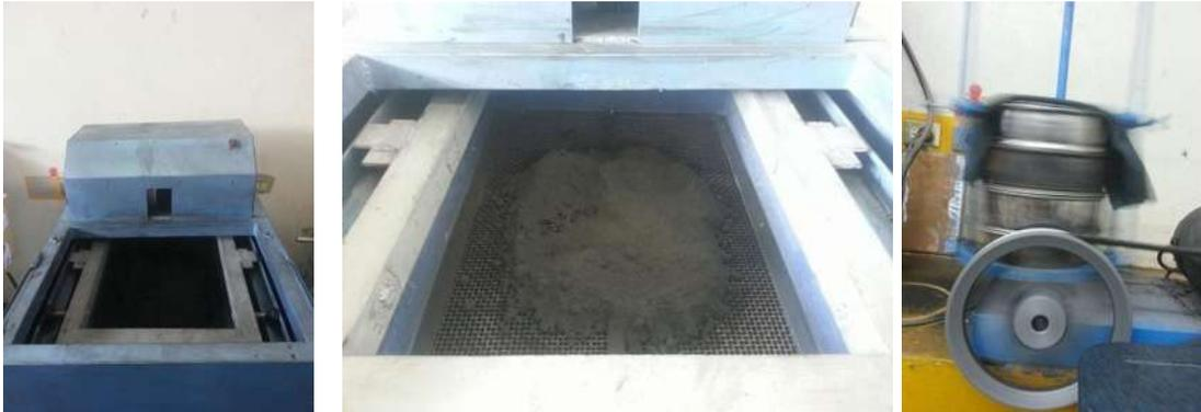
*Figura 53. Máquina cribadora (izq.). Muestra de ceniza para cribado (centro). Máquina Raf-tap terminando el proceso de cribado (derecha). (Fotografía: E. Glez. Castro).*
