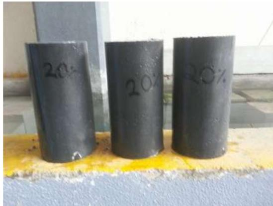
Figura 63. Cilindros de la mezcla CPC-20%CBC. (Fotografía: E. González Castro).
