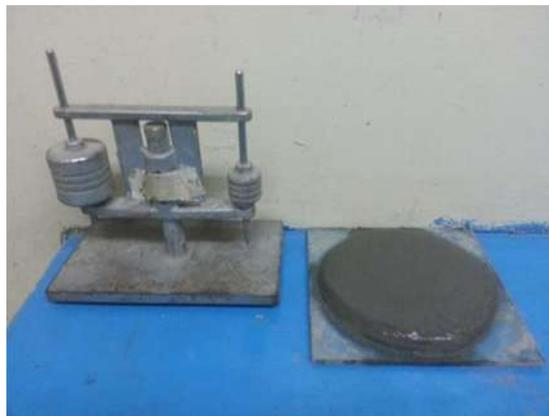
Figura 50. Aparato de Gillmore y pastilla de cemento resultado del ensaye de consistencia normal, ambos en el cuarto húmedo. (Fotografía: E. González Castro).
