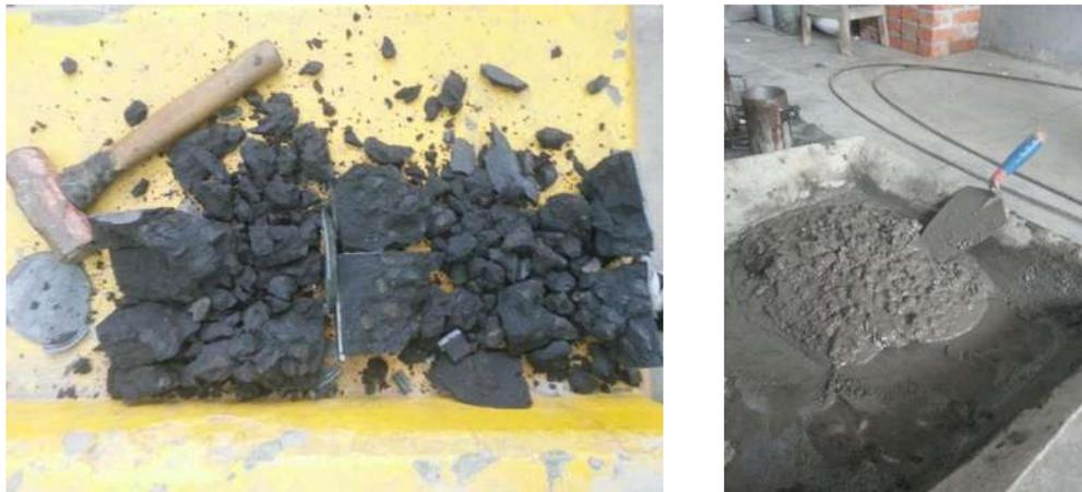
Figura 69. Estructura interna de un cilindro y mezcla CPC-10%CBC. (Fotografías: E. González Castro).
