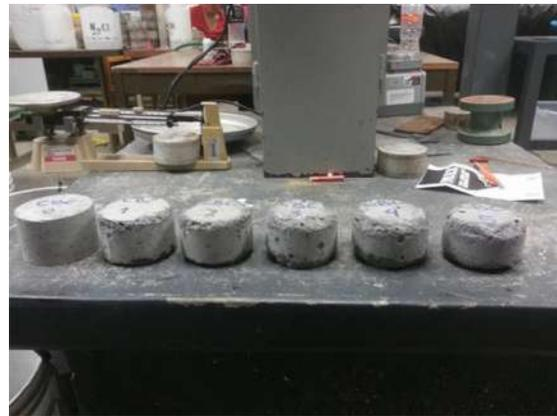
Figura 99. Comparativa de las pastillas 0 a 500 revoluciones. Mezcla testigo (izquierda).
