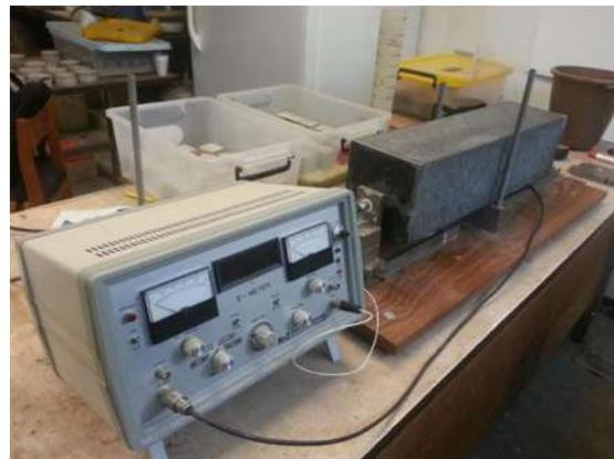
Figura 90. Determinación de la masa del espécimen (izquierda). Colocación de la viga en el aparato E-meter para medir la resonancia (derecha). (Fotografías: E. González Castro).
