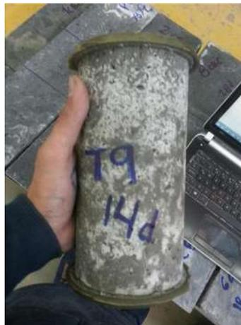
Figura 77. Cilindro cabeceado con mortero de azufre. (Fotografía: E. González Castro).
