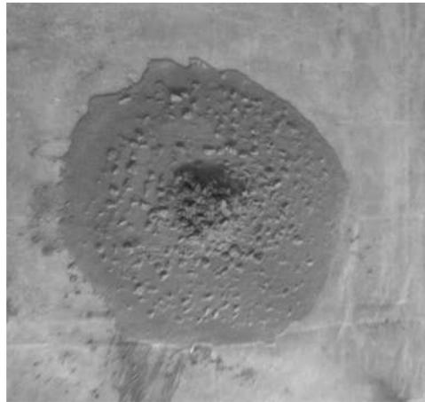
Figura 71. Asentamiento en la mezcla testigo. (Fotografía: E. González Castro).
