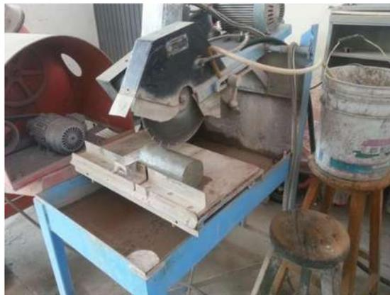
Figura 97. Corte de los cilindros para obtener las pastillas. (Fotografía: E. Glez. Castro).
