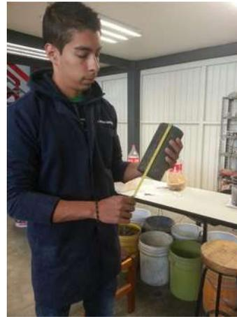
Figura 94. Medición de masa y longitud de los especímenes. (Fotografías: E. González Castro).
