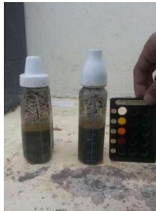
*Figura 42. Comparación del color de las botellas con la escala colorimétrica (arena volcánica). (Fotografía: E. González Castro).*
