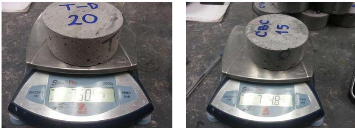
Figura 103. Determinación de la masa antes de iniciar los ciclos de prueba. Testigo y CPC-10%CBC. (Fotografías: E. González Castro).
