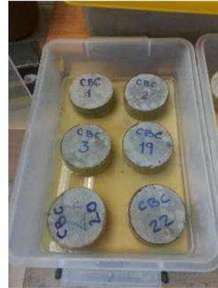
Figura 96. Preparación de las pastillas (izquierda). Pastillas CPC-10%CBC sobre la cama de agua. (Centro y derecha). (Fotografías: E. González Castro).
