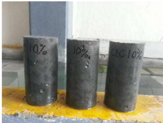
Figura 65. Cilindros de la mezcla CPC-10%CBC. (Fotografía: E. González Castro).
