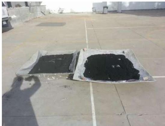
*Figura 52. Secado de la ceniza al sol, charola con CBC después del primer secado a la izquierda y CBC apenas extendida y con su humedad de campo, a la derecha y de un color más oscuro. (Fotografía: E. González Castro).*
