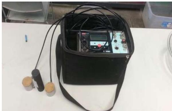
Figura 93. Equipo para la medición de la velocidad de pulso. (Fotografía: E. Glez. Castro).
