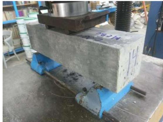
Figura 86. Marca de los tercios de la viga (izquierda). Viga apoyada a una distancia de 3 veces el peralte de la misma (derecha). (Fotografías: E. González Castro).
