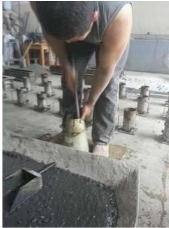
Figura 70. Revenimiento del concreto. Prueba fallida. (Fotografía: E. González Castro).
