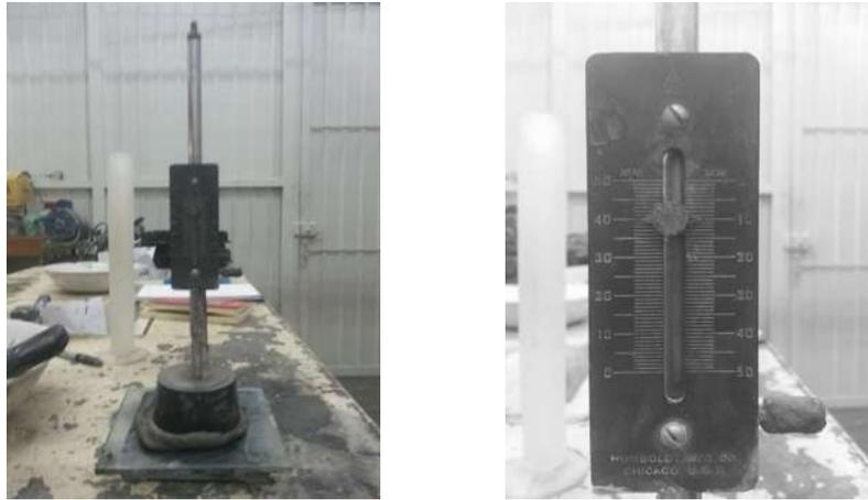
Figura 47. Aparato de Vicat con la masa de cemento antes de tomar la lectura (izquierda). Lectura final, penetración de la aguja de Vicat de 10 mm (derecha). (Fotografías: E. González Castro).
