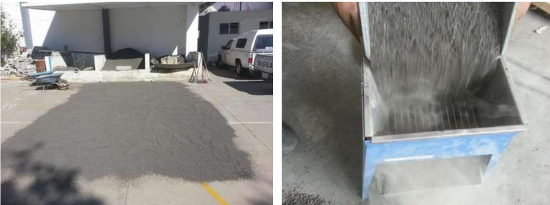
*Figura 33. Extendido de la arena sobre una superficie limpia para su secado al sol (izquierda). Uso del divisor mecánico (derecha). (Fotografías: E. González Castro).*
