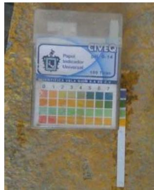
Figura 75. Medición del pH del agua de la pila de curado. (Fotografías: E. González Castro).
