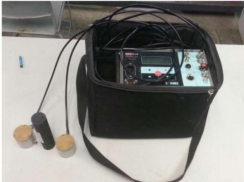
Figura 3.57. Equipo para medir la Velocidad de Pulso Ultrasónico. (E. González Castro, 2016).
