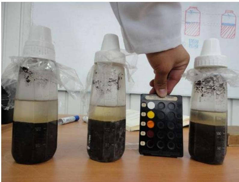
Figura 4.2. Comparación del resultado de la prueba con la tabla colorimétrica. (F. López Regalado, 2016).
