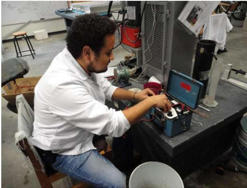
Figura 3.56. Medición de la Resistividad Eléctrica. (F. López Regalado, 2016).
