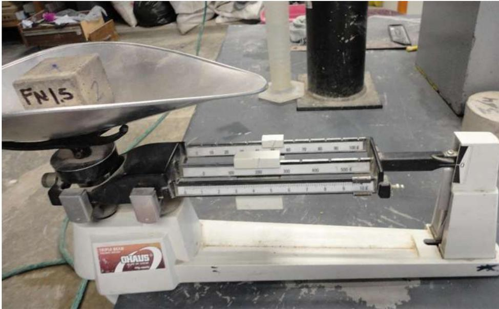
Figura 3.51. Pesado del espécimen marcado y superficialmente seco. (F. López Regalado, 2016).
