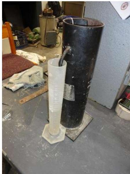
*Figura 3.50. Picnómetro y probeta a utilizar en la determinación de la densidad. (F. López Regalado, 2016).*
