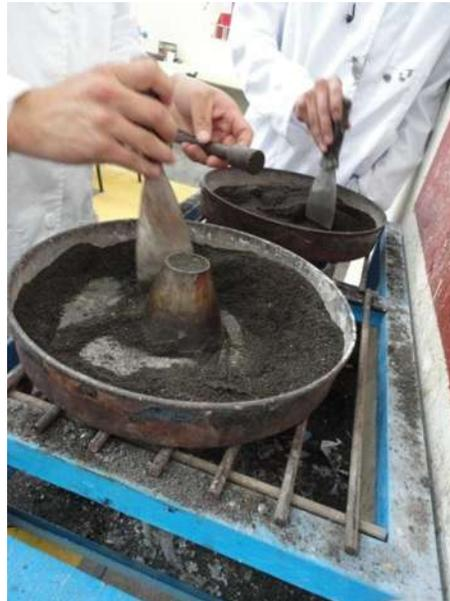
Figura 3.11. Secado superficial de la muestra mediante el molde troncocónico. (F. López Regalado, 2016).
