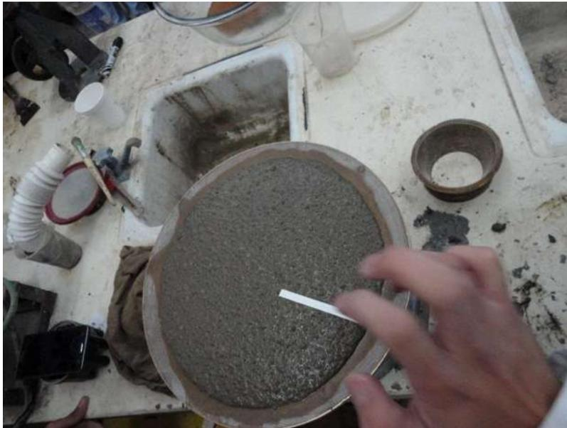
Figura 3.35. Determinación del pH en el mortero fresco. (F. López Regalado, 2016).
