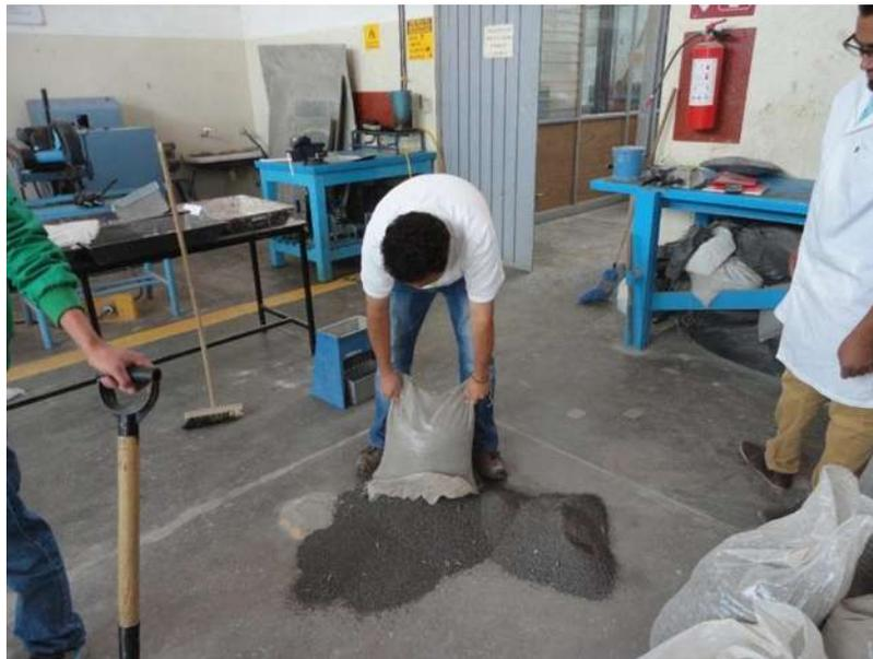
*Figura 3.7. Colocación del material en una superficie limpia. (F. López Regalado, 2016).*
