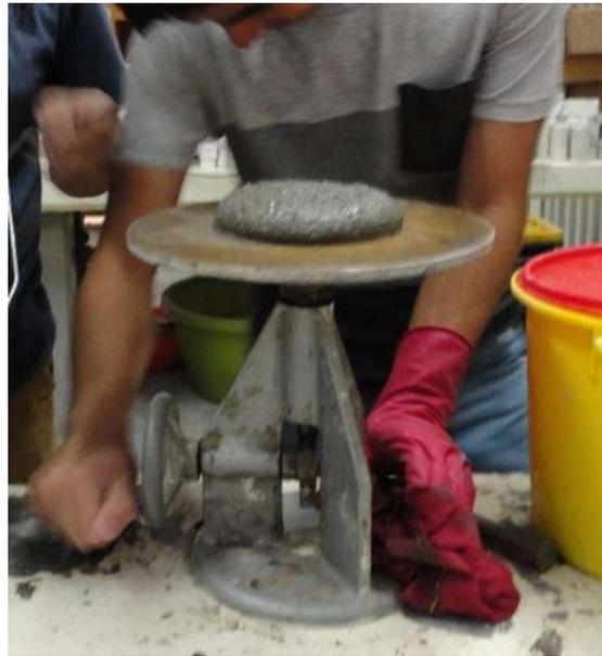
Figura 3.32. Expansión de la mezcla de forma manual, haciendo girar la leva. (F. López Regalado, 2016).
