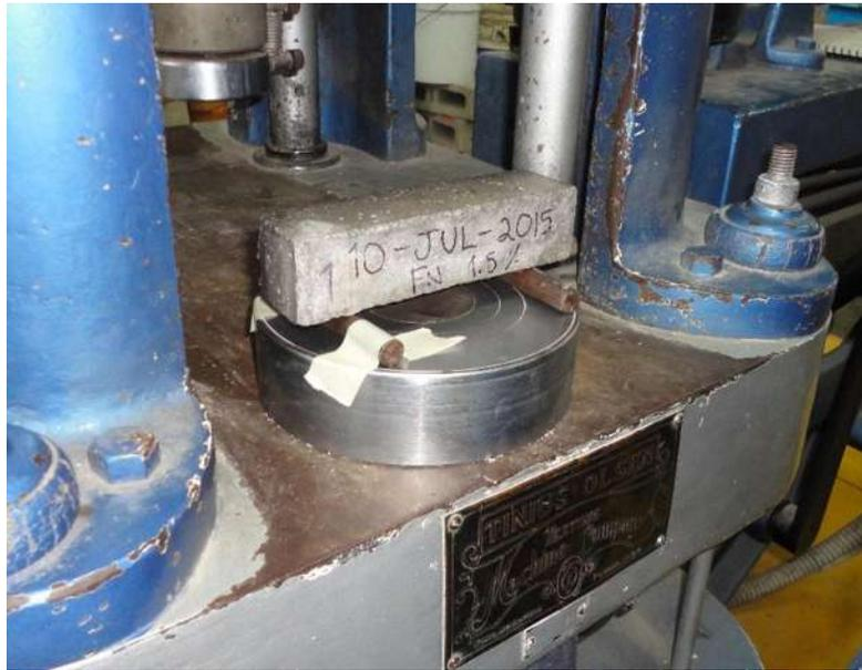
Figura 3.63. Colocación del prisma sobre los apoyos. (F. López Regalado, 2016).
