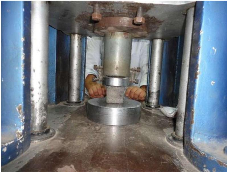
Figura 3.59. Centrado del espécimen entre las platinas. (F. López Regalado, 2016).
