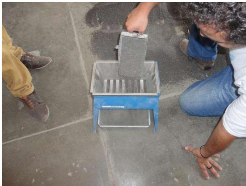
Figura 3.6. Agregado de la muestra a través del divisor. (F. López Regalado, 2016).
