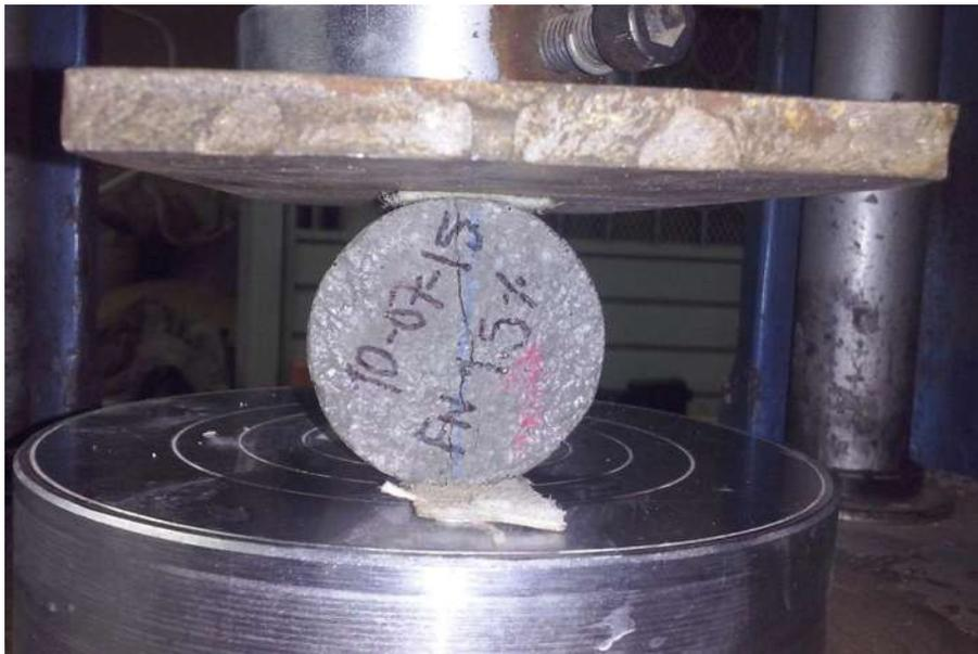
Figura 3.73. Falla del cilindro por tensión indirecta. (F. López Regalado, 2016).
