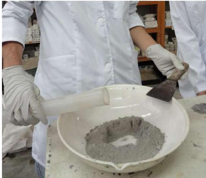
Figura 3.2. Agregado del agua al cemento. (F. López Regalado, 2016).
