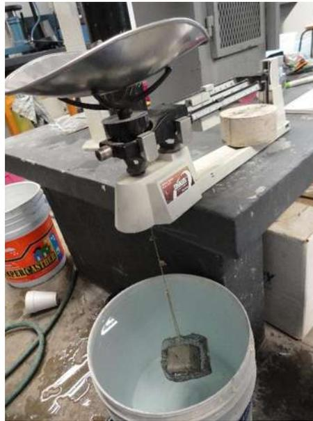
Figura 3.53. Determinación de la gravedad específica. (F. López Regalado, 2016).
