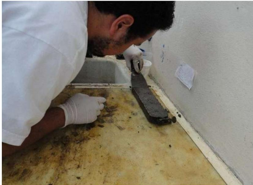
Figura 3.45. Enrazado de las briquetas. (F. López Regalado, 2016).
