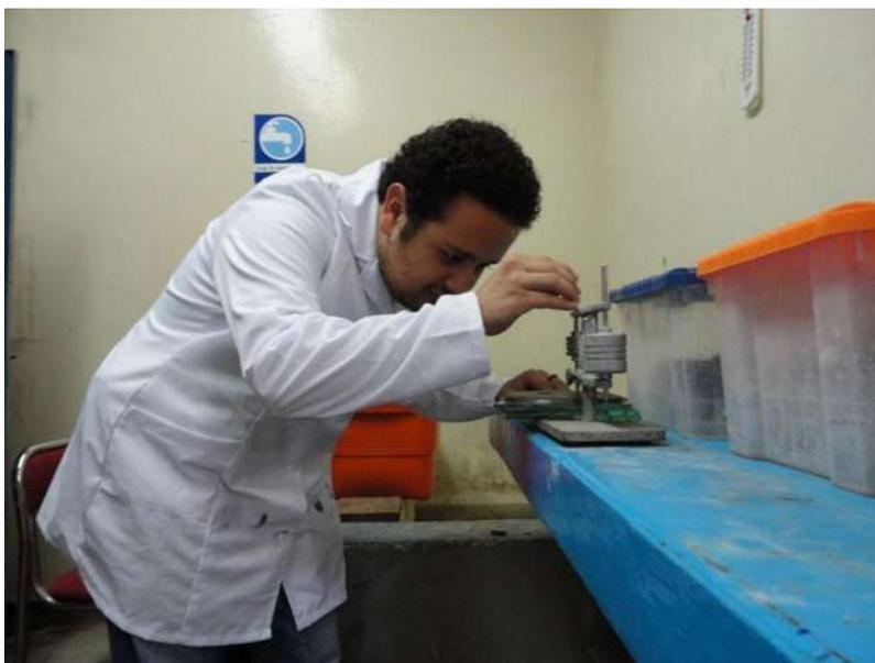
Figura 3.4. Medición del tiempo de fraguado (F. López Regalado, 2016).
