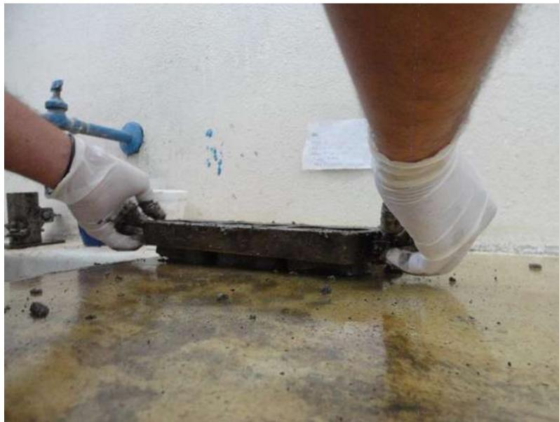
Figura 3.46. Retiro del molde en la elaboración de briquetas. (F. López Regalado, 2016).
