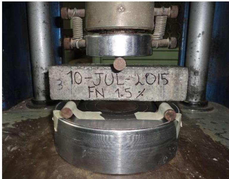
Figura 3.64. Colocación del prisma en la máquina universal de pruebas Tinius Olsen. (F. López Regalado, 2016).
