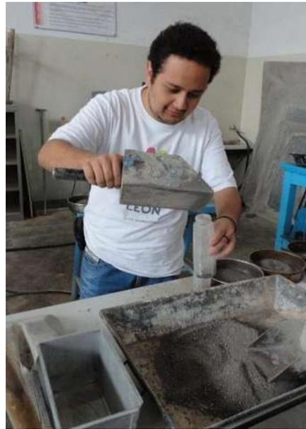
Figura 3.20. Vaciado del material dentro del biberón. (F. López Regalado, 2016).
