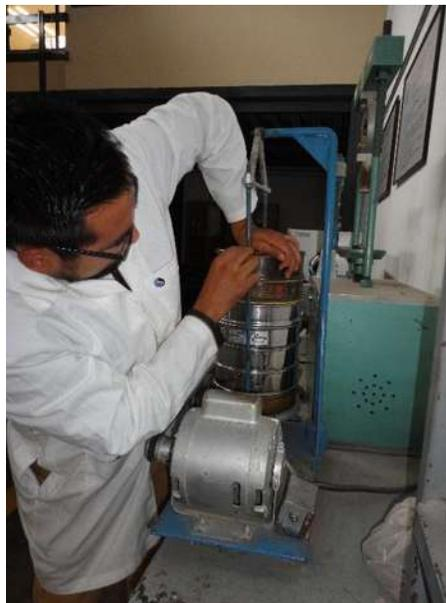
Figura 3.15. Utilización de la maquina Raf-tap para agitar la muestra. (F. López Regalado, 2016).
