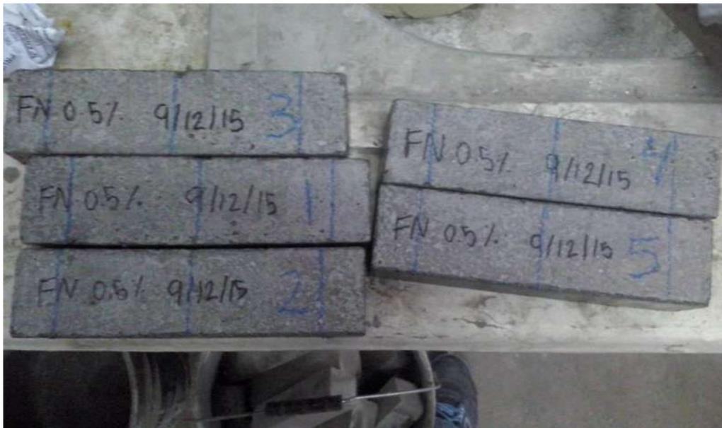
Figura 3.62. Marcado de los prismas a dos centímetros de sus extremos y al centro del claro. (F. López Regalado, 2016).
