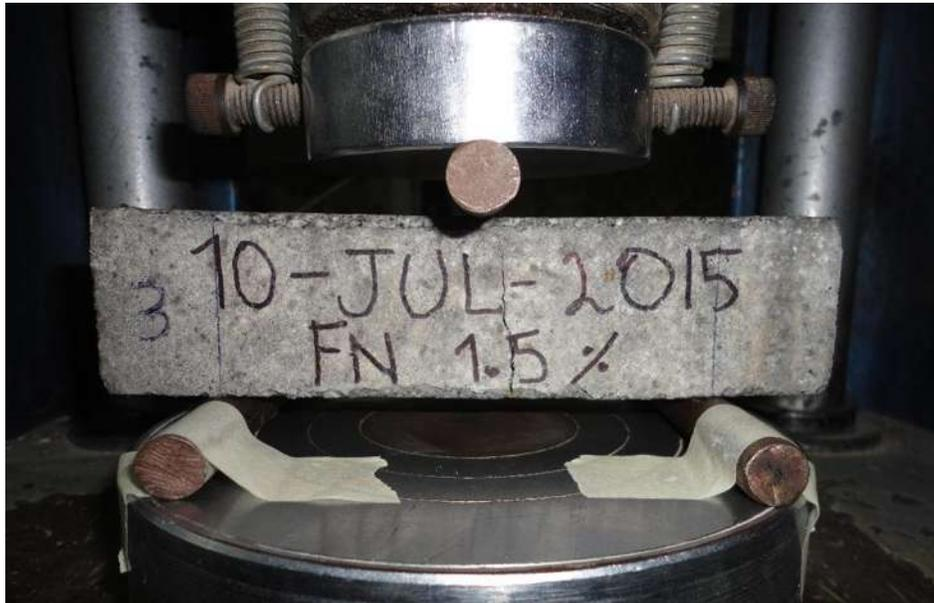
Figura 3.65. Fractura del espécimen sometido a tensión por flexión. (F. López Regalado, 2016).
