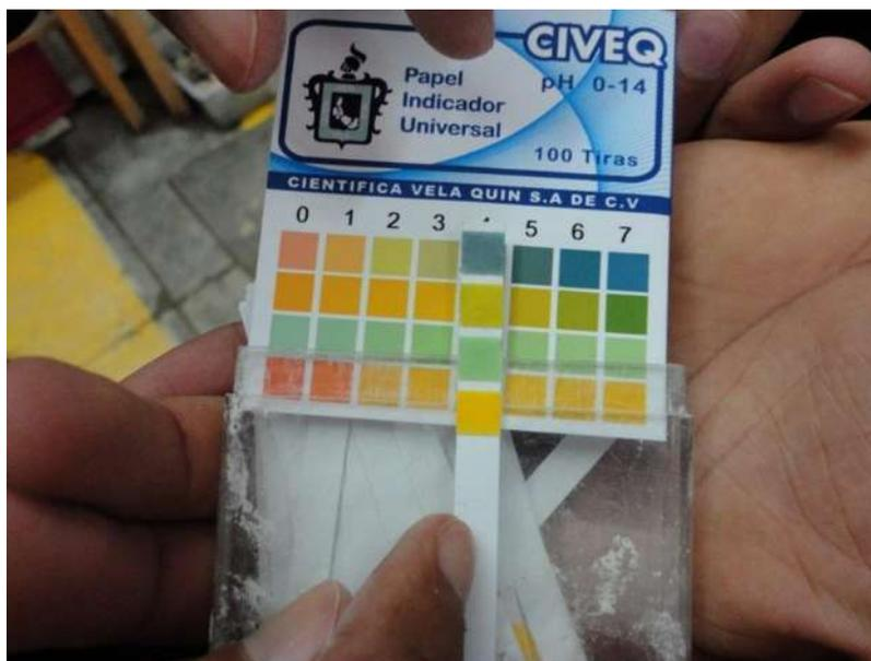
Figura 3.34. Instrumentos para realizar la medición del pH. (F. López Regalado, 2016).
