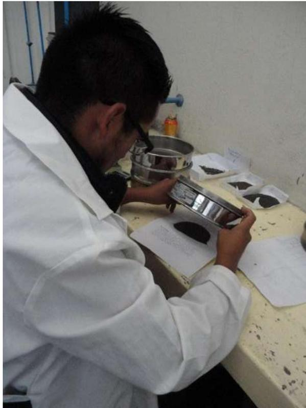
*Figura 3.16. Extracción del material retenido en cada una de las mallas. (F. López Regalado, 2016).*
