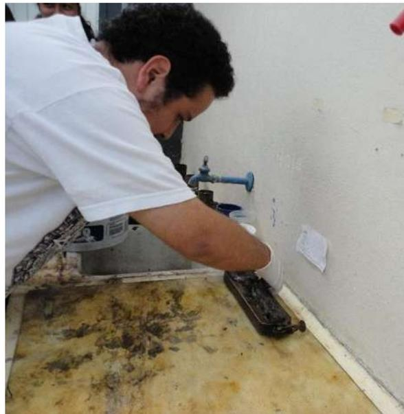
Figura 3.44. Apisonado de la mezcla para la elaboración de briquetas. (F. López Regalado, 2016).
