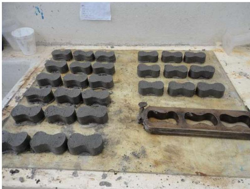
Figura 3.48. Briquetas terminadas colocadas sobre una superficie de vidrio previamente engrasada. (F. López Regalado, 2016).
