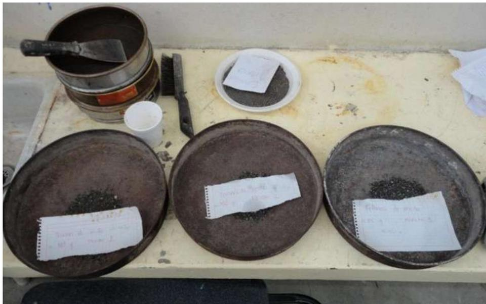
*Figura 3.27. Muestras representativas para la realización de la prueba de terrones de arcilla. (F. López Regalado, 2016).*
