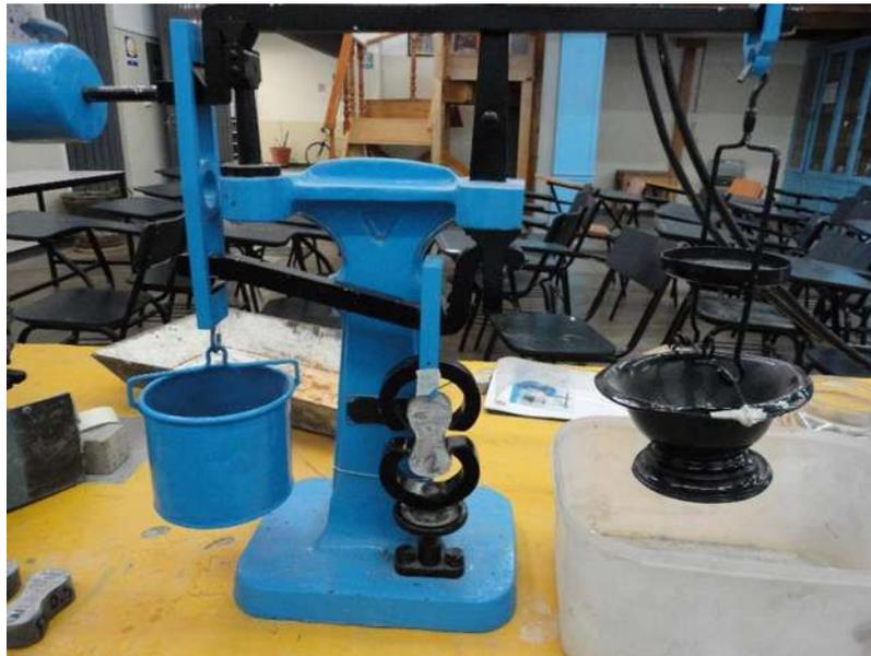
*Figura 3.67. Nivelación de la máquina de pruebas para tensión en morteros tipo Michaelis. (F. López Regalado, 2016).*
