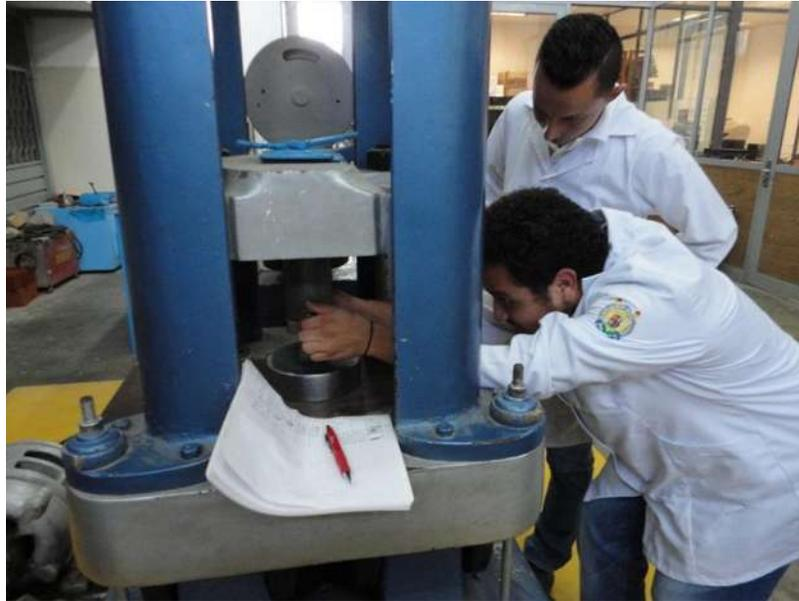
Figura 3.58. Colocación del espécimen en la máquina de prueba Tinius Olsen. (F. López Regalado, 2016).
