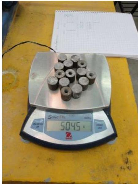
Figura 3.70. Obtención de la masa de los cilindros metálicos. (F. López Regalado, 2016).
