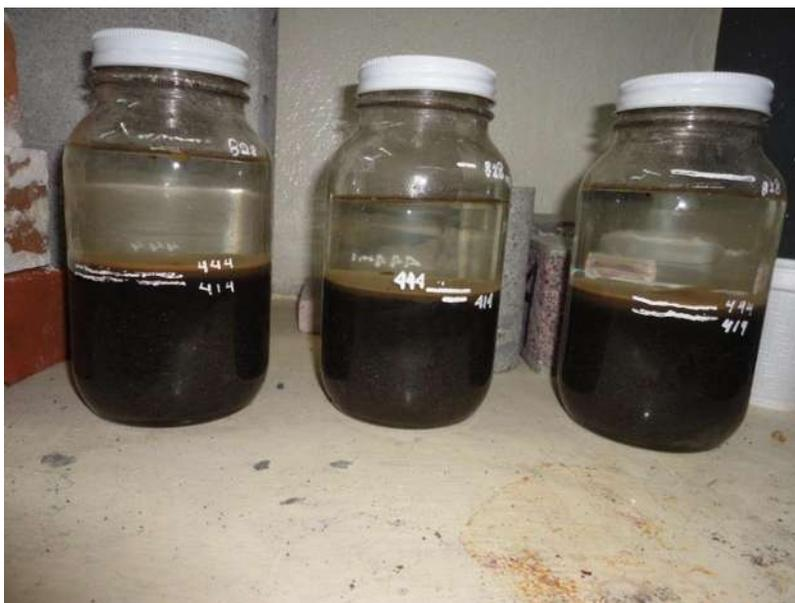
Figura 4.3. Resultados de la prueba de sedimentación. (F. López Regalado, 2016).
