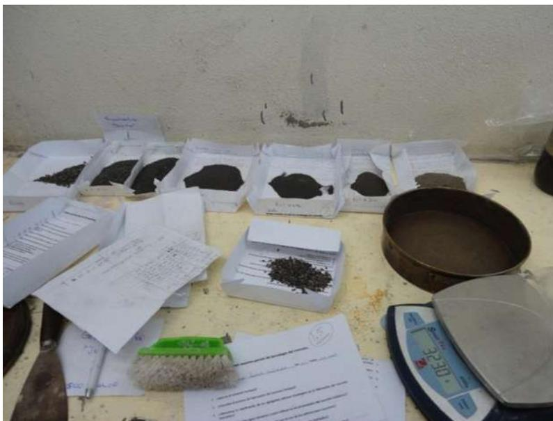
Figura 3.17. Material retenido en cada una de las mallas previamente pesado. (F. López Regalado, 2016).
