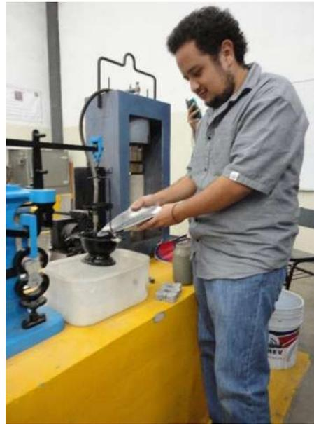
Figura 3.68. Colocación de las municiones hasta la falla de la briqueta. (F. López Regalado, 2016).
