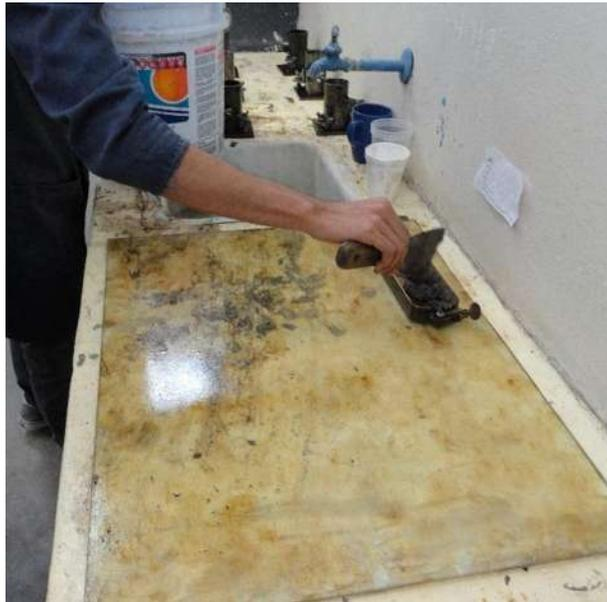
Figura 3.43. Llenado de los moldes para la elaboración de briquetas. (F. López Regalado, 2016).
