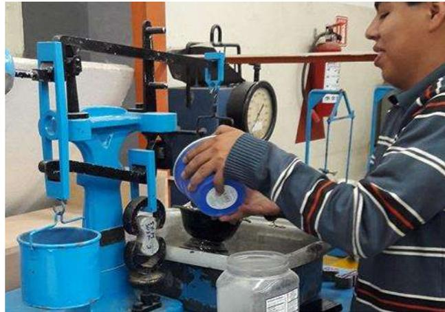
*Ilustración 66. Colocación de las municiones en la tolva de la máquina (Fotografía L. Colín)*
