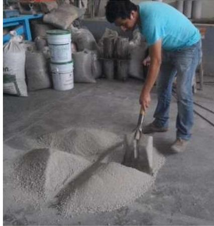
*Ilustración 23. División de la muestra en 4 partes iguales (Fotografía J. Méndez).*
