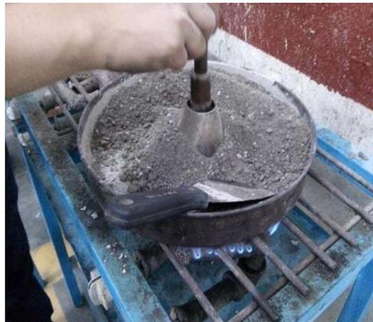
*Ilustración 24. Secado superficial del agregado con ayuda del cono troncocónico (Fotografía L. Colín).*
