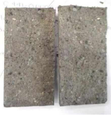
Ilustración 65. Vista de la matriz del cilindro después de la prueba de tensión indirecta (Fotografía L. Colín).
