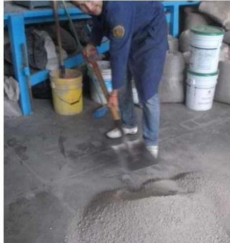
*Ilustración 20. Colocación del agregado en una superficie limpia (Fotografía L. Colín).*
