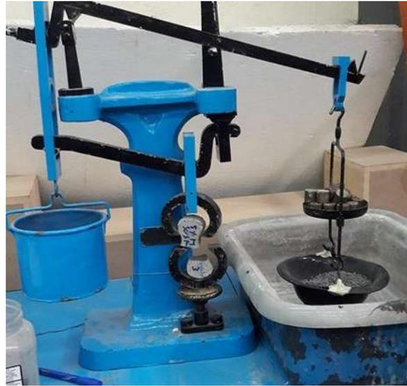
Ilustración 67. Falla de briqueta por prueba de tensión directa (Fotografía L. Colín)
