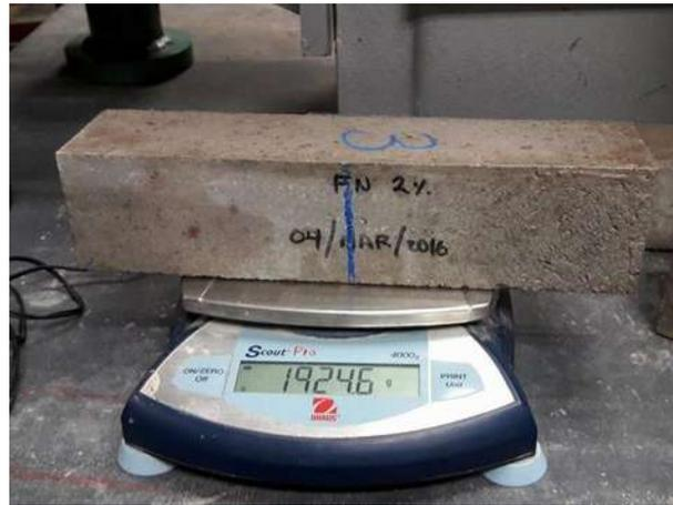
*Ilustración 68. Obtención de la masa del espécimen al inicio de la prueba de congelamiento y deshielo (Fotografía L. Colín).*
