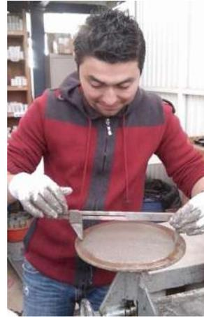
*Ilustración 45. Toma de mediciones para determinar la fluidez (Fotografía L. Colín).*
