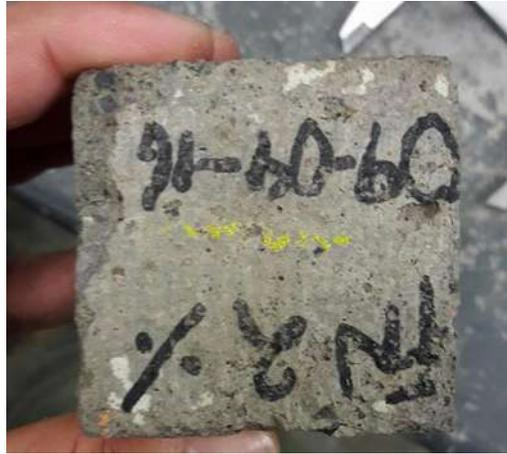
*Ilustración 72. Afectaciones en el cubo de mortero en el quinto ciclo de la prueba de sulfatos (Fotografía L. Colín).*
