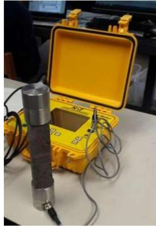
*Ilustración 55. Prueba Velocidad de Pulso Ultrasónico (Fotografía L. Colín).*
