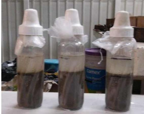
*Ilustración 31. Colorimetría en arenas (Fotografía L. Colín)*
