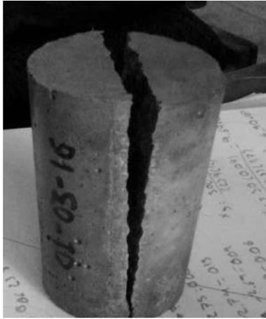
Ilustración 64. Falla de espécimen por tensión indirecta (Fotografía L. Colín)
