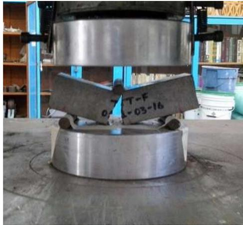
*Ilustración 70. Prueba a flexión después del 15° ciclo de congelamiento y deshielo (Fotografía L. Colín)*
