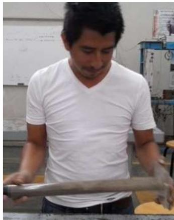
*Ilustración 39. Se agita el material dentro de la probeta durante 30 segundos (Fotografía L. Colín).*
