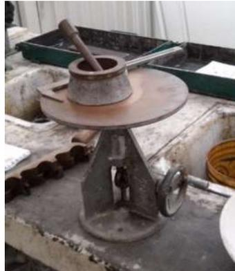
*Ilustración 41. Equipo a utilizar en la prueba de fluidez (Fotografía L. Colín).*
