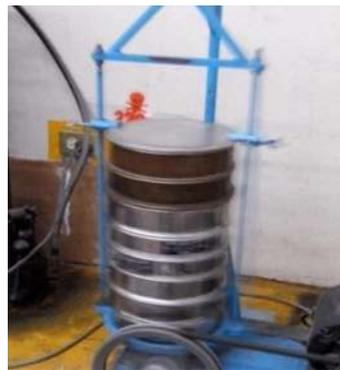
*Ilustración 28. Agitado mecánico (Raf-tap) (Fotografía L. Colín).*
