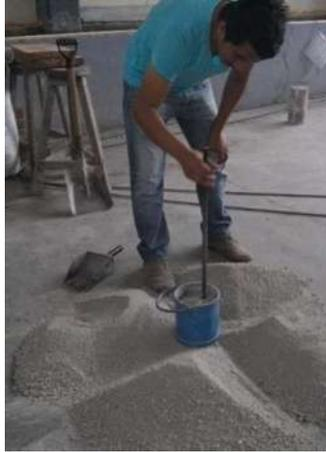
Ilustración 26. Llenado y varillado de MVSV (Fotografía L. Colín)
