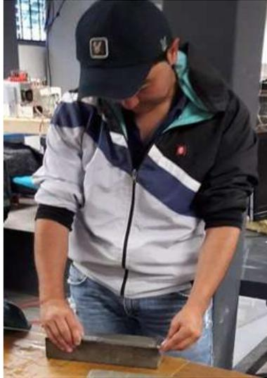
*Ilustración 60. Obtención de las medidas del prisma (Fotografía L. Colín)*
