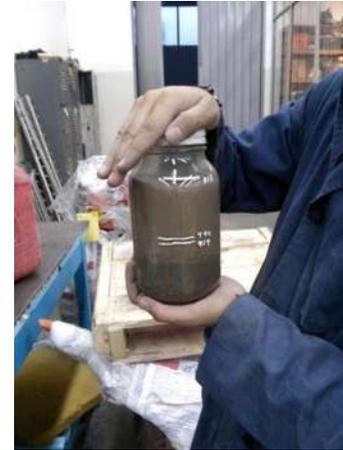
*Ilustración 34. Se agita el frasco durante dos minutos (Fotografía L. Colín).*
