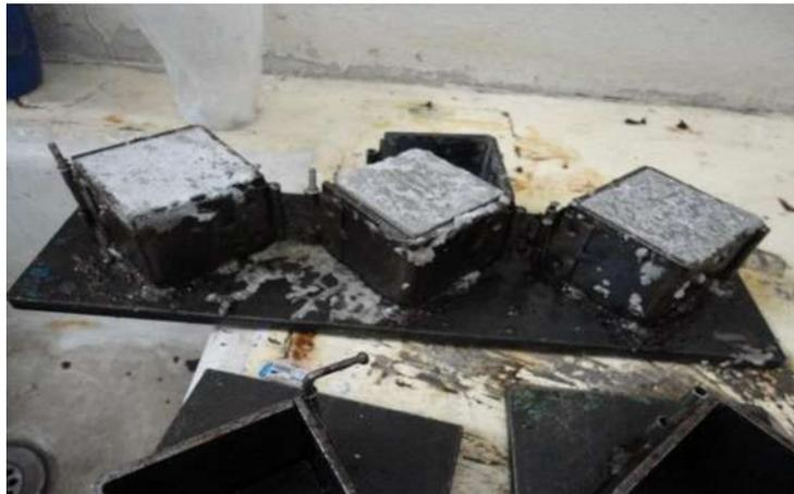
*Ilustración 50. Desmoldando cubos (Fotografías J. D. Álvarez).*
