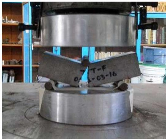
*Ilustración 61. Falla a flexión en prismas (Fotografía L. Colín)*
