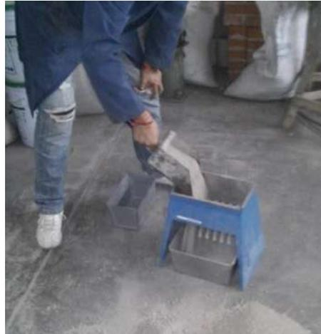
*Ilustración 19. Agregando el material al divisor de muestras mecánico (Fotografía L. Colín).*
