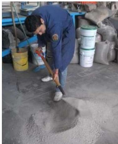
*Ilustración 21. Homogenización del material (Fotografía L. Colín).*
