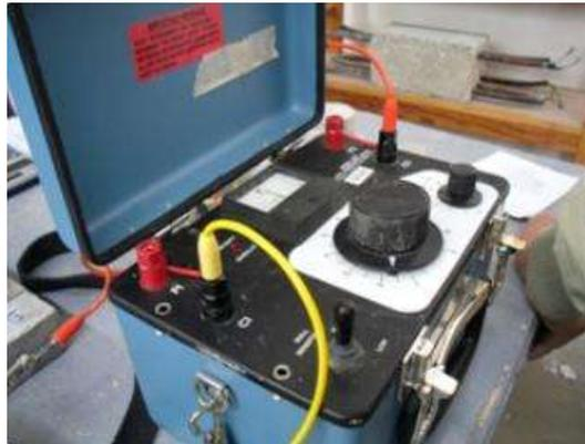
*Ilustración 56. Equipo utilizado en la determinación de resistividad eléctrica (Fotografía L. Colín).*
