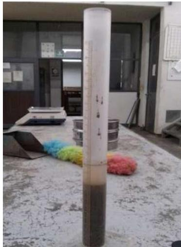
*Ilustración 40. Se deja reposar el material en la probeta durante 20 minutos (Fotografía L. Colín).*
