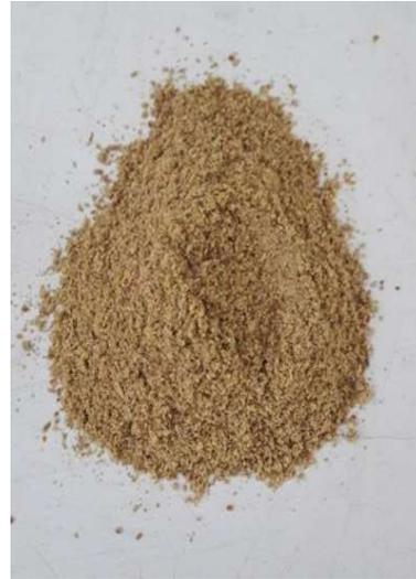
*Ilustración 12. Fibra de Nopal deshidrata utilizada en la investigación (Fotografía L. Colín)*
