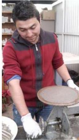
*Ilustración 44. Expansión de la mezcla de forma manual haciendo girar la leva (Fotografía L. Colín).*
