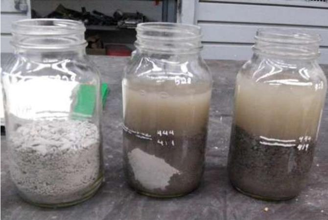
*Ilustración 33. Llenado del recipiente con material y agua hasta las marcas establecidas (Fotografía L. Colín).*
