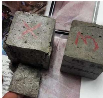
*Ilustración 59. Falla de la muestra sometida a compresión simple (Fotografía L. Colín).*
