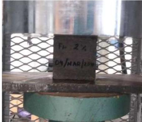
*Ilustración 58. Colocación del espécimen cubico sobre la base de la prensa hidráulica y al centro de la platina (Fotografía L. Colín).*
