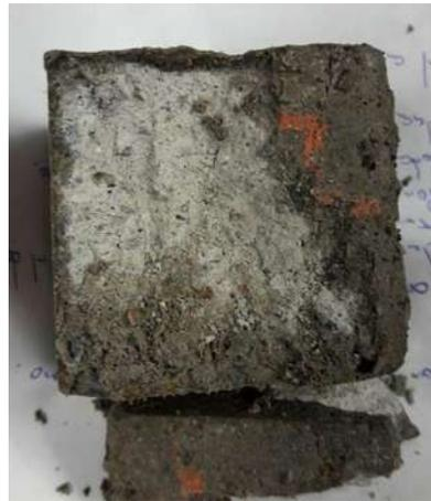
*Ilustración 71. Especimen fracturado después del cuarto ciclo de sulfatos (Fotografía L. Colín)*
