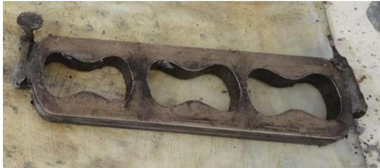
*Ilustración 51. Molde para la elaboración de briquetas (Fotografía L. Colín).*
