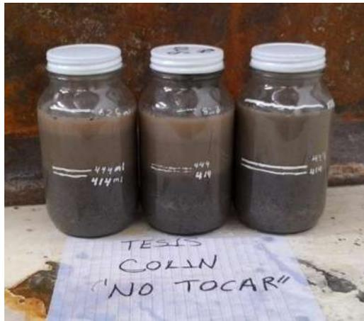
*Ilustración 35. Se deja reposar el material duran 24 horas (Fotografía L. Colín).*
