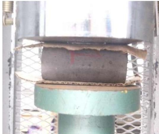
*Ilustración 63. Prueba de tensión indirecta (Fotografía L. Colín)*
