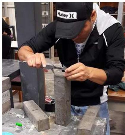
*Ilustración 69. Medición de las caras del espécimen después del primer ciclo (Fotografías L. Colín)*
