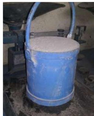
Ilustración 25. Llenado y pesado de la muestra en M.V.S.S (Fotografía L. Colín).
