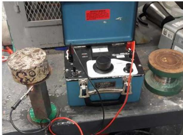
*Ilustración 57. Especimen prismático para tomar la resistividad eléctrica (Fotografía L. Colín).*
