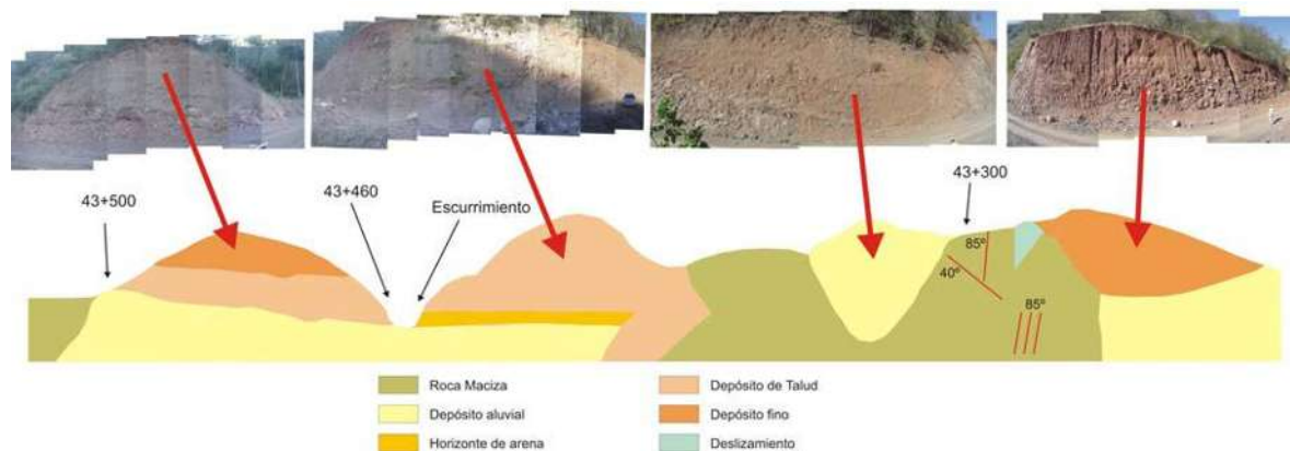
Figura 3-48 Perfil del talud ocho, se indican los cambios litológicos y las estructuras que están involucradas. (Chávez y Arreygue 2009).
