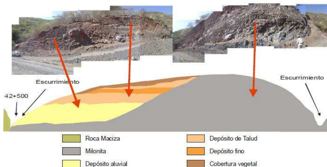
Figura 3-39 Perfil del talud seis, se indican los cambios litológicos y las estructuras que están involucradas. (Chávez y Arreygue 2009).
