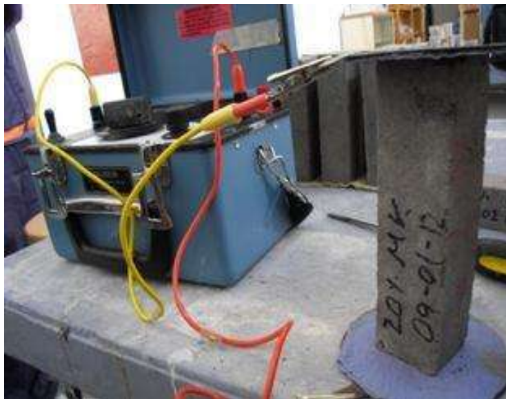
Ilustración 52. Izquierdo, espécimen prismático colocado entre las dos placas de cobre para tomar la resistencia eléctrica. Fuente: (Bernabé Reyes, 2015)
