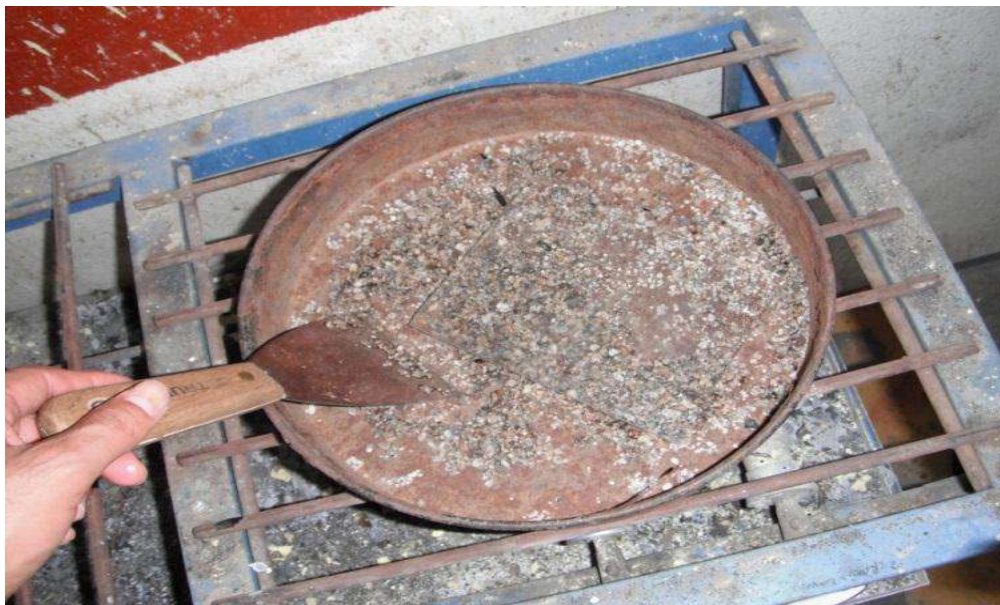
Ilustración 15. Secado de la arena en parrilla para obtener la Masa seca (Ms). Fuente: (Bernabé Reyes, 2015)
