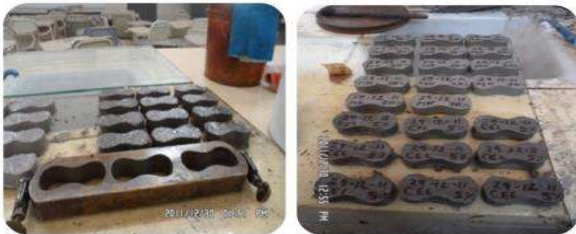
Ilustración 45. Elaboración de briquetas, utilizando molde y cristal previamente engrasado. Fuente: (Arguello Hernández, 2012)
