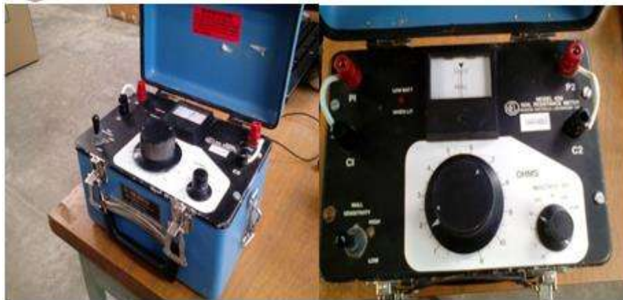
Ilustración 51. Equipo utilizado para determinar la resistividad eléctrica. Fuente: (T. Francisco Martínez)
