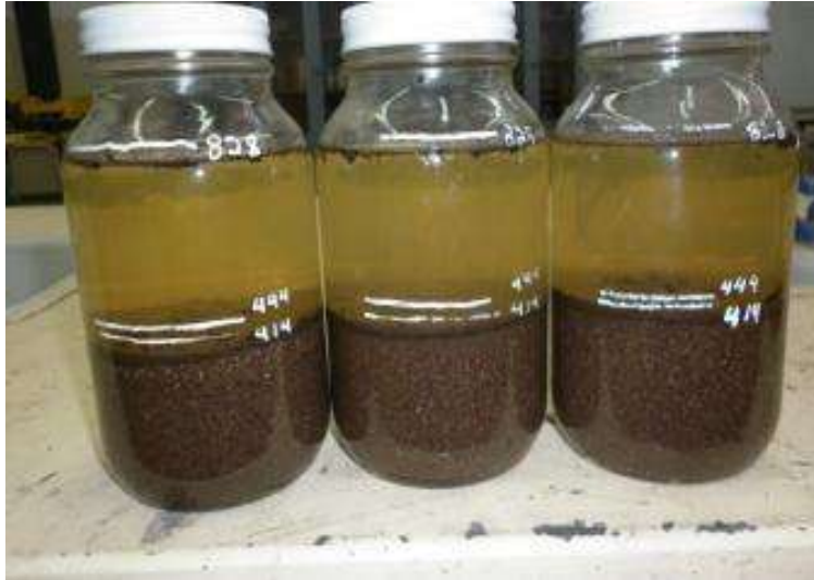
Ilustración 28. Determinación de sedimentos en la arena. Fuente: (Arguello Hernández, 2012)
