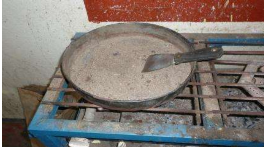
Ilustración 23. Secado del material, para la obtención de la Humedad actual. Fuente: (Arguello Hernández, 2012)
