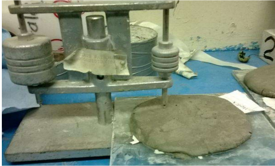
Ilustración 37. Aparato de Gillmore para la realización de los tiempos de fraguado. Fuente: (Bernabé Reyes, 2015)
