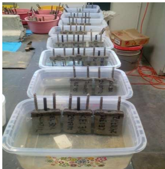
Ilustración 74. Recipientes conteniendo probetas inmersas en cloruro de sodio (NaCl). Fuente: (T. Francisco Martínez)
