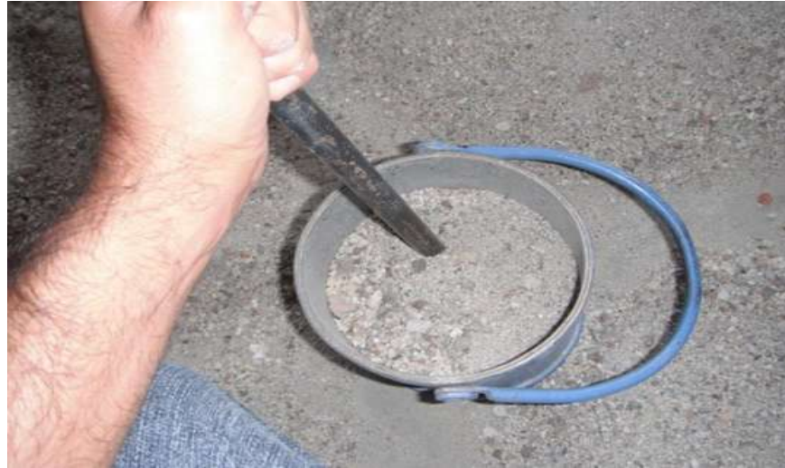
Ilustración 18. Varillado de la arena en la prueba MVSV. Fuente: (Bernabé Reyes, 2015)
