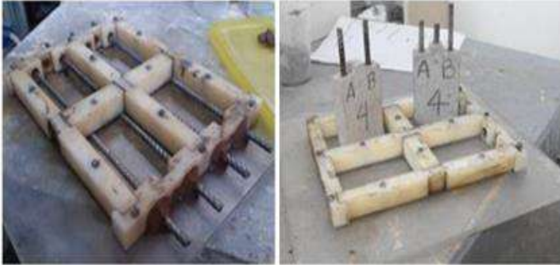
Ilustración 41. Moldes de acrílico para la elaboración de las probetas, parte izquierda, acomodo del acero de refuerzo en los moldes, parte derecha, exhibición de las muestras que se han de emplear en las pruebas electroquímicas. Fuente: (Bernabé Reyes, 2015)
