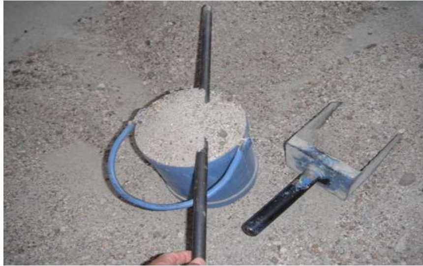
Ilustración 17. Equipo para realizar la prueba MVSS. Fuente: (Bernabé Reyes, 2015)
