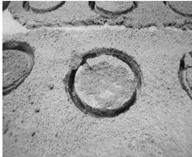
Ilustración 70. Falla en el revestimiento. Tipo 4. Fuente: (Bernabé Reyes, 2015)
