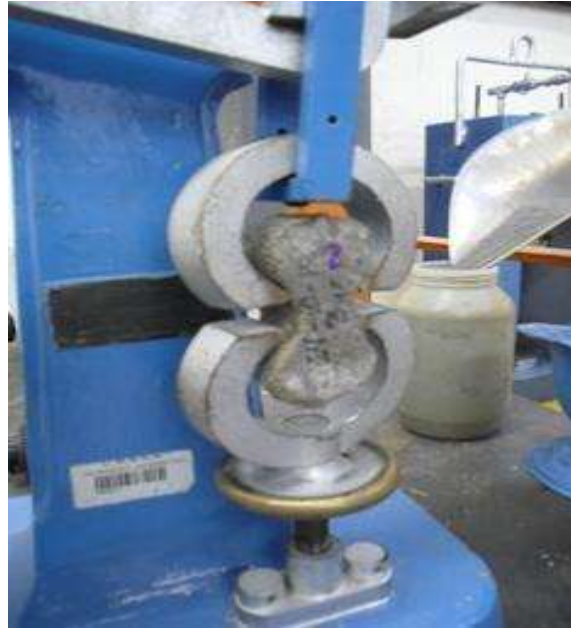
Ilustración 60. Aplicación de la fuerza de tensión sobre la briqueta. Fuente: (Arguello Hernández, 2012)
