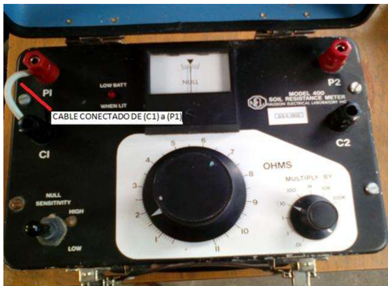
Ilustración 53. Cable conectado de C1 a P1. Fuente: (T. Francisco Martínez)
