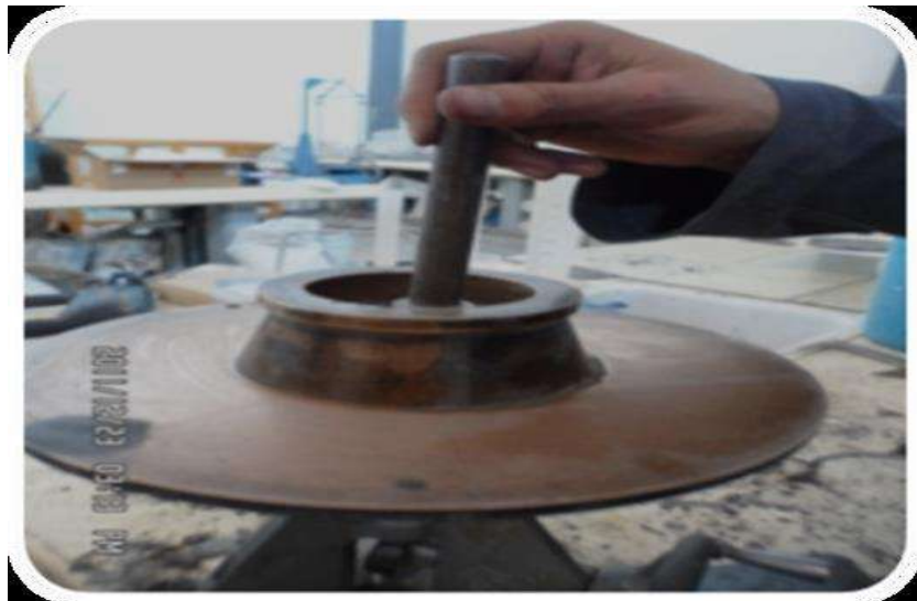
Ilustración 39. Llenado de molde sobre la mesa de fluidez. Fuente: (Bernabé Reyes, 2015)
