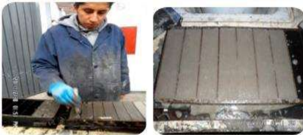
Ilustración 44. Llenado de especímenes prismáticos 4 cm x 4 cm x 16 cm. Fuente: (Arguello Hernández, 2012)
