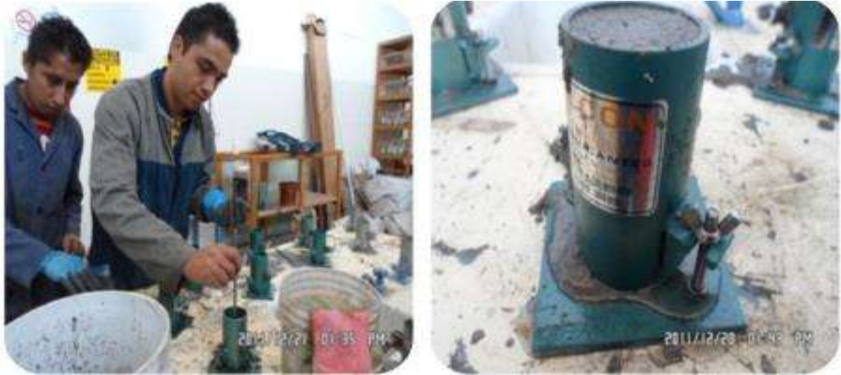
Ilustración 47. Fabricación de especímenes cilíndricos de 10 cm de altura por 5 cm de diámetro. Fuente: (Arguello Hernández, 2012)
