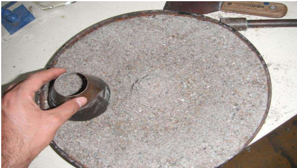
Ilustración 16. Procedimiento para obtener el secado superficial (NMX-C-165-ONNCCE, 2004). Fuente: (Bernabé Reyes, 2015)
