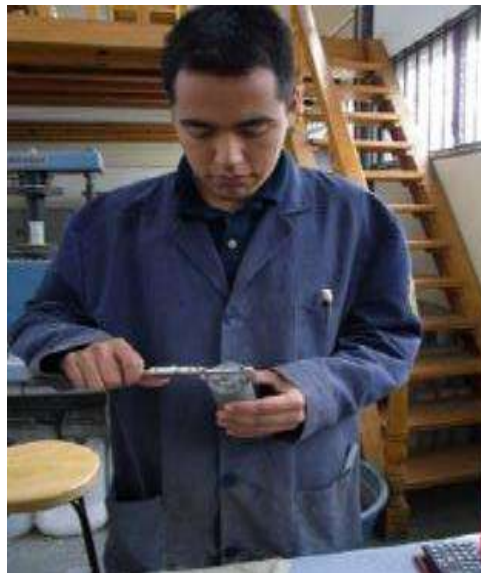
Ilustración 48. Medición de las dimensiones utilizando vernier. Fuente: (Bernabé Reyes, 2015)
