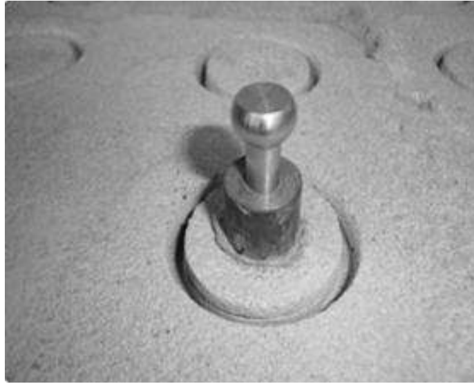
Ilustración 65. Disco y perno de acero para realizar la prueba de adherencia. Fuente: (Bernabé Reyes, 2015)
