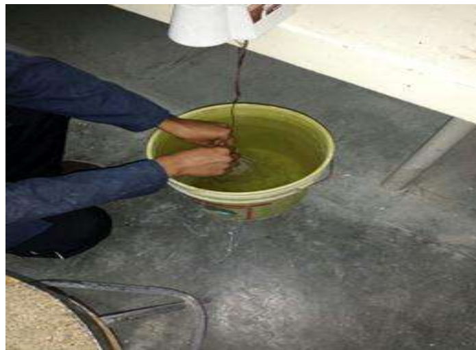
Ilustración 21. Calculo de la gravedad específica. Método de inmersión. Fuente: (Bernabé Reyes, 2015)
