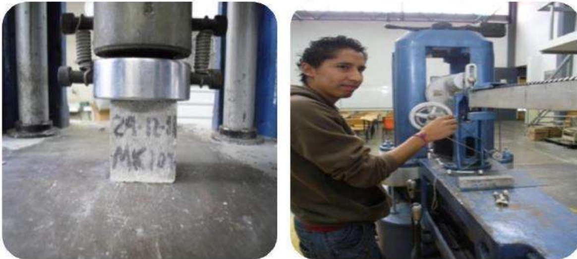
Ilustración 56. Prueba de Resistencia a compresión en cubos utilizando la máquina universal Tinius Olsen. Fuente: (Bernabé Reyes, 2015)
