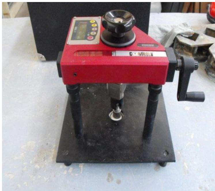
Ilustración 66. Equipo para prueba Pull off marca CONTROLS. Fuente: (Bernabé Reyes, 2015)
