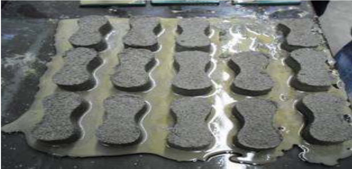
Ilustración 46. Sangrado en briquetas después de un momento de elaboradas. Fuente: (Arguello Hernández, 2012)
