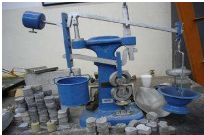
Ilustración 59. Máquina Michaelis para prueba a tensión en briquetas. Fuente: (Arguello Hernández, 2012)
