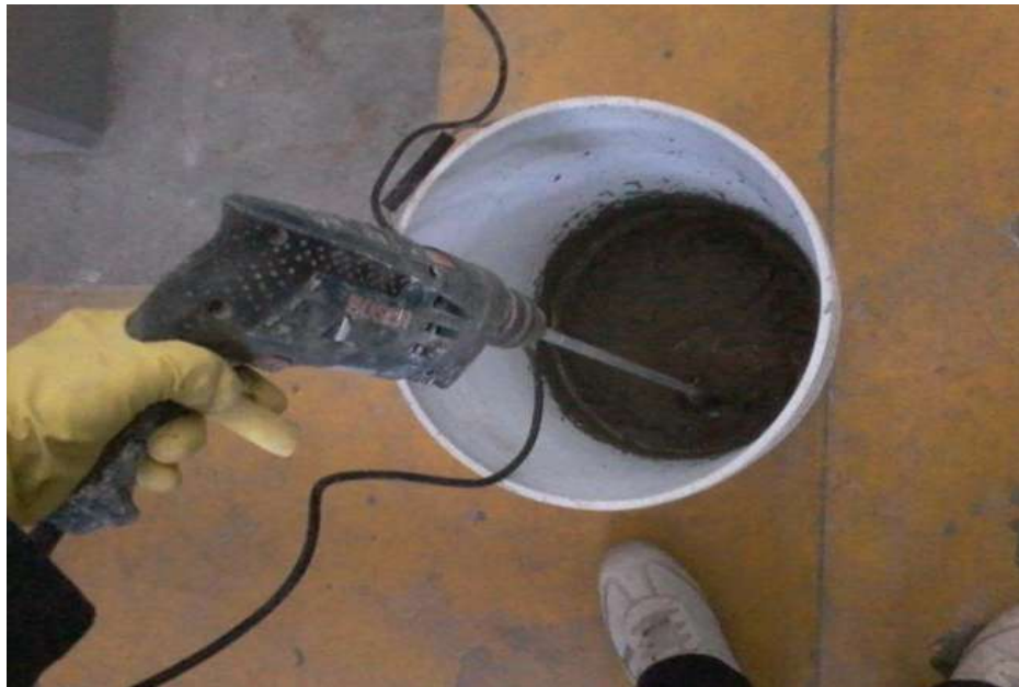
Ilustración 38. Método de mezclado de áridos mediante aspas de acero impulsado por el taladro. Fuente: (Bernabé Reyes, 2015)
