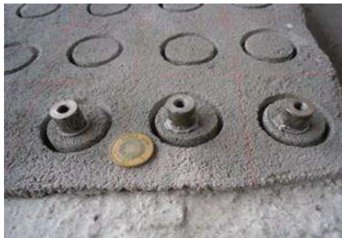
Ilustración 64. Relación de dimensiones de las perforaciones y discos utilizados. Fuente: (Bernabé Reyes, 2015)
