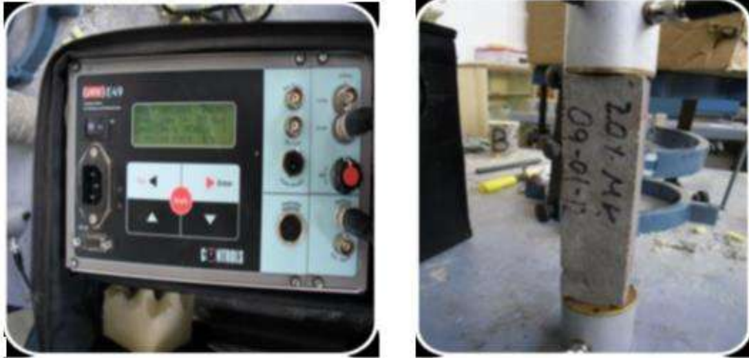
Ilustración 50. Equipo para medir la velocidad de pulso ultrasónico (a la izquierda) y espécimen prismático colocado sobre los transductores al ser realizada la prueba de velocidad de pulso ultrasónico (a la derecha), (ASTM-C-597, 2009). Fuente: (Bernabé Reyes, 2015)
