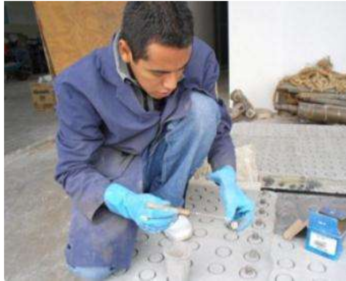
Ilustración 63. Pegado de los discos de acero en el recubrimiento de mortero. Fuente: (Bernabé Reyes, 2015)
