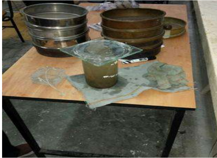
Ilustración 22. Cálculo de la gravedad específica. Método de inmersión. Fuente: (Bernabé Reyes, 2015)
