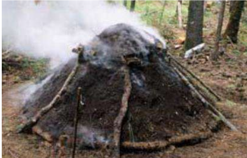
Ilustración 34. Horno tipo parva o montículo. Fuente: (AMILCAR CANUL TUN, 2013)
