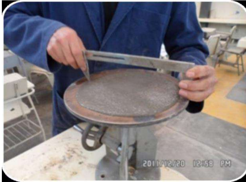
Ilustración 40. Medición del radio de expansión de la mezcla. Fuente: (Bernabé Reyes, 2015)
