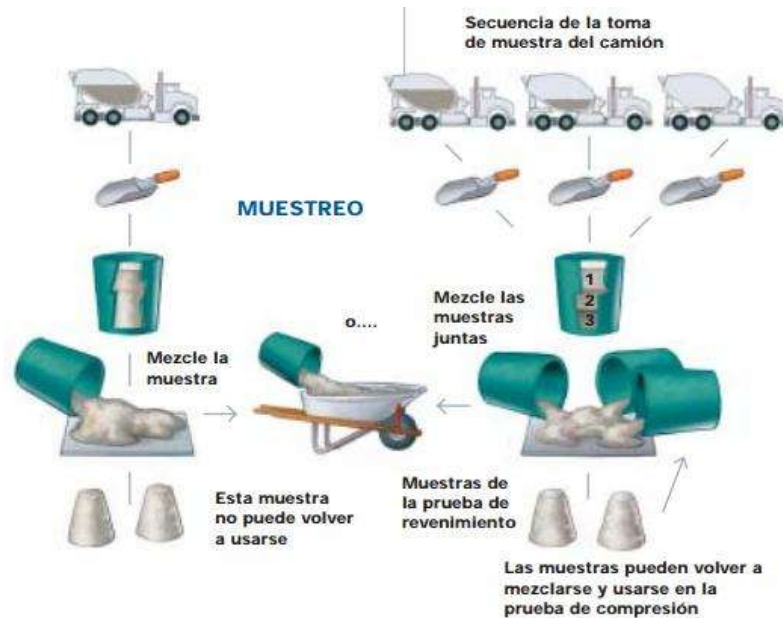
IMAGEN I – MUESTREO DEL CONCRETO FRESCO – (IMCYC)
