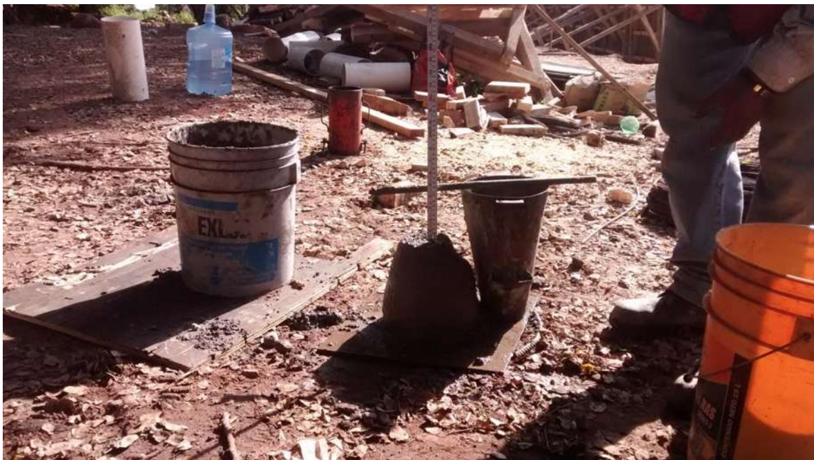
IMAGEN XVI (MEDICION DE LA DISTANCIA DE REVENIMIENTO)
