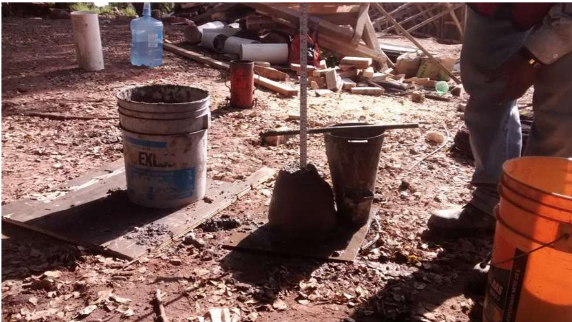
IMAGEN III - MEDICION DEL REVENIMIENTO
