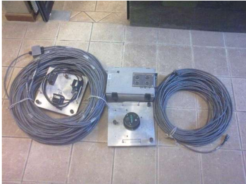
Figura 35 Equipo de medición K2 de Kinemetrics empleado en el estudio realizado.
