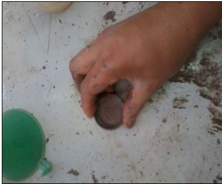
Figura 5.3.3.5.1. Golpeo del molde con el material contra una superficie dura.
