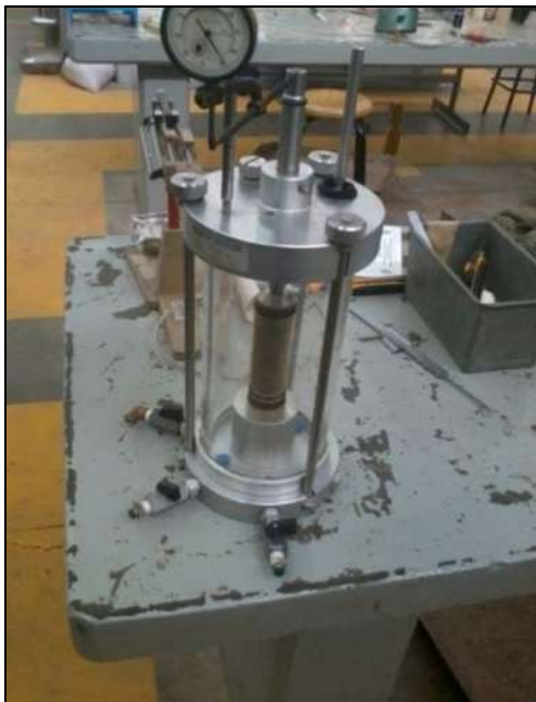
Figura 5.3.7.4, Primer espécimen en la cámara triaxial antes de la aplicación de la carga en la prensa.
