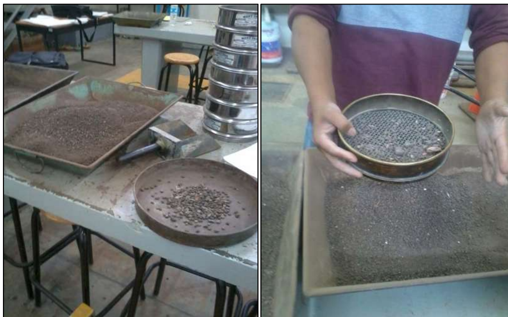
Figuras 5.3.2.3. Cribado del material retenido en la malla N° 4.
