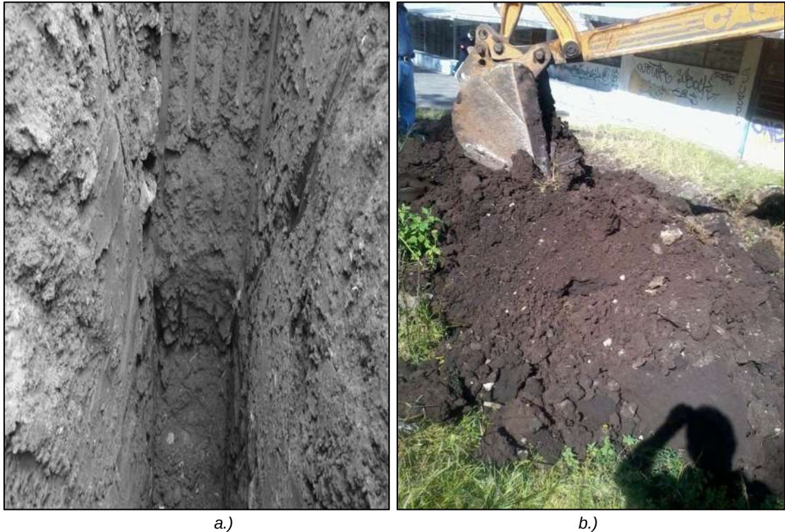
Figuras 5.2.2. PCA-1, 3.4 m de profundidad, formado principalmente por un suelo arcilloso negro con algunos fragmentos de ladrillo y fragmentos de roca andesíticas oxidados. a.) Profundidad del pozo. b.) Material extraído del pozo, en la superficie.
