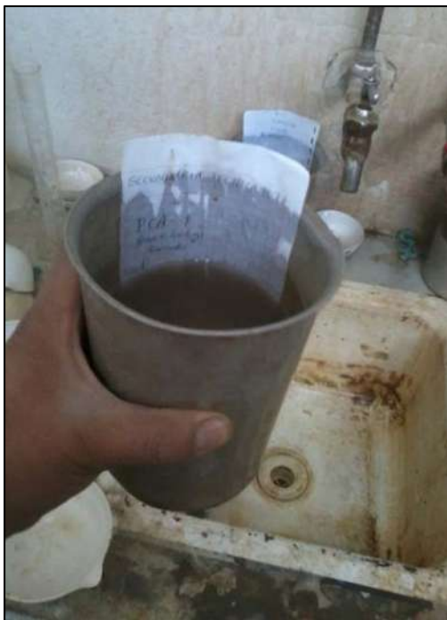
Figura 5.3.2.6. Material contenido en el vaso metálico saturado de 500 cm 3 de agua.
