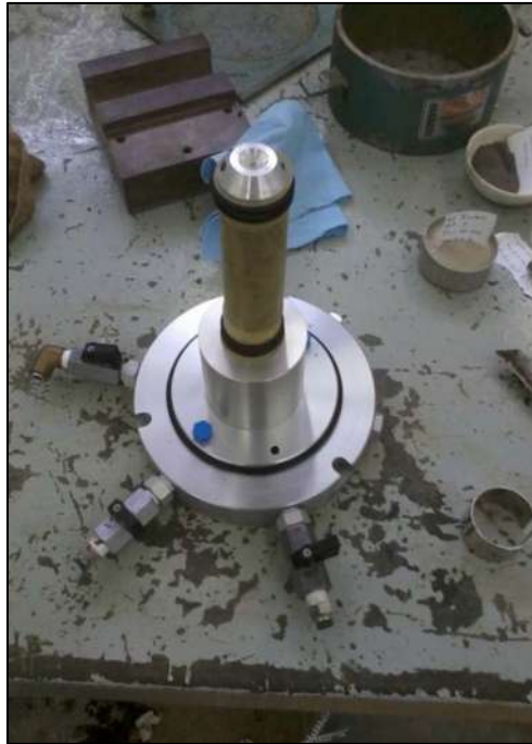
Figura 5.3.7.3. Primer espécimen, colocado en la base de la cámara triaxial y cubierto con una membrana de látex.
