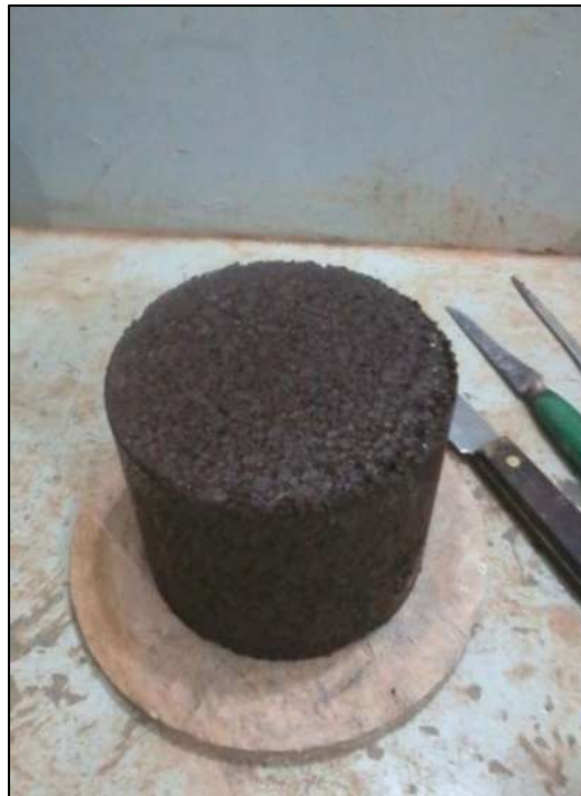
Figura 5.3.6.1, Muestra remoldeada a partir de material alterado.
