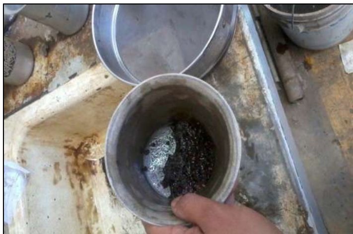
Figura 5.3.2.8. Material vaciado nuevamente al vaso metálico después del lavado.
