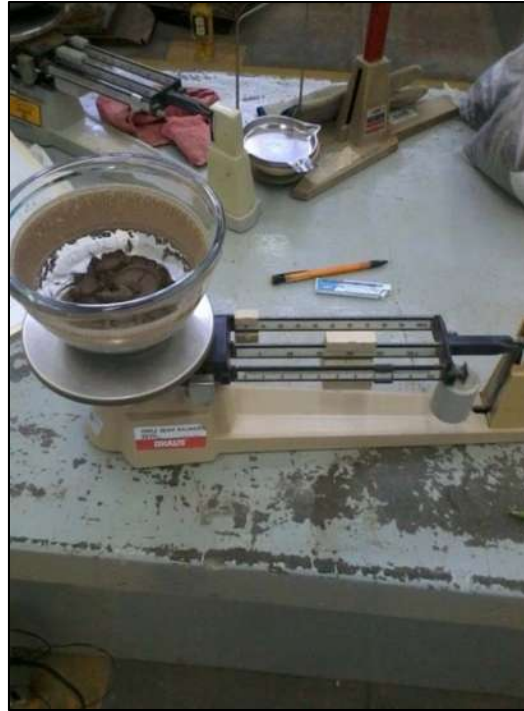
Figura 5.3.5.8, Determinación de la masa del material seco contenido en la capsula.
