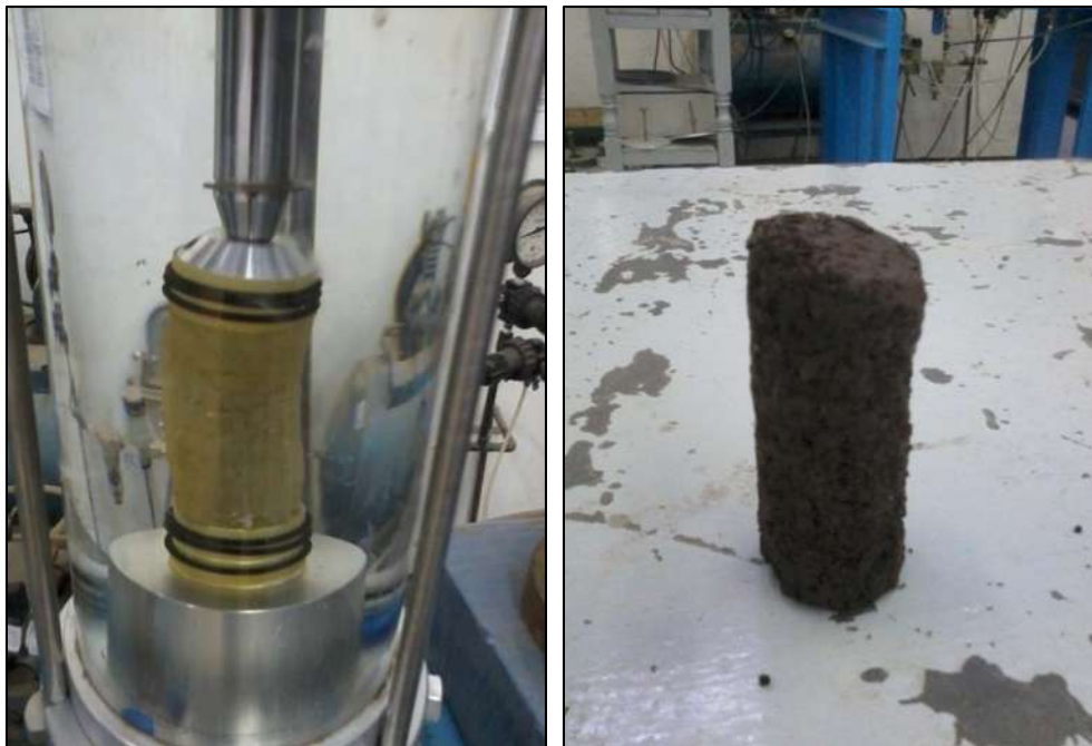
Figura 5.3.7.6 (izquierda). Momento de la aplicación de la carga al espécimen, el cual se observa que ya se estaba empezando a deformar; y Figura 5.3.7.7 (derecha). Especimen deformado después de la aplicación de la carga.
