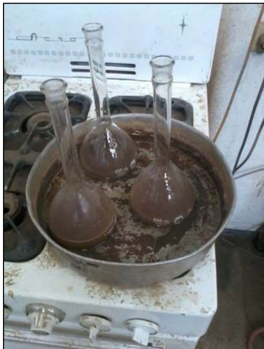
Figura 5.3.5.3, Colocación de los matraces en la charola con agua en ebullición.
