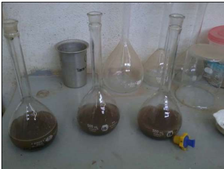
Figura 5.3.5.1, Los tres matraces con el material y agua destilada mezclados.
