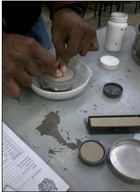
Figura 5.3.3.5.2. Inmersión de la pastilla de suelo en el mercurio para la determinación de su volumen.
