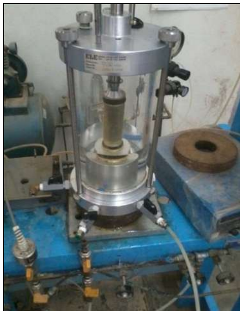
Figura 5.3.7.5. Introducción del agua en la cámara triaxial para la aplicación de presión de confinamiento.
