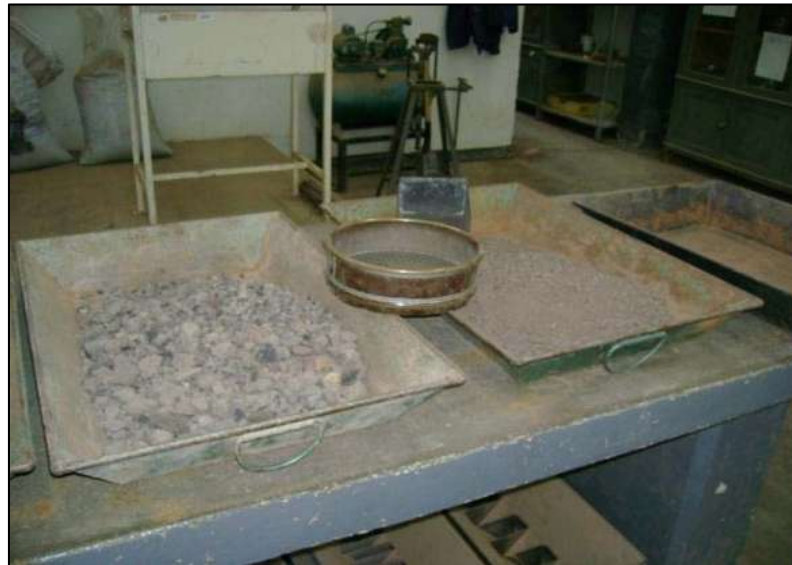
Figura 5.3.2.2. Cribado del material a través de la malla No. 4
