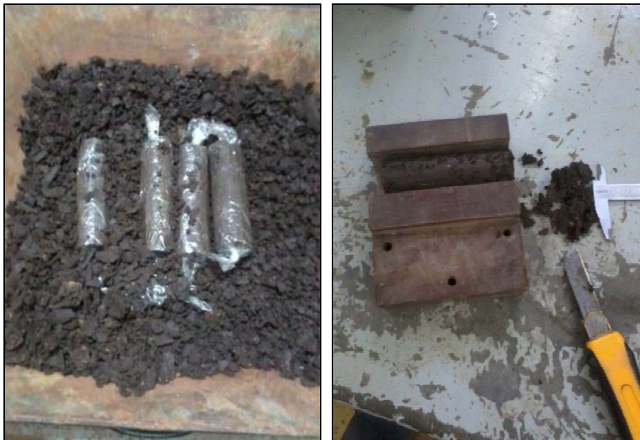
Figura 5.3.7.1 (izquierda). Especímenes cubiertos con hule; y Figura 5.3.7.2 (derecha). Primer espécimen cortado a la altura media.
