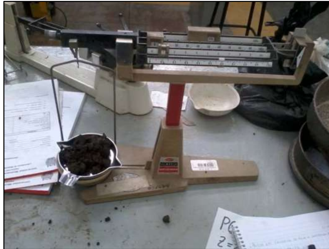
Figura 5.3.4.3, Determinación del peso del material de 100 gramos de cada uno de las muestras inalteradas.
