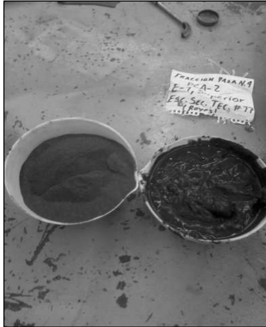
Figura 5.3.3.1.2. Colocación del material en la capsula de porcelana y saturación con agua.
