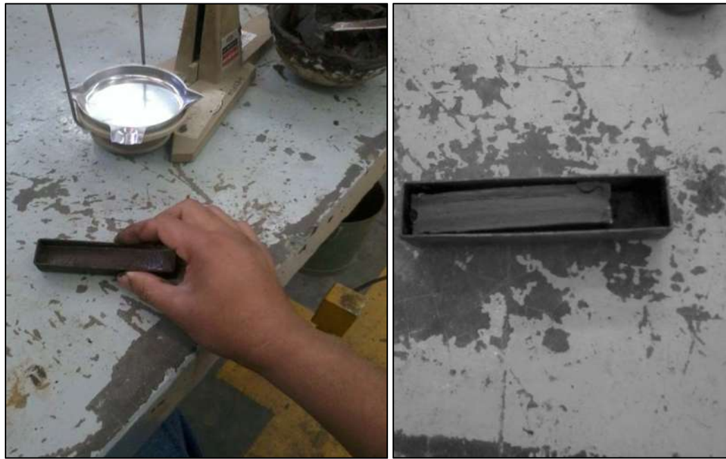
Figura 5.3.3.4.1 (izquierda). Golpeo del molde con el material en una superficie dura; y Figura 5.3.3.4.2 (derecha). Molde y espécimen después del secado en el horno.
