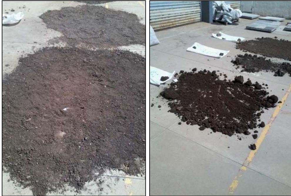
Figuras 5.3.1.1. Extendido, secado y disgregación de las muestras de materiales.
