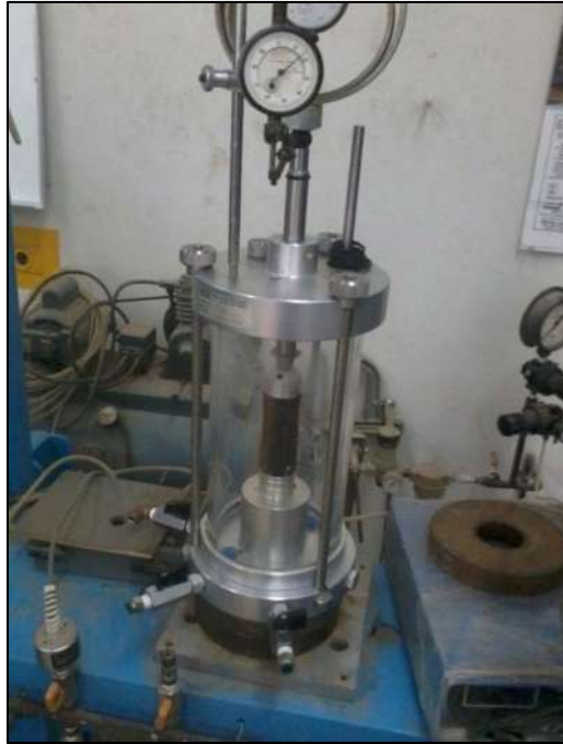
Figura 5.3.6.5, Aplicación de la carga al espécimen.
