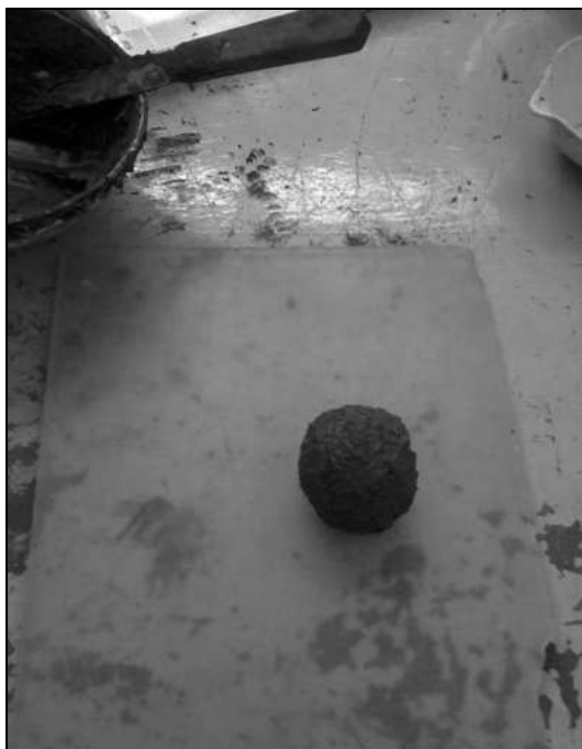
Figura 5.3.3.2.1, Formación de la esfera con diámetro aproximado de 15 mm.
