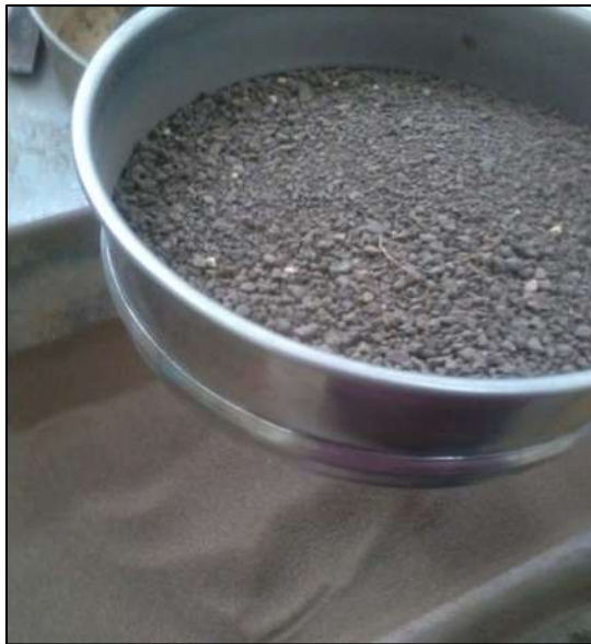
Figura 5.3.3.1.1. Cribado del material a través de la malla No. 40.
