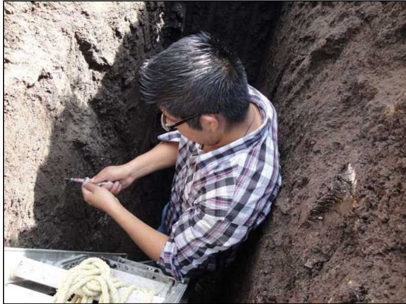
Figura 5.2.3. Pruebas de resistencia a la compresión y consistencia natural del terreno con el penetrómetro de bolsillo a diferentes profundidades, esto en el PCA-1.
