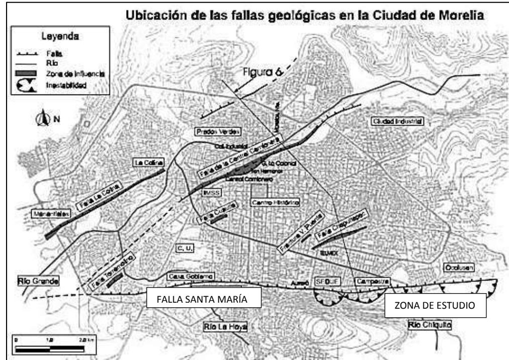
Figura 2.1.2.2. Plano de Morelia con las fallas geológicas ligadas a fenómenos de fluencia (Central Camionera, Chapultepec, Torremolino) y las Potencialmente Sísmicas (Santa María y La Colina). Sobresale la estrecha relación que existe entre las direcciones de las fallas de la ciudad de Morelia y las fallas regionales. Las partes sombreadas señalan la zona de influencia de las fallas. También se observan las coronas de la inestabilidad de taludes de la falla Santa María (Garduño et al. 2004)
