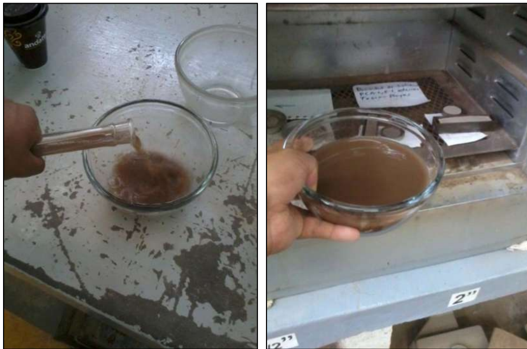
Figura 5.3.5.6 (izquierda). Vaciado de la suspensión en las cápsulas de evaporación; y Figura 5.3.5.7 (derecha). Introducción de las cápsulas de evaporación en el horno para el secado del material.
