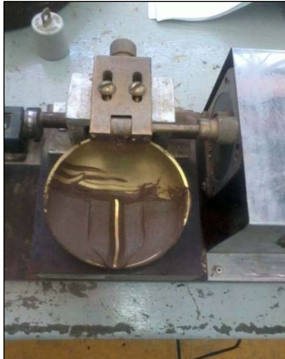
Figura 5.3.3.1.4. Colocación de la muestra de material en la copa y ranurado del material en la parte central.
