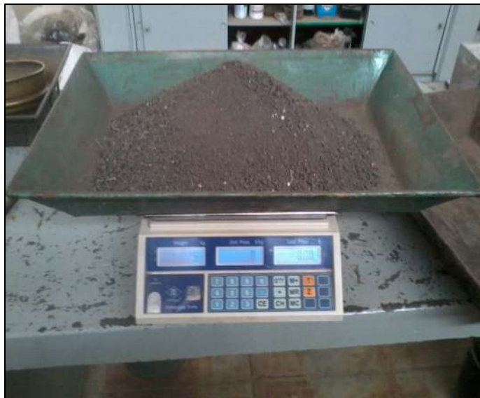
Figura 5.3.2.4. Forma como se pesó el material retenido en cada una de las mallas.
