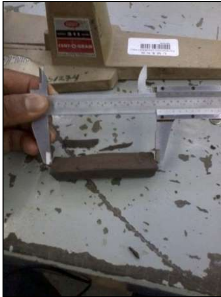
Figura 5.3.3.4.3. Medición de la longitud de la barra contraída y seca; posteriormente a esta medición también se midió el interior del molde, para el posterior cálculo de la contracción lineal.
