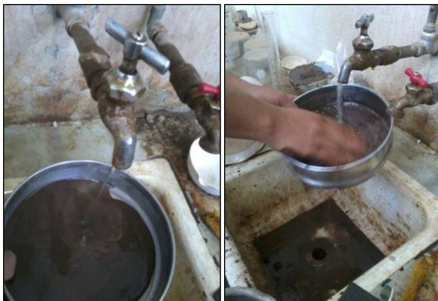
Figura 5.3.2.7. Lavado del material a través de la malla No. 200.
