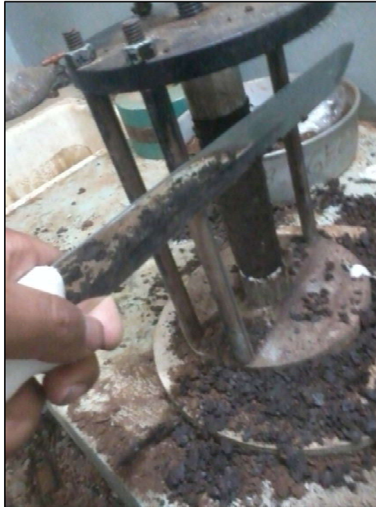
Figura 5.3.6.2, Labrado de los especímenes, a partir de la muestra remoldeada.
