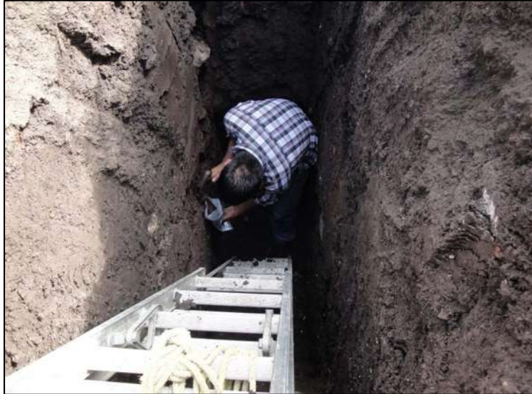
Figura 5.3.4.1, Obtención de las muestras inalteradas en el sitio de estudio y depositadas en bolsas de plástico.
