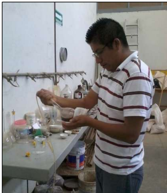
Figura 5.3.5.2, Aplicación de la succión al matraz para la extracción del aire atrapado en el material.
