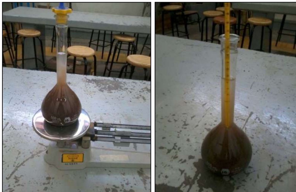
Figura 5.3.5.4 (izquierda). Matraz después del llenado con agua destilada y su pesado; y Figura 5.3.5.5 (derecha). Forma de cómo se llevó a cabo la toma de temperatura de la suspensión.
