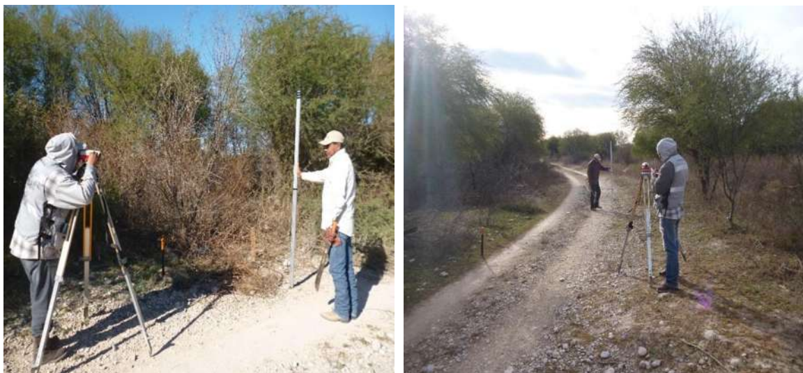
Imagen III.7: Nivelación de eje de apoyo.
