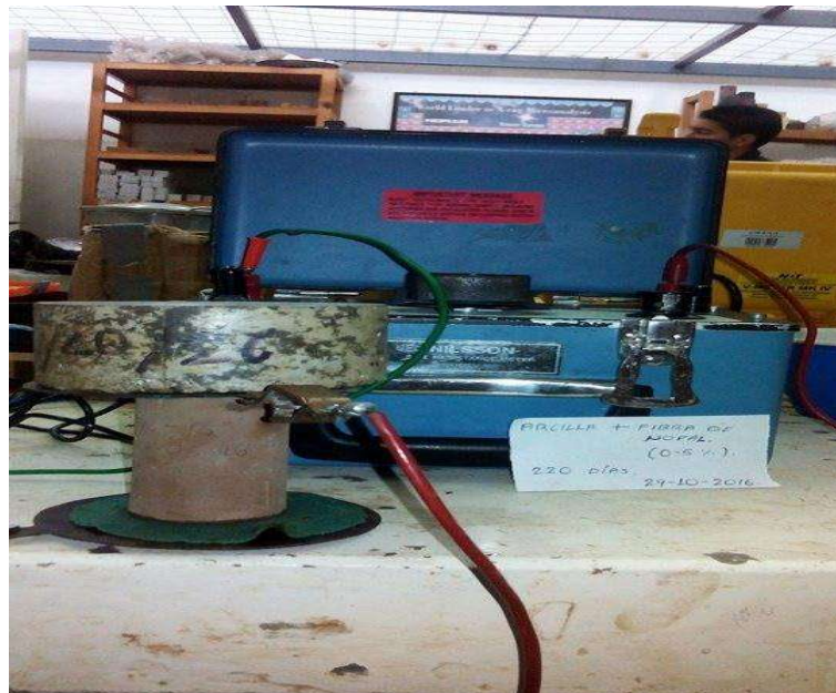
Ilustración 36: prueba de Resistividad eléctrica, (Ambrocio, 2016)
