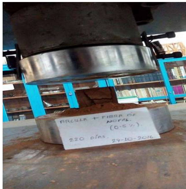
Ilustración 38: Prueba a compresión simple en especímenes cúbicos, (Ambrocio, 2016)
