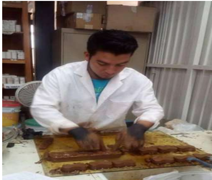
Ilustración 33: Elaboración de briquetas, (De Leon Ambrocio, 2017)
