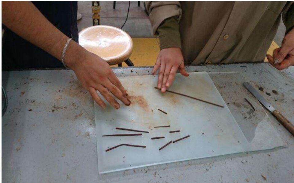
Ilustración 28: Elaboración de cilindros del material en la determinación del límite plástico, (Ambrocio, 2016)
