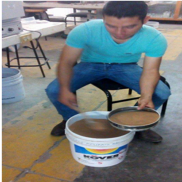
Ilustración 25: homogenización del material, (De Leon Ambrocio, 2016)
