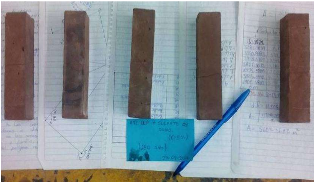
Ilustración 42: Especímenes prismáticos probados a tensión por flexión por edad y por mezcla, (De Leon Ambrocio, 2016)
