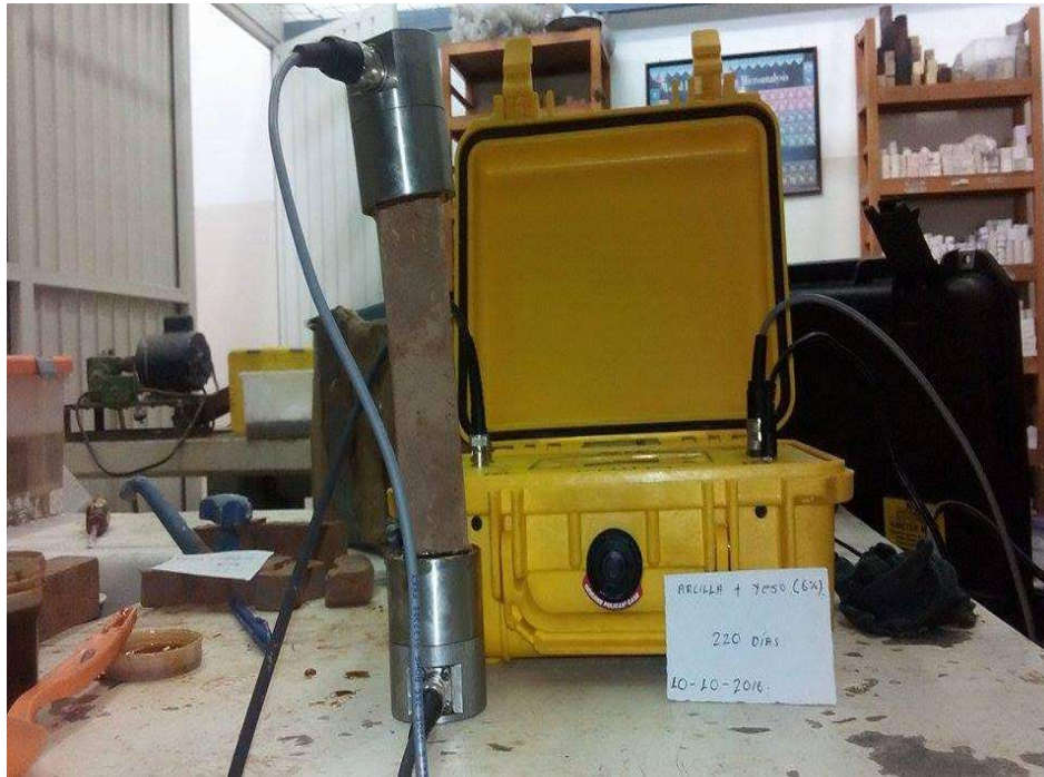
Ilustración 37: Prueba de Velocidad de Pulso Ultrasonico, (Ambrocio, 2016)
