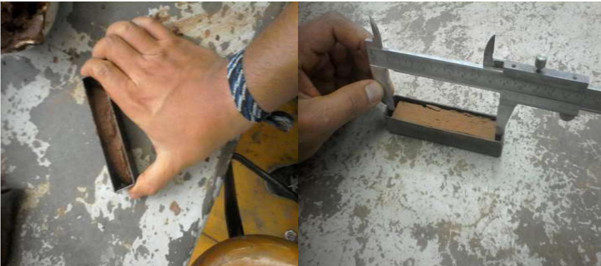
Ilustración 30: Llenado de cápsula para obtención de la contracción lineal y medición final de la muestra seca que determinación la contracción del material. (Ambrocio, 2016)
