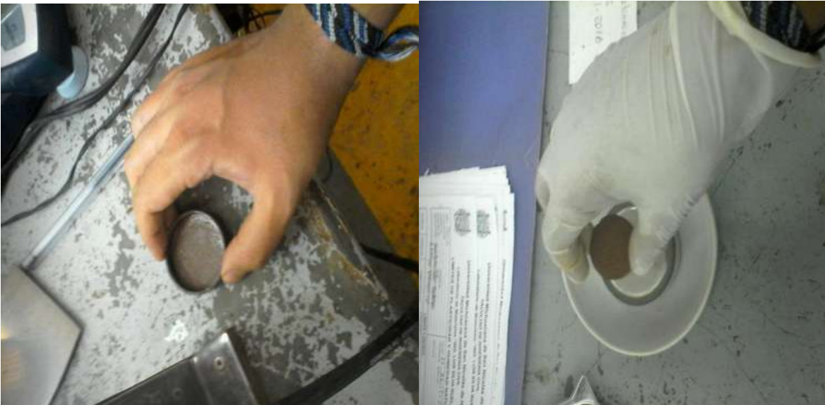
Ilustración 29: Llenado de la cápsula para la obtención de contracción volumétrica, y sumergido de la muestra seca en el mercurio para la obtención de su densidad. (Ambrocio, 2016)
