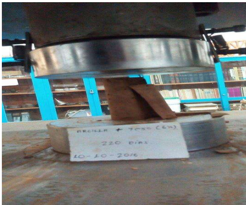
Ilustración 40: Prueba de compresión simple en cilindros, (De León Ambrocio, 2016)
