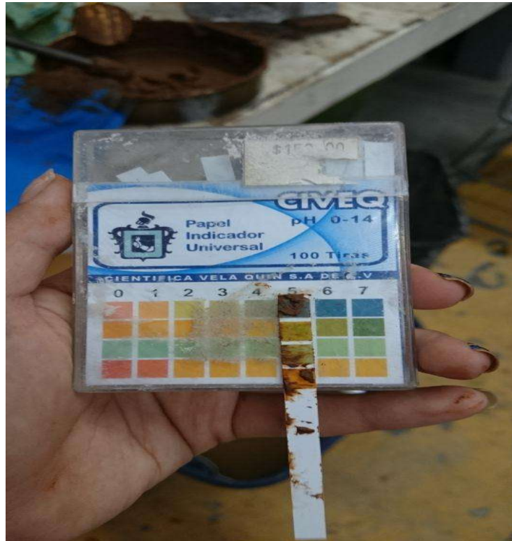
Ilustración 31: Determinación del potencial de hidrogeno (PH) con tiras reactivas, (De Leon Ambrocio, 2016)
