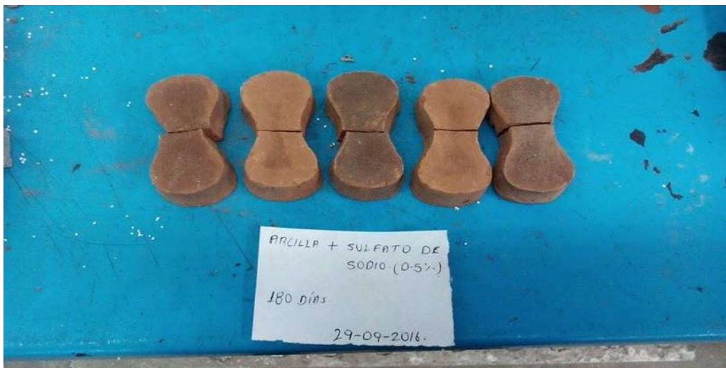
Ilustración 44: Muestras probadas por edad y mezcla a Tensión Directa, (De Leon Ambrocio, 2016)
