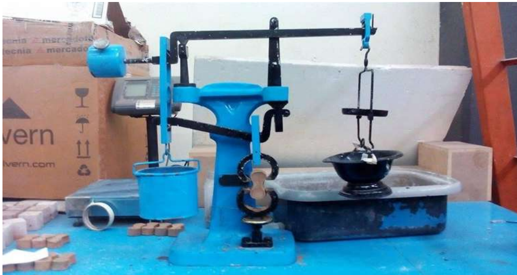
Ilustración 43: Colocación de briqueta en la máquina, para llevar a cabo la prueba de Tensión Directa, (De Leon Ambrocio, 2016)
