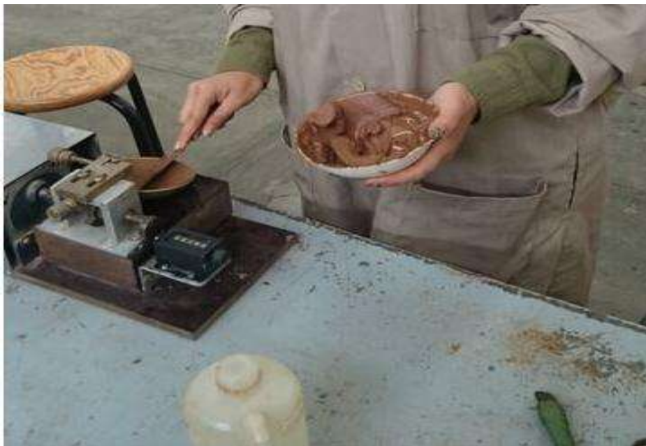
Ilustración 26: Colocación del material en la copa de Casagrande, (Ambrocio, 2016)
