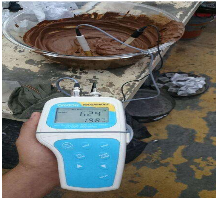
Ilustración 32: Determinación del potencial de Hidrogeno (PH) con PHmetro, (De Leon Ambrocio, 2016)
