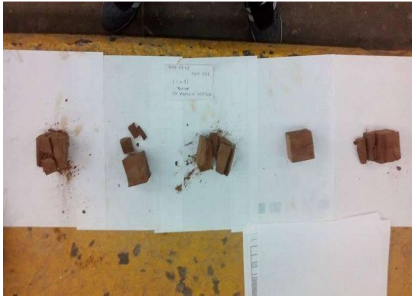
Ilustración 39: Especímenes probados por edad y por mezcla, (De León Ambrocio, 2016):
