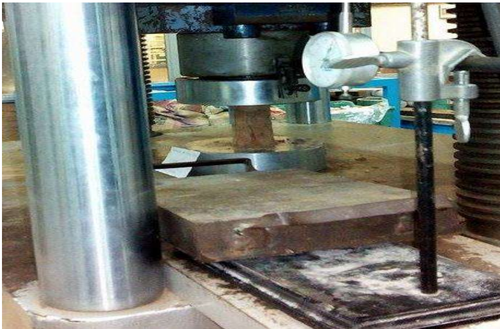
Ilustración 45: Determinación de Esfuerzo-Deformación en los cilindros, (De Leon Ambrocio, 2017)
