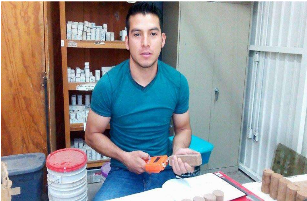
Ilustración 35: Obtención del porcentaje de humedad de los especímenes, (De Leon Ambrocio, 2016)
