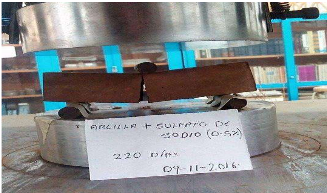
Ilustración 41: Prueba de tensión por flexión en especímenes prismáticos, (De León Ambrocio, 2016)
