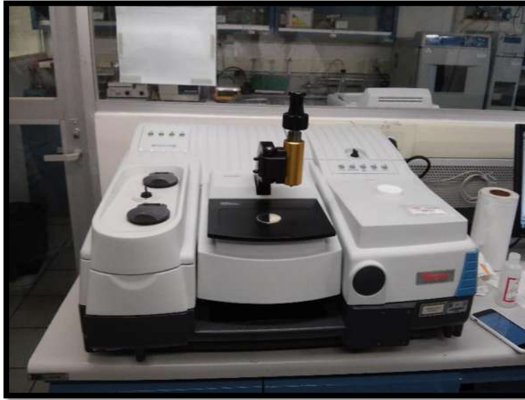
Figura 31. Espectrómetro Thermo Nicolet 6700 FT-IR.
