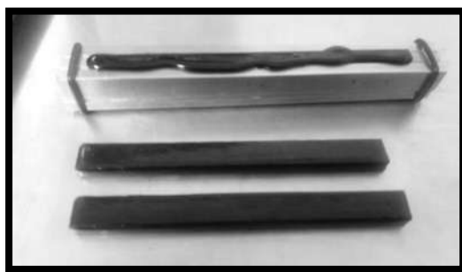
Figura 30. Molde y Viga para el ensayo de BBR.
