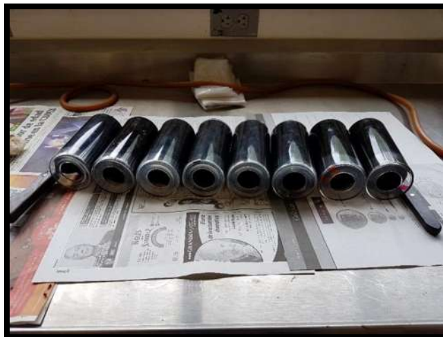
Figura 26. Contenedores con asfalto para el ensayo en el RTFO.
