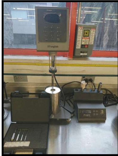
Figura 24. Viscosímetro Rotacional, marca Fungilab.
