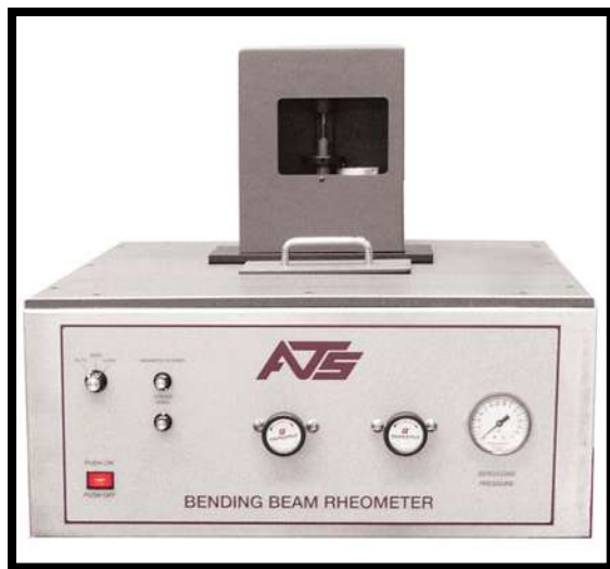
Figura 29. Reómetro de Viga a Flexión (BBR), compañía Applied Test Systems Inc.
