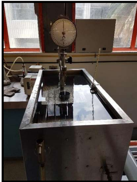
Figura 22. Penetrómetro Universal utilizado para el asfalto.
