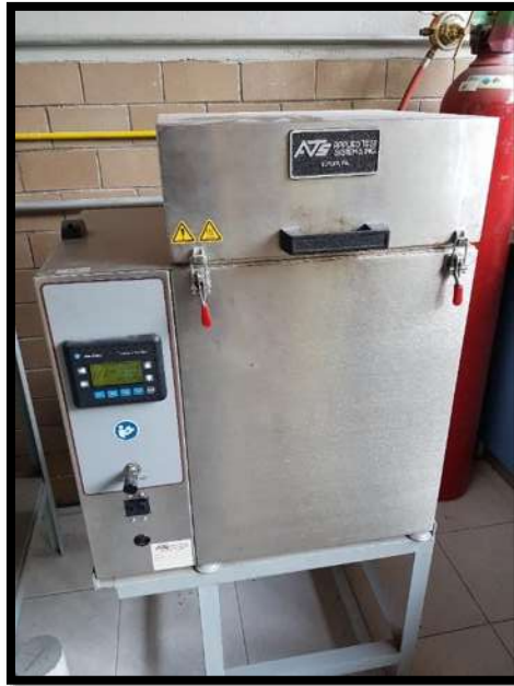
Figura 27. Vasija de Envejecimiento a Presión (PAV), compañía Applied Test Systems Inc.
