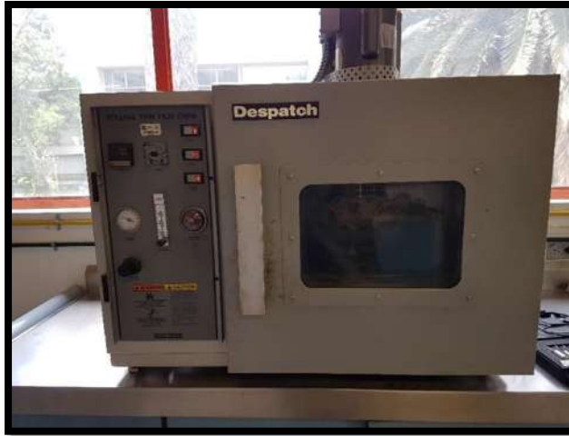
Figura 25. Horno Rotatorio de Película Delgada (RTFO), Despatch.
