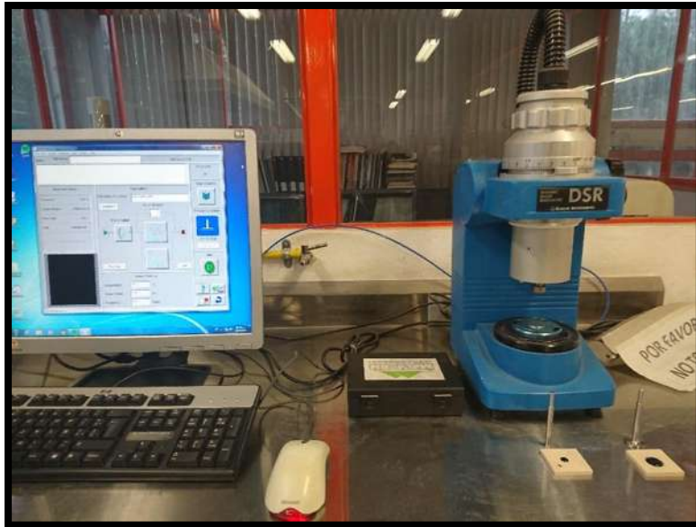
Figura 21. Reómetro de Corte Dinámico (DSR), Bohlin Instruments.
