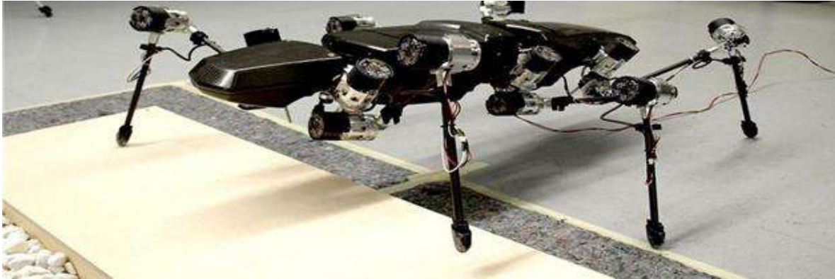
Figura 78. Héctor : robot simulando un insecto palo.
