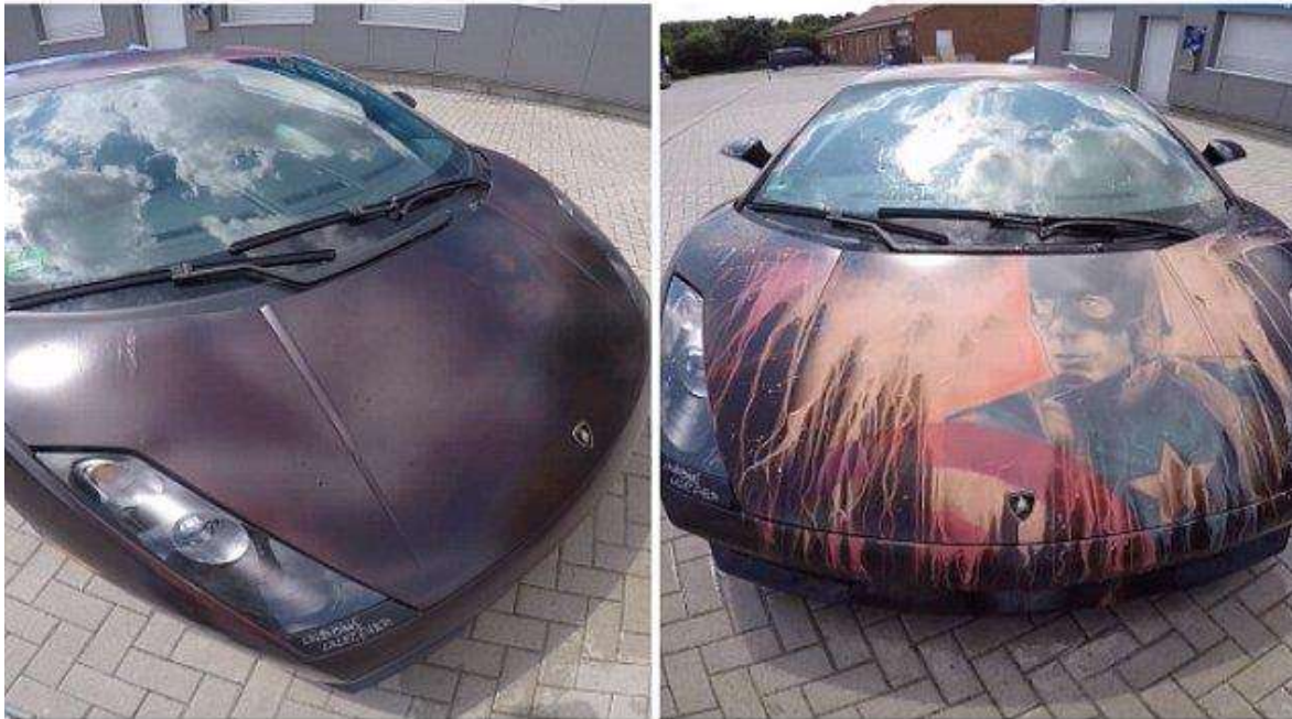
Figura 79. Automóvil Lamborghini Gallardo con pintura termocrómica.
