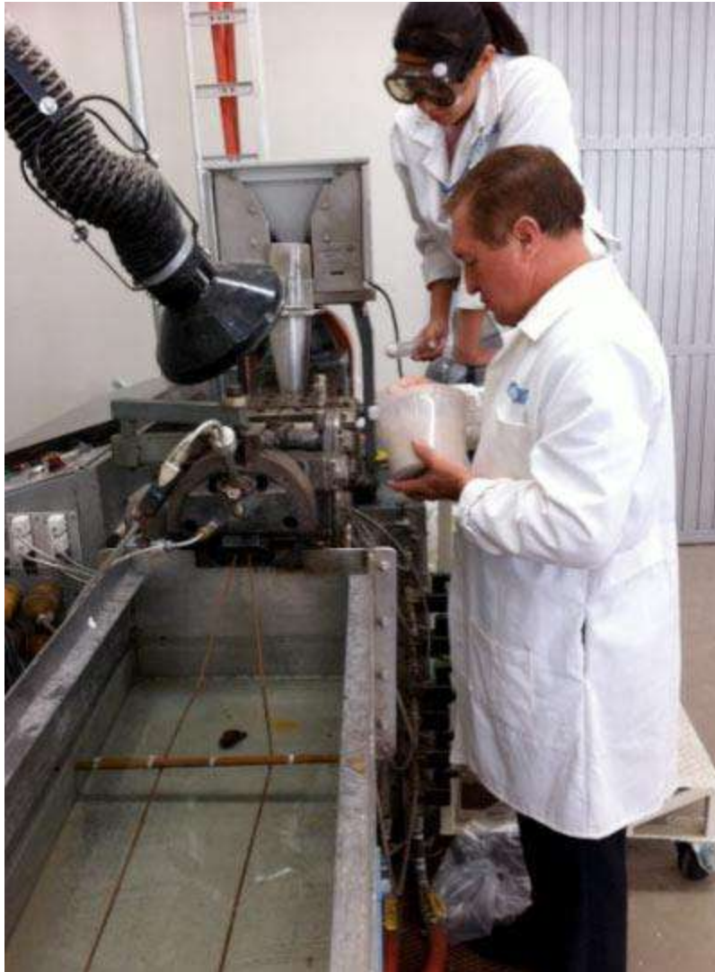
Figura 46. Creación de hilos de bioplástico de agave en la empresa Biosolutions .
