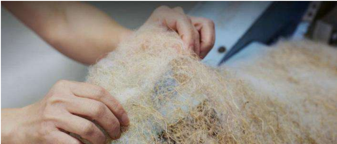
Figura 28. Fibra de agave seca para construcción de muros ecológicos.
