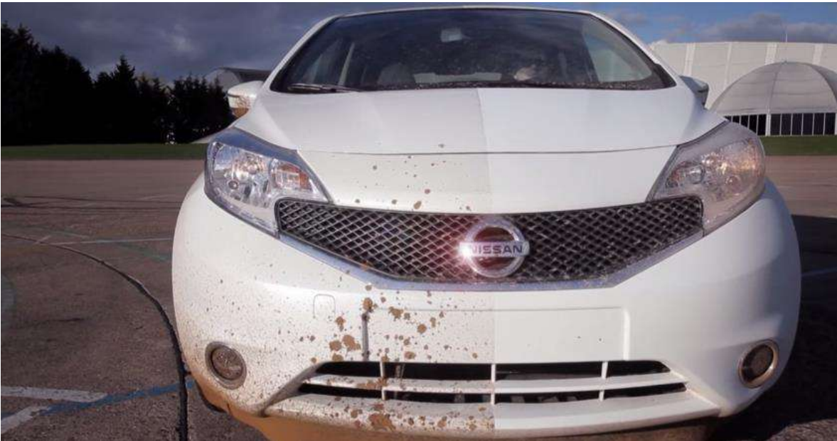
Figura 67. Automóvil de lujo de la marca Nissan con pintura Ultra Ever Dry, con impurezas fácilmente eliminables.
