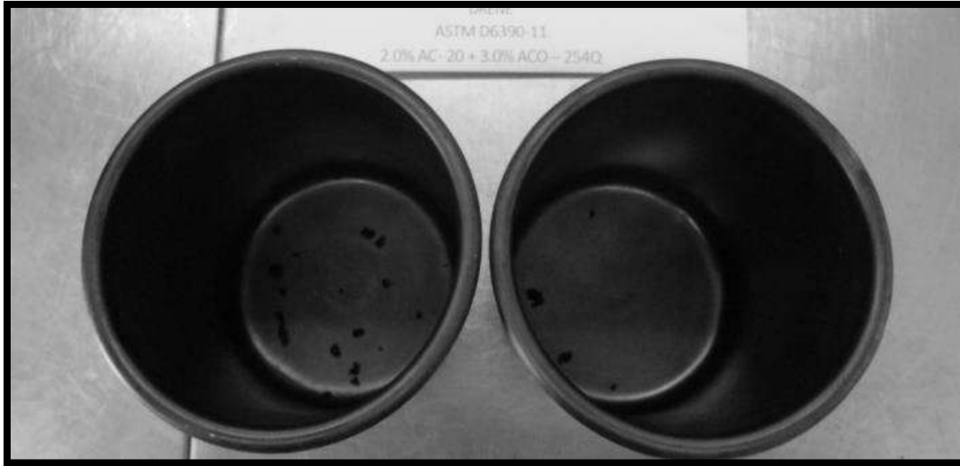
Figura 61. Resultado de la prueba al pre diseño 2, 10 °C arriba de la temperatura de premezclado.
