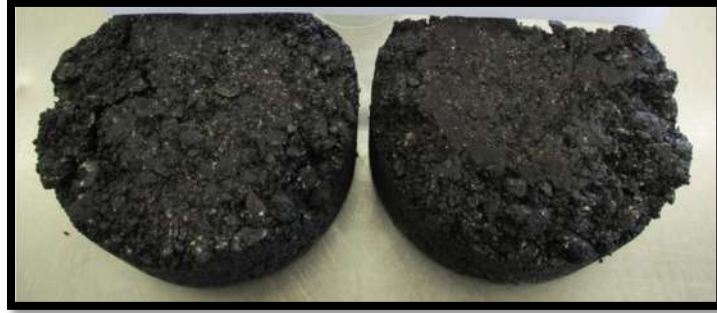
Figura 63. Prueba de raveling a la mezcla densa.
