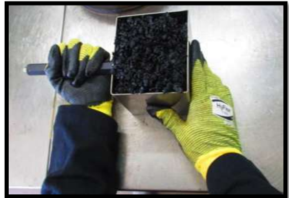
Figura 47. Prueba de trabajabilidad
