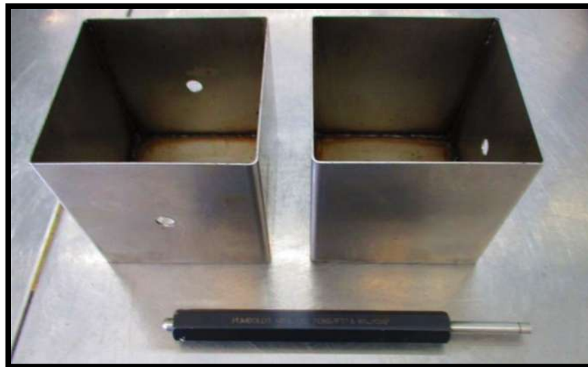
Figura 45. Cajas y penetrómetro para la prueba de trabajabilidad.
