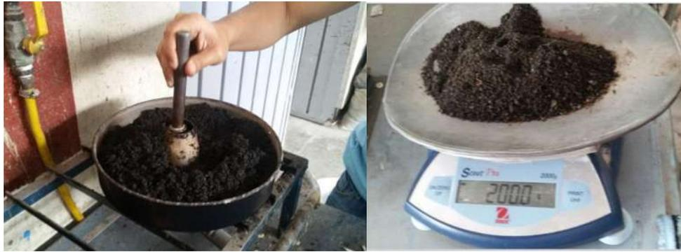
Ilustración 9-4 En la izquierda se muestra la comprobación del secado superficial de la arena por medio del molde troncocónico, en la derecha se tomó la masa del material para realizar la prueba (López Reyes S.)
