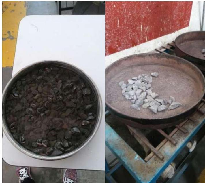
Ilustración 9-5 Material saturado a 24 horas y seco superficialmente (López Reyes S).
