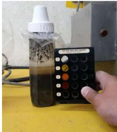
*Ilustración 9-10 Comparación del color del sedimento con la tabla colorimétrica (López Reyes S.).*
