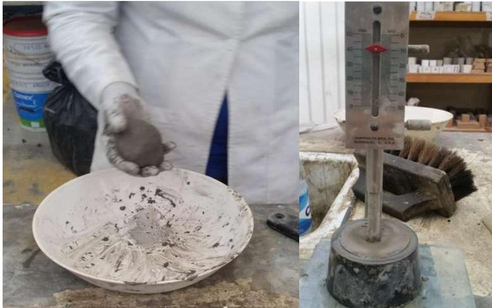
*Ilustración 9-13 En la izquierda se muestra la formación de la esfera y en la derecha la penetración de la aguja (López Reyes S.).*
