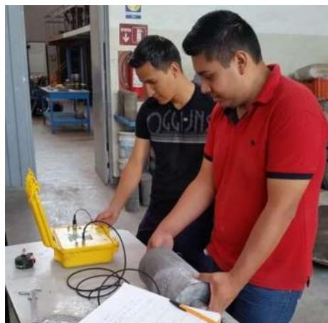
*Ilustración 9-22 Prueba de velocidad de pulso ultrasónico (López Reyes S.).*
