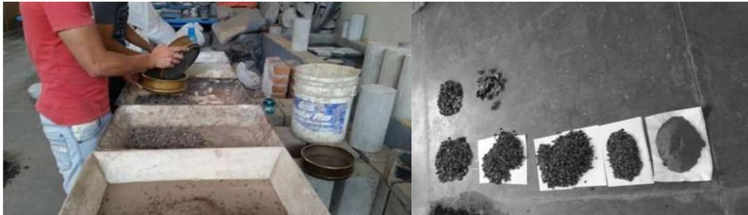
*Ilustración 9-9 Granulometría en gravas mediante las mallas (López Reyes S.).*
