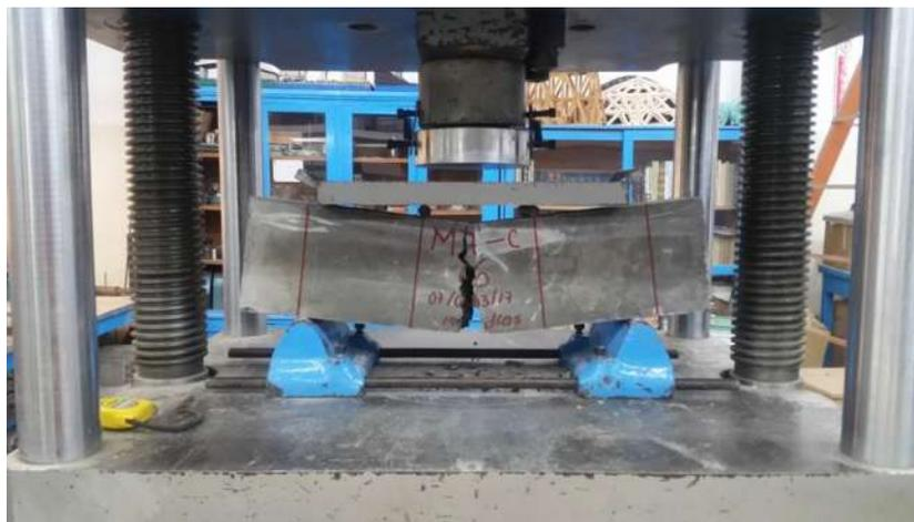
Ilustración 9-21 Prueba de flexión en vigas (López Reyes S.).
