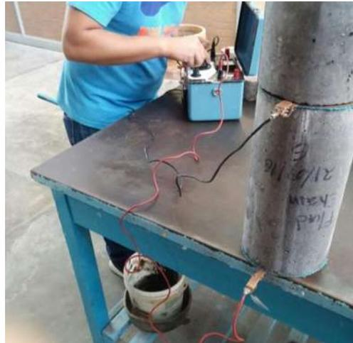
Ilustración 9-23 Prueba de resistividad eléctrica (López Reyes S.).
