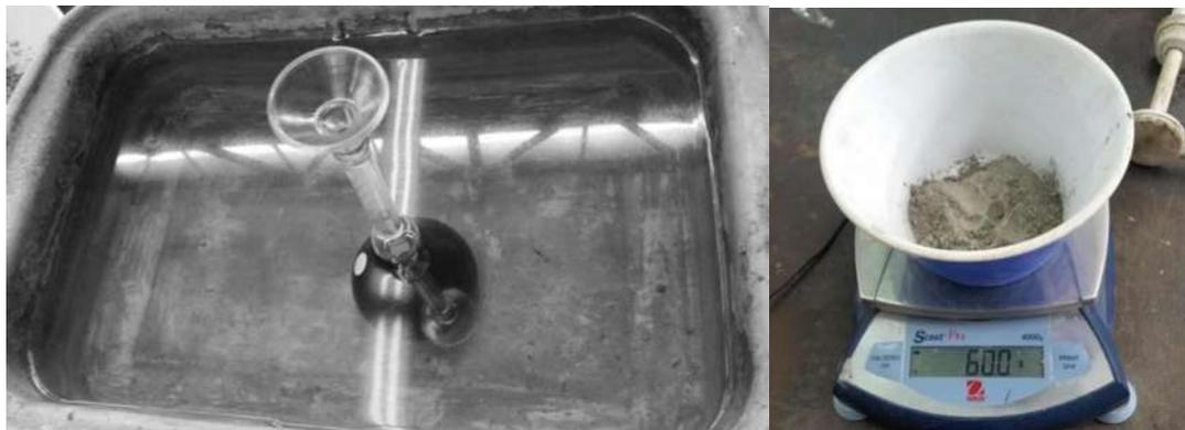
*Ilustración 9-15 Frasco Le Chatelier sumergido en agua y muestra de cemento para la prueba (López Reyes S.).*
