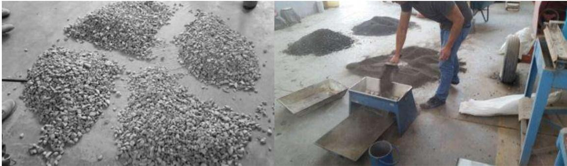
*Ilustración 9-1 cuarteo de grava mediante pala, y de arena por divisor de muestras (Martinez Balvanera, 2017)*
