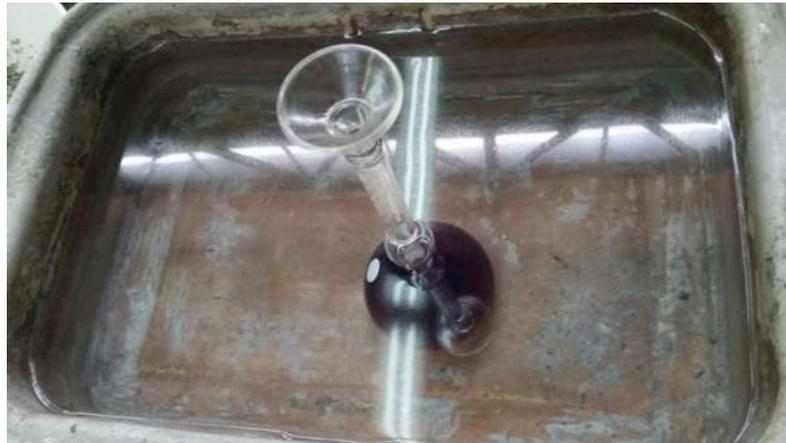
Ilustración 6-2 Determinación de la densidad. (Martinez Balvanera, 2017)
