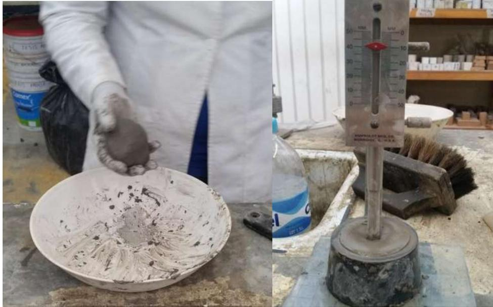
*Ilustración 9-14 Realización de una mezcla normalizada (Martinez Balvanera, 2017).*
