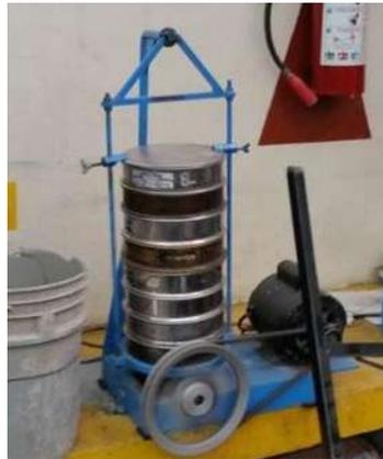
*Ilustración 9-7 Equipo "Raf-Tap" utilizado para granulometría en arenas (Martinez Balvanera, 2017).*
