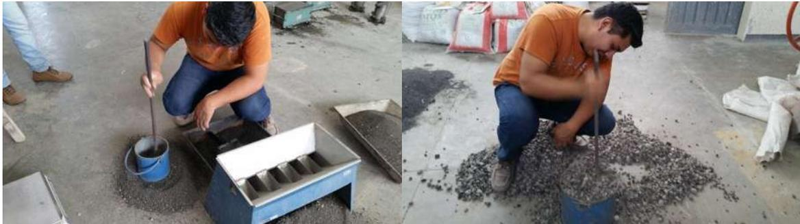
*Ilustración 9-6 Determinación de la masa volumétrica seca varillada de arena y grava (Martinez Balvanera, 2017)*
