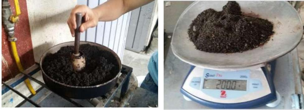
*Ilustración 9-3 En la izquierda se observa la comprobación del secado superficial de la arena por medio del molde troncocónico, en la derecha se tomó la masa del material para realizar la prueba.*
