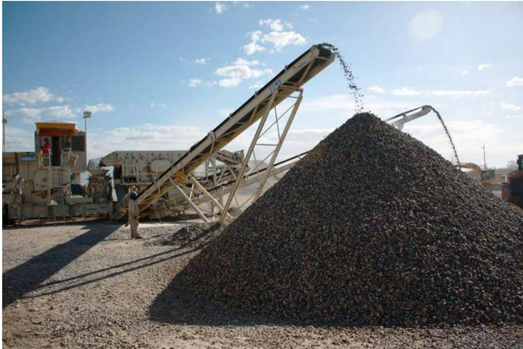
*Ilustración 6-6 Agregado natural triturado mecánicamente (La macuira, 2017)*
