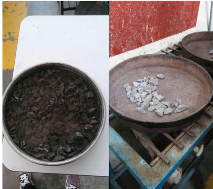
*Ilustración 9-4 Izquierda: saturación del material, previo al secado.
