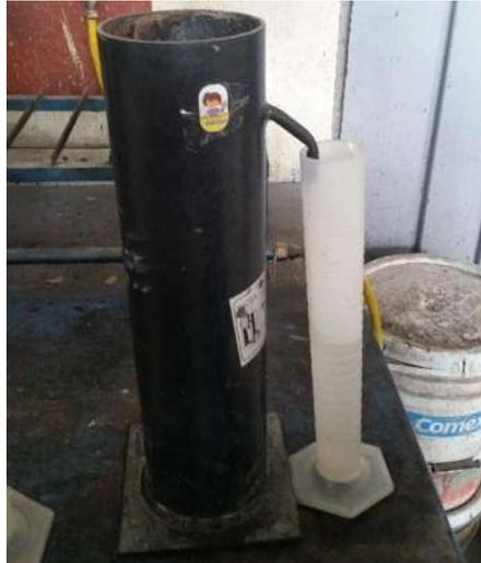
*Ilustración 9-12 Determinación de la densidad en gravas*
