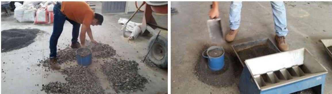
*Ilustración 9-5 En la izquierda se aprecia el llenado del molde con grava, en la izquierda se observa el llenado con grava (Martinez Balvanera, 2017)*
