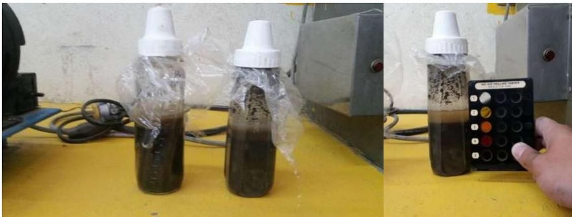
*Ilustración 9-9 Determinación de colorimetría en una muestra de arena (Martínez Balvanera, 2017)*
