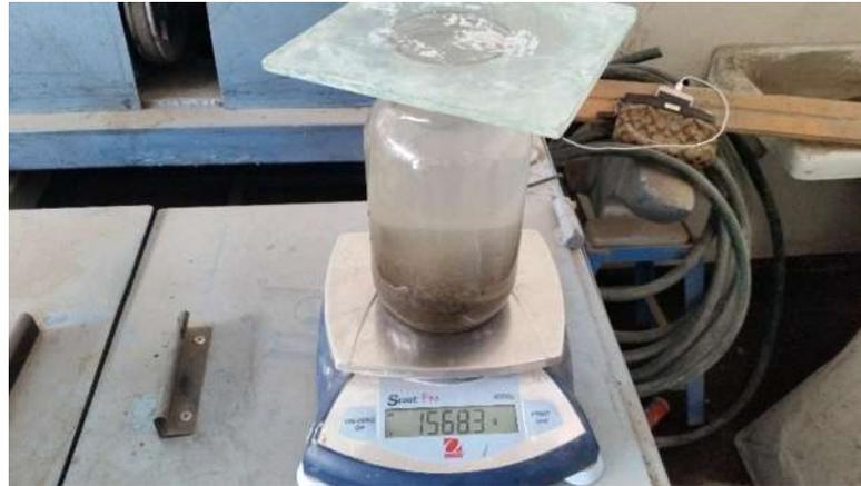
*Ilustración 9-11 Determinación de densidad en arena*
