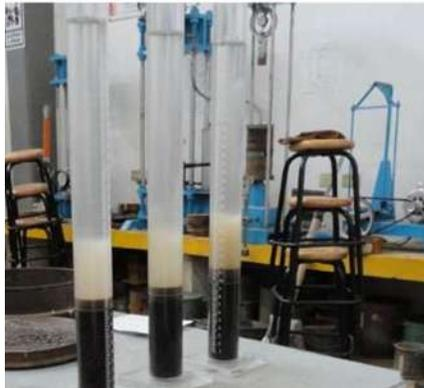
*Ilustración 9-13 muestras en reposo para obtener equivalente de arena (Martinez Balvanera, 2017).*
