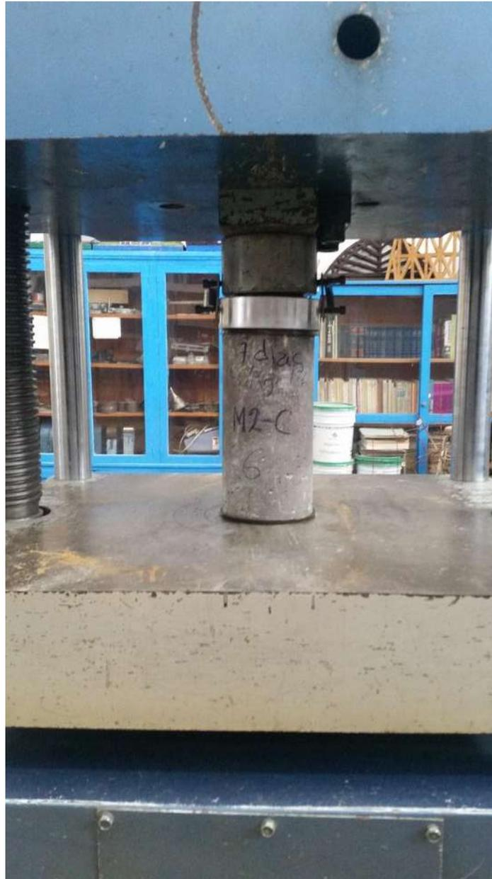
*Ilustración 9-18 "Prueba de compresión"*
