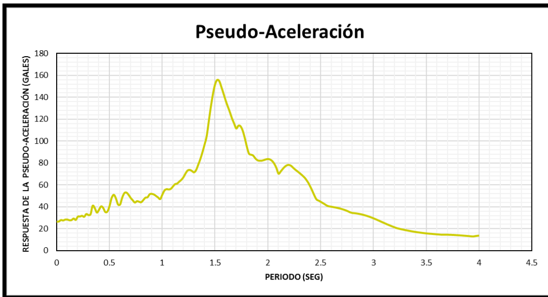
Figura 89 Espectro de respuesta de pseudo-aceleración correspondientes al sismo del 14 de septiembre de 1995 (dirección longitudinal)
