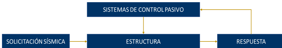
Figura 18 Funcionamiento de sistemas pasivos
