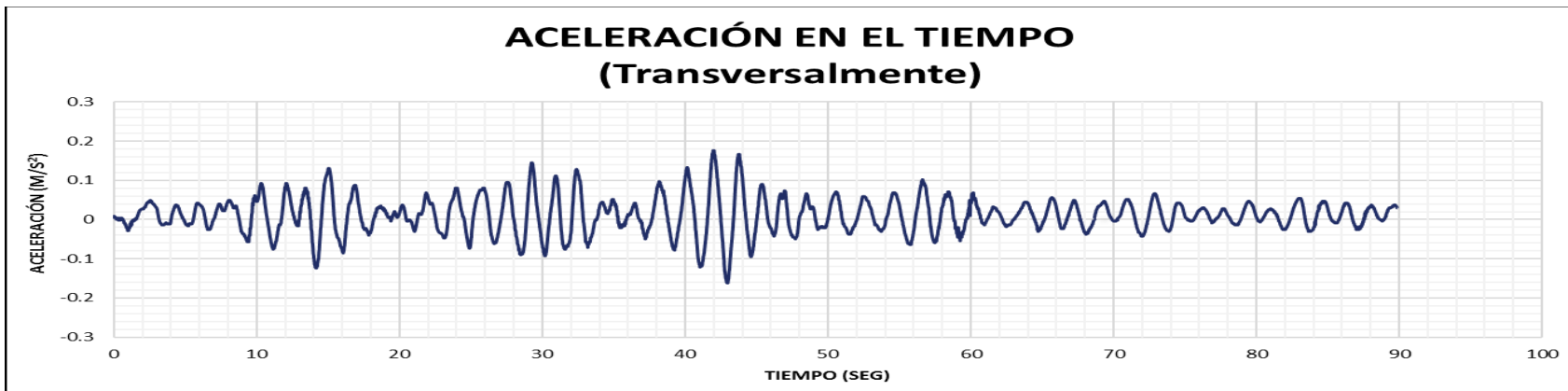
Figura 80 Registro de acelerograma, correspondiente al sismo del 22 de enero de 2003 (dirección transversal)
