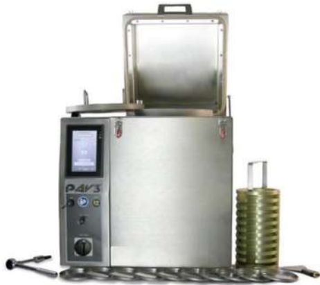
Figura 25.- Vasija de envejecimiento a presión (PAV). Fuente: Proetisa
