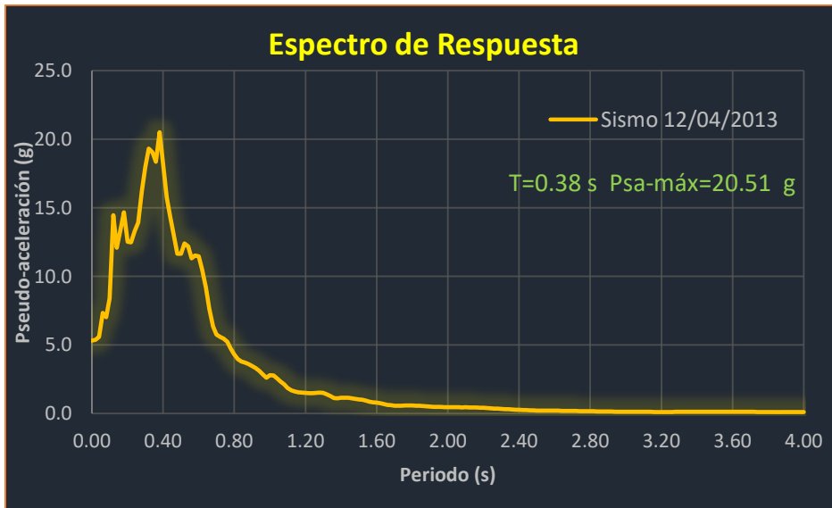
Figura 78. Espectro de respuesta de pseudoaceleración del sismo 12/04/2013.
