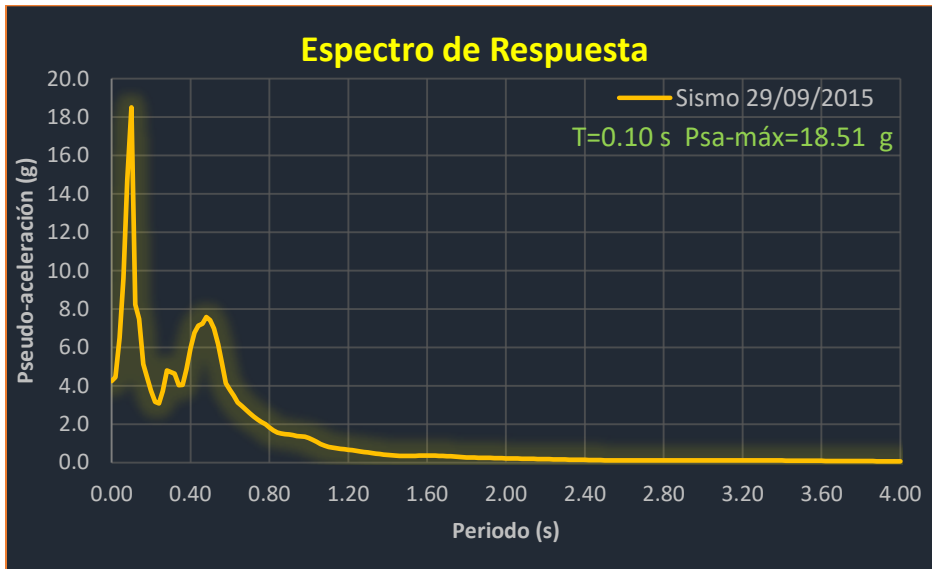
Figura 80. Espectro de respuesta de pseudoaceleración del sismo 29/09/2015.
