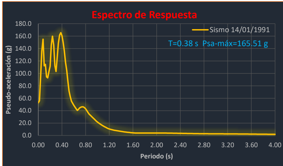
Figura 24. Espectro de respuesta de pseudoaceleración del sismo 14/01/1991.
