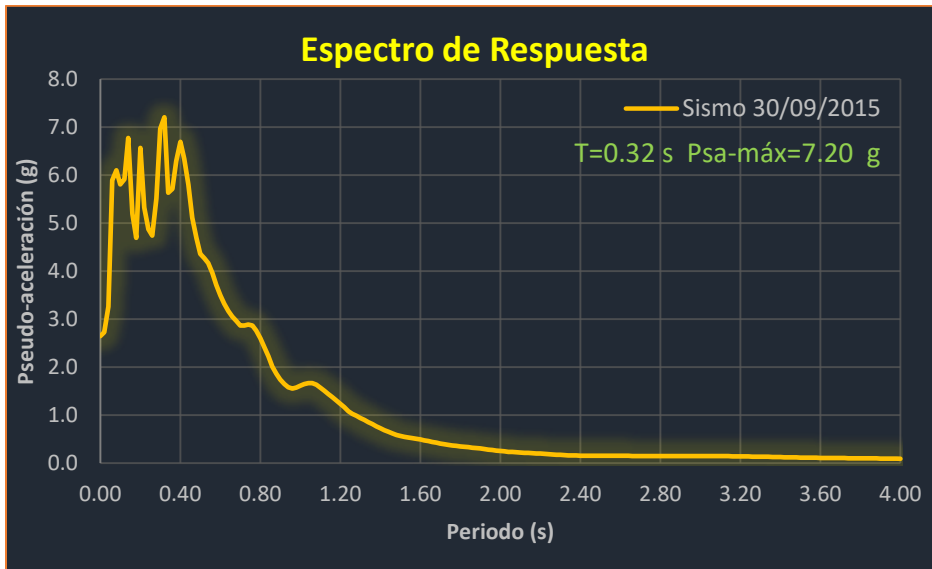
Figura 82. Espectro de respuesta de pseudoaceleración del sismo 30/09/2015.
