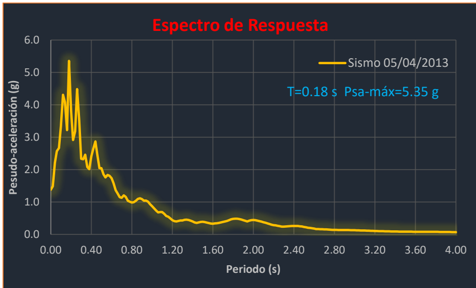
Figura 34. Espectro de respuesta de pseudoaceleración del sismo 05/04/2013.
