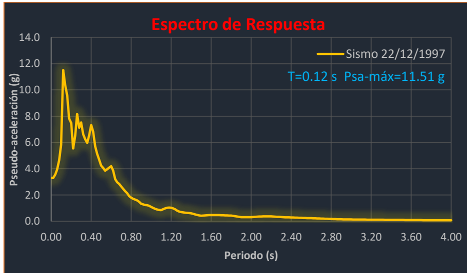
Figura 26. Espectro de respuesta de pseudoaceleración del sismo 22/12/1997.
