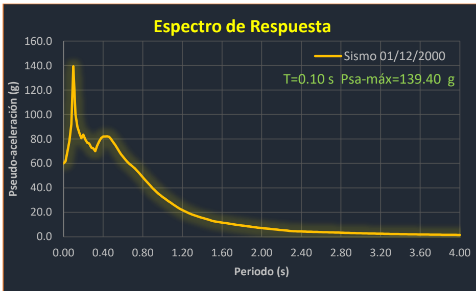
Figura 68. Espectro de respuesta de pseudoaceleración del sismo 01/12/2000.
