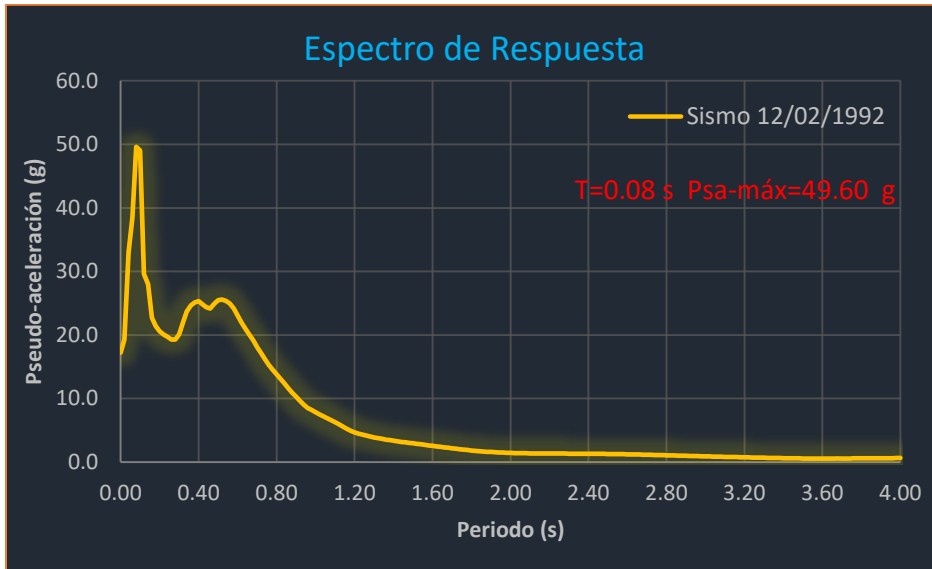
Figura 48. Espectro de respuesta de pseudoaceleración del sismo 12/02/1992.
