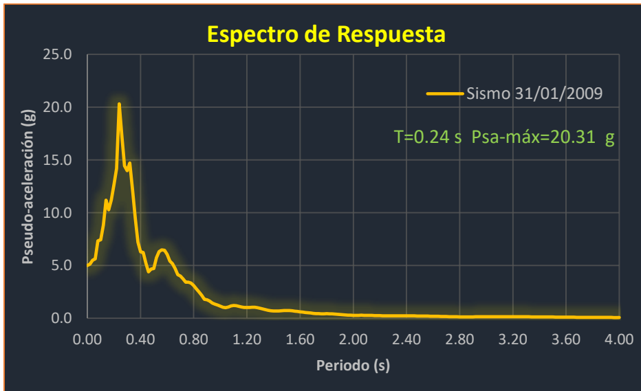
Figura 74. Espectro de respuesta de pseudoaceleración del sismo 31/01/2009.
