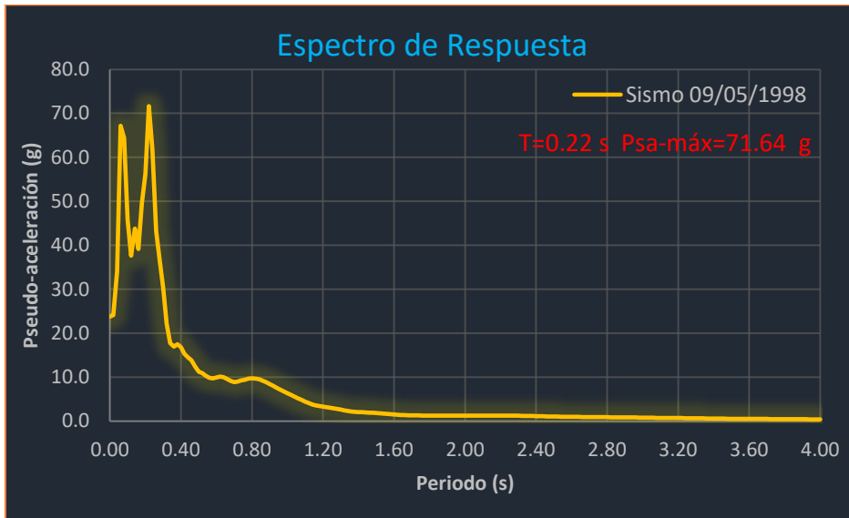
Figura 52. Espectro de respuesta de pseudoaceleración del sismo 09/05/1998.
