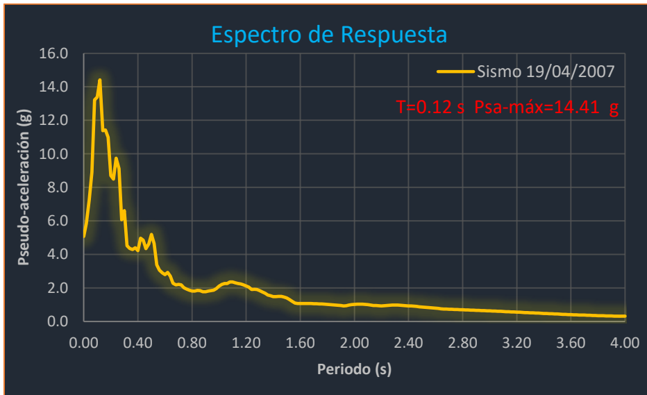
Figura 58. Espectro de respuesta de pseudoaceleración del sismo 19/04/2007.
