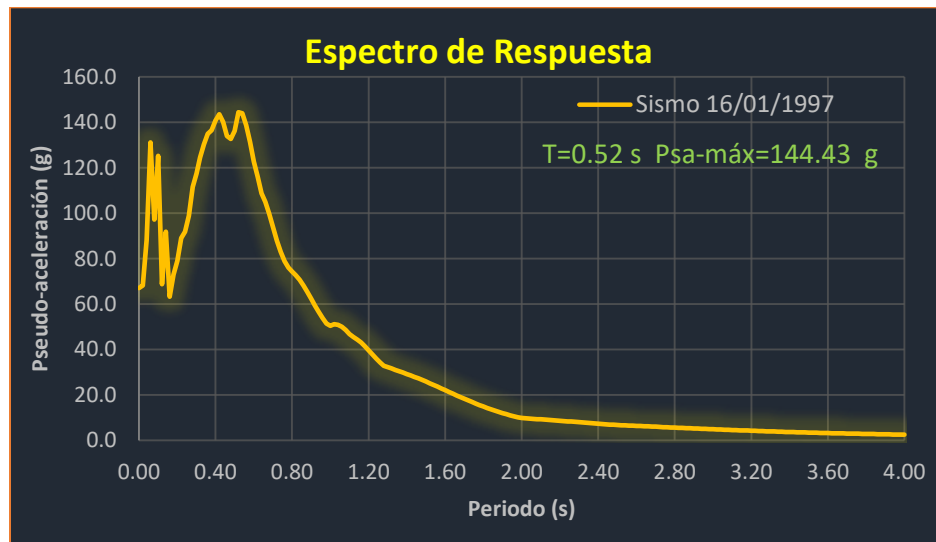
Figura 66. Espectro de respuesta de pseudoaceleración del sismo 16/01/1997.
