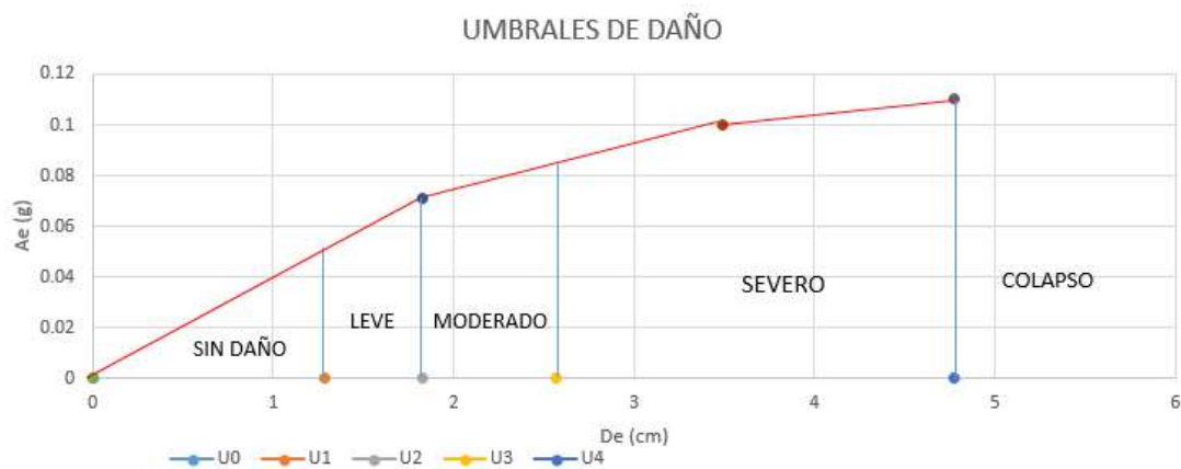
Figura 82. Estado Límite SLV, se aprecia el momento en el que se presentan los daños de acuerdo a su desplazamiento espectral.
