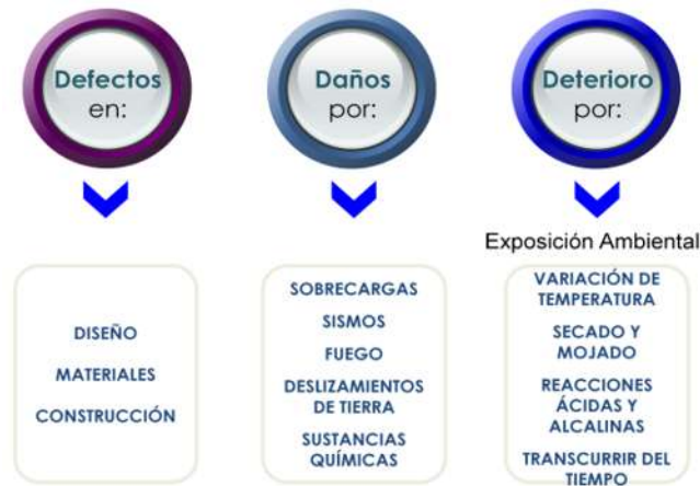
Figura 17. Clasificación general de las patologías en las edificaciones (Astorga & Rivera, 2009)
