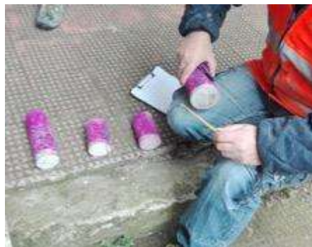
Figura 27. Observación de los núcleos de concreto sometidos a la prueba de carbonatación. (Corso di Vittorio No. 23).
