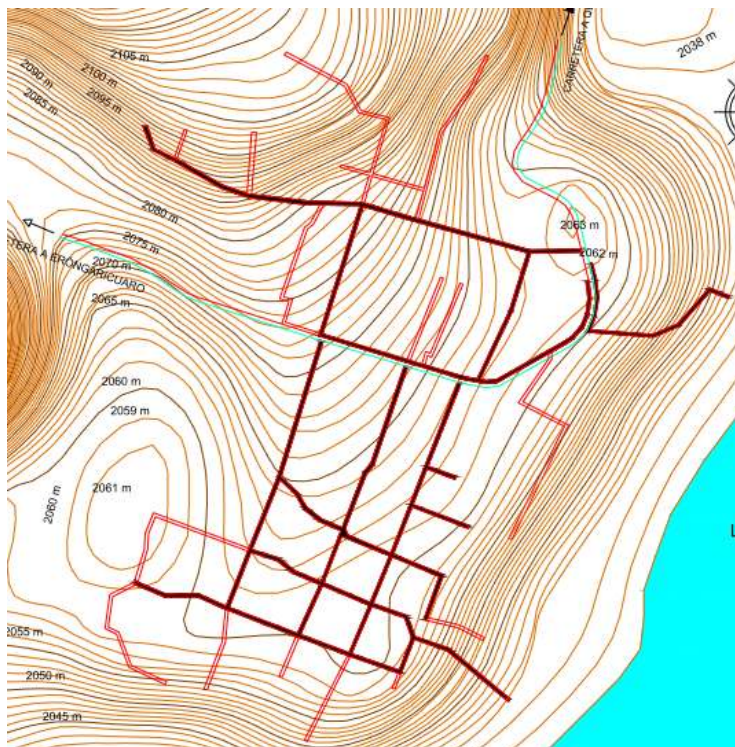
Figura 5.2. calles pavimentadas de la población.
