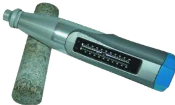
Fig. 17 Esclerómetro (Martillo de Schmidt)
