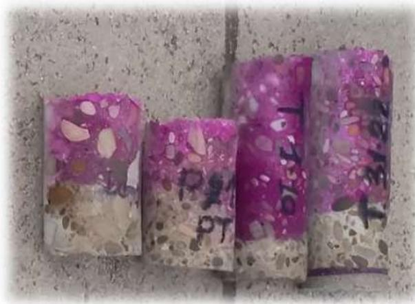
*Fig. 16 Muestra de carbonatación en columnas y vigas
