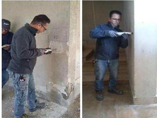
*Fig. 18 Medición de rebote con esclerómetro
