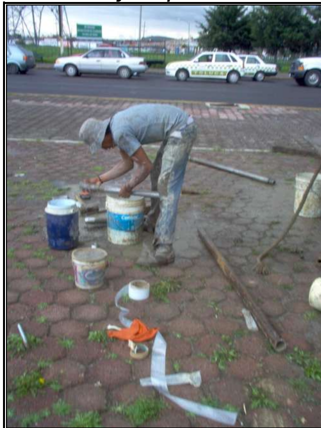
Obtención de muestras alteradas, mediante el método de penetración
