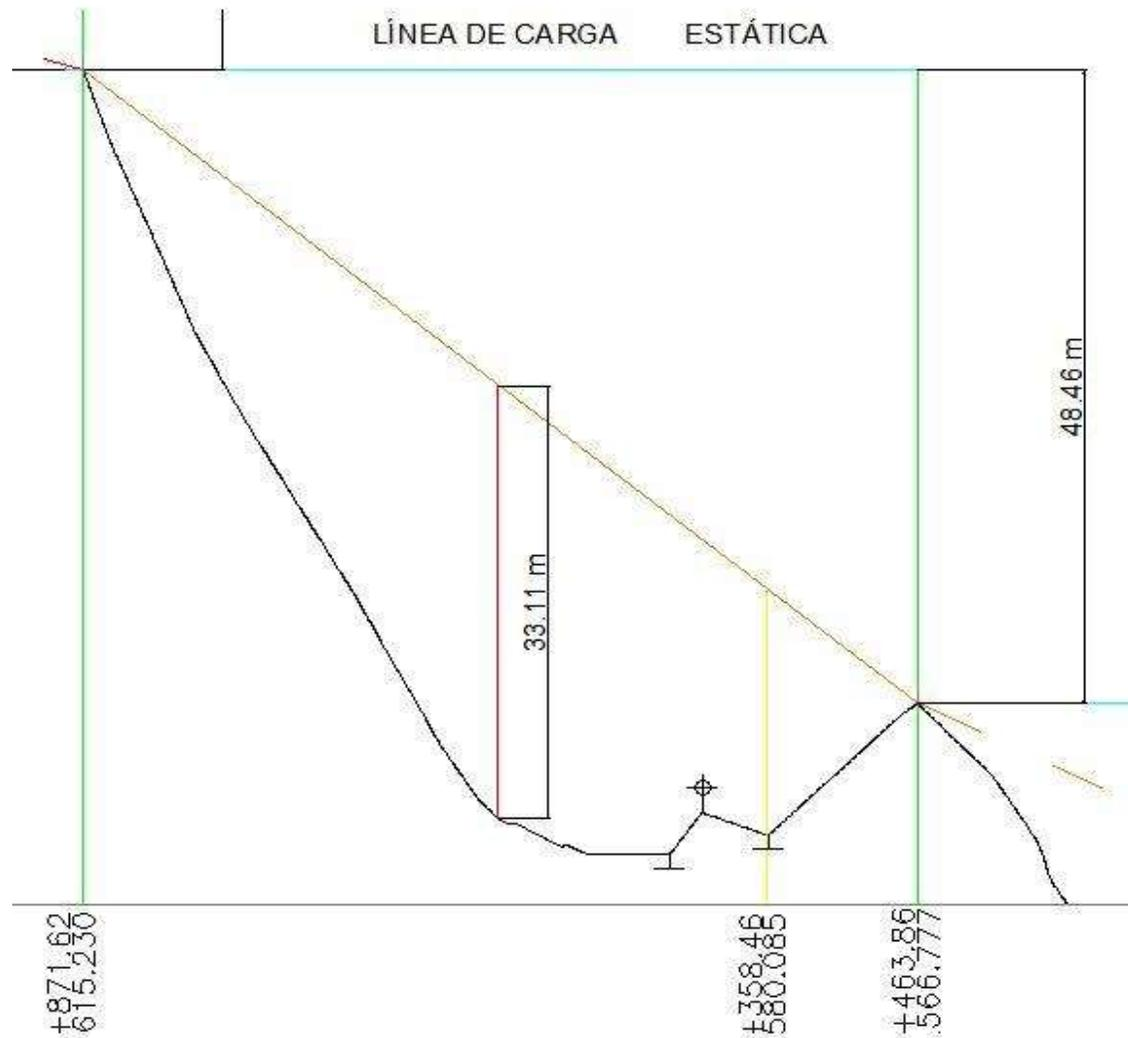
**Figura 5.24.-Trazo de la nueva línea de conducción propuesta (Parte 3 de 10).**
