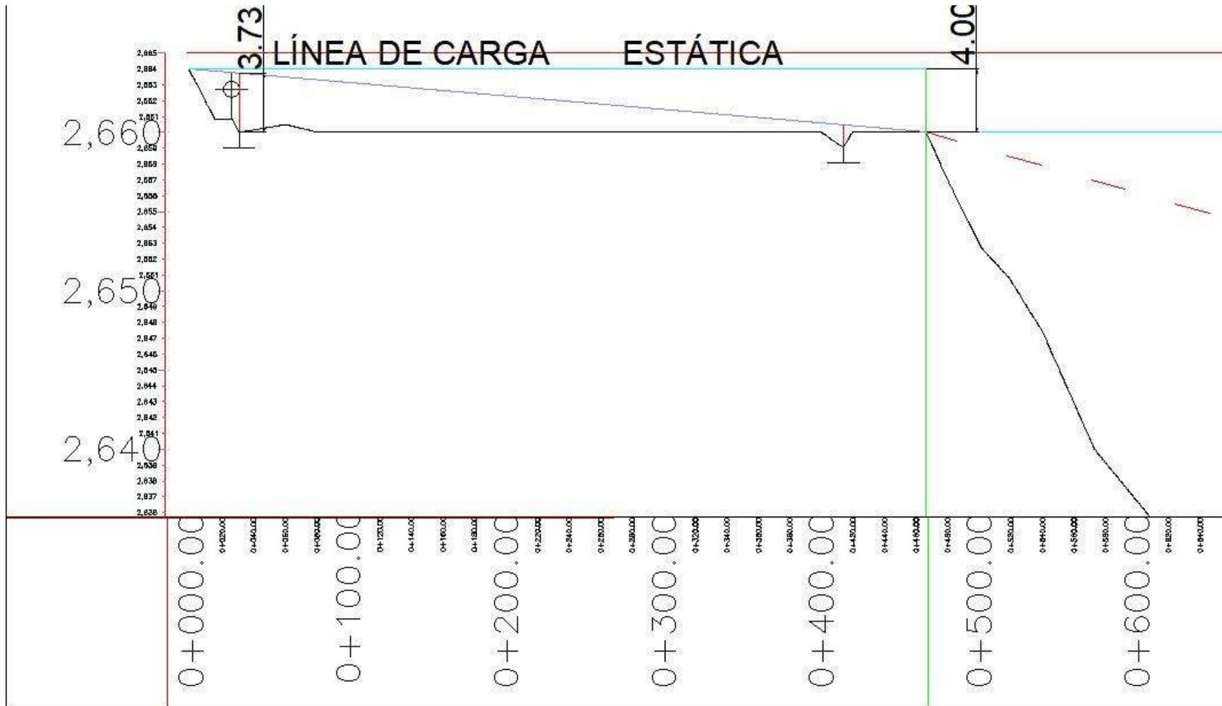
**Figura 5.22.-Trazo de la nueva línea de conducción propuesta (Parte 1 de 10).**
