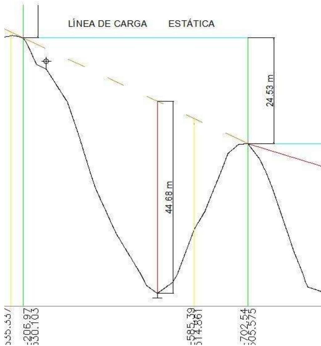
**Figura 5.26.-Trazo de la nueva línea de conducción propuesta (Parte 5 de 10).**
