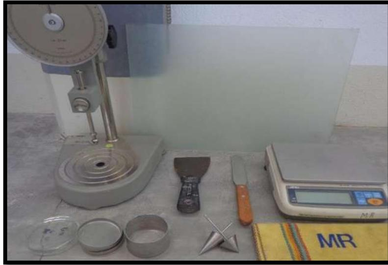
**Figura 4.13.** Equipo utilizado, LL (%) con los conos de penetración.
