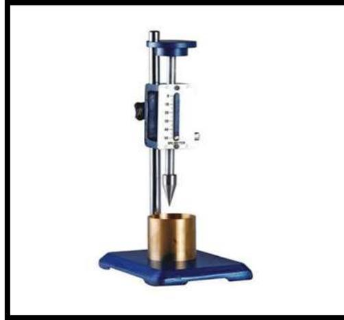
**Figura 2.7.-** Equipo de penetración, cono Inglés (Mindiamart ®).
