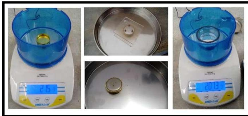
**Figura 4.35.** Determinación del volumen del molde.
