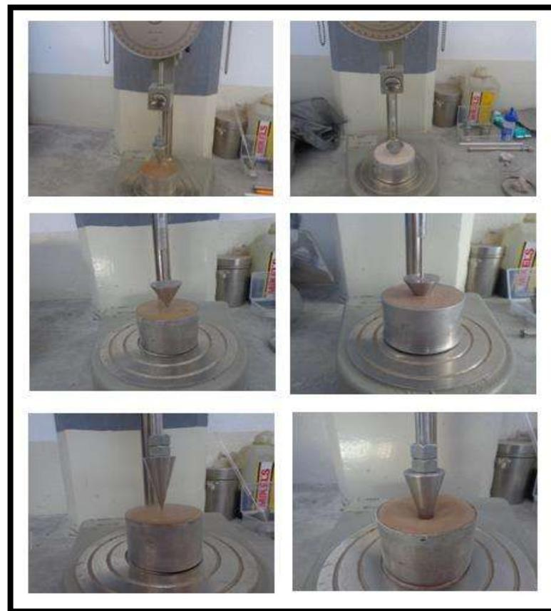
**Figura 4.15.** Penetración de los conos Sueco e Inglés.
