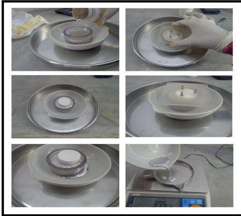
**Figura 4.34.** Determinación de la CV (%) del suelo.
