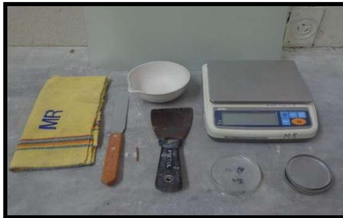
*Figura 4.23. Equipo empleado para determinar el PL (%).*
