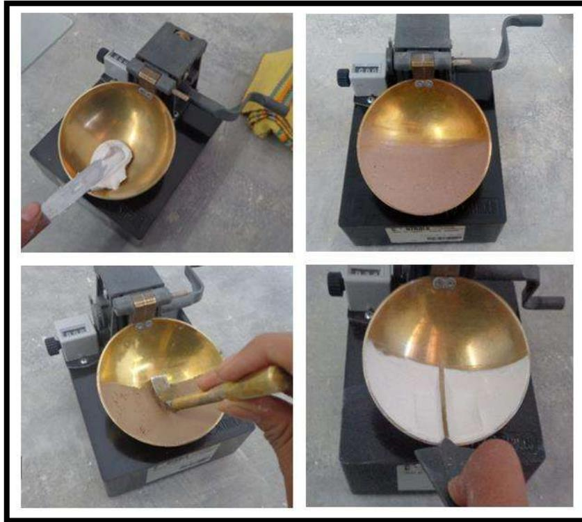
**Figura 4.9.** Colocación y ranura del material en la copa de Casagrande.
