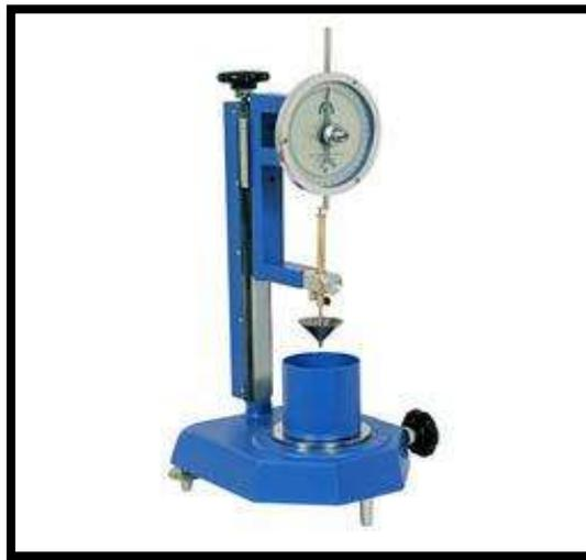
*Figura 2.6.- Equipo de penetración, cono Sueco (Mindiamart ®).*
