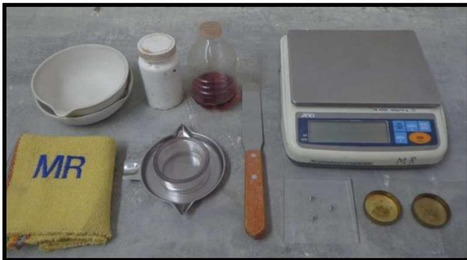
*Figura 4.32. Equipo utilizado para determinar CV (%).*
