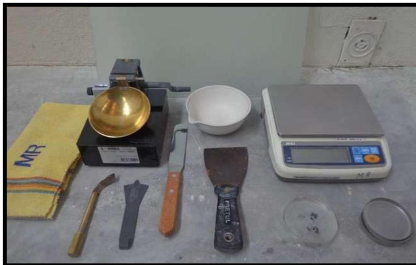
**Figura 4.7.** Equipo utilizado, LL (%) con la copa Casagrande.
