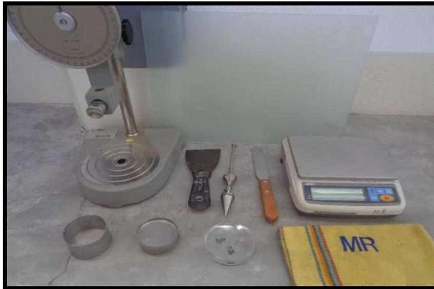
*Figura 4.25. Equipo utilizado para obtener el límite plástico a través del cono Inglés.*
