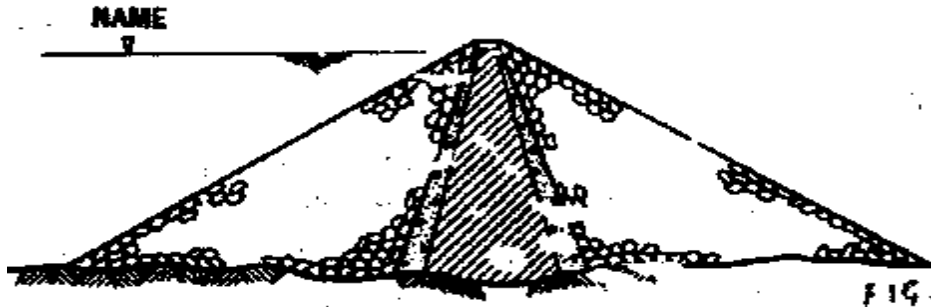
Figura 4.1.1 Presa de enrocamiento
