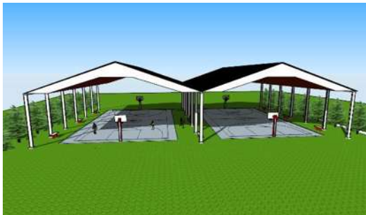
Figura 4(c) Sombra ejercida a las 2:30pm, cubierta a dos aguas
