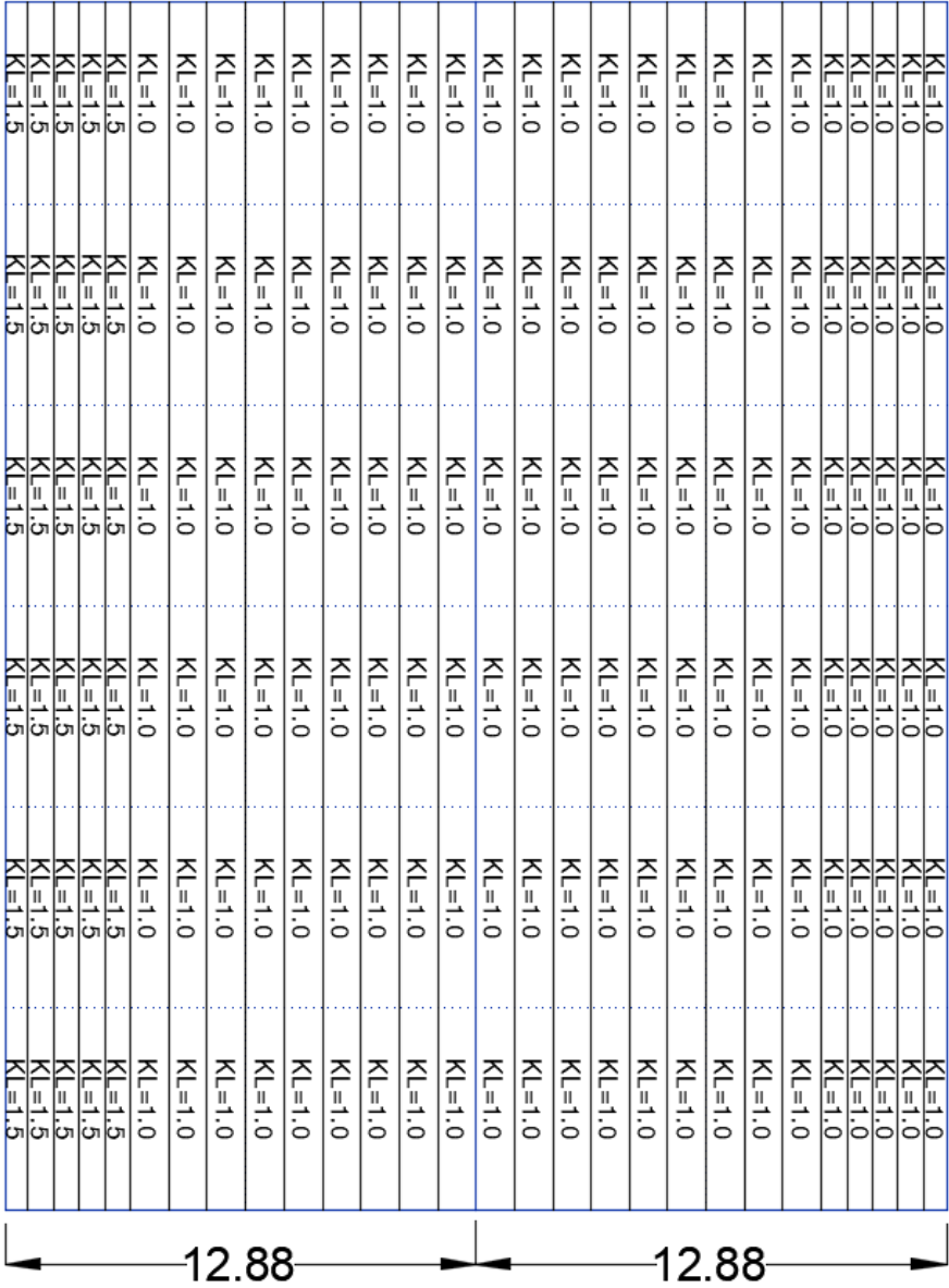
Figura AEAA1.2.2(g) Factores de presión local, para viento normal a las generatrices
