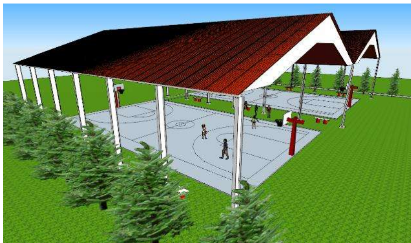
Figura 1(a) Cubierta a dos aguas
