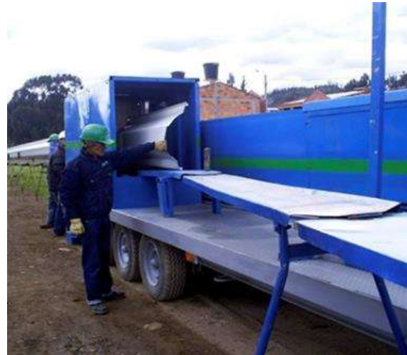
Imagen 6(b) Lámina sometida a proceso en la roladora para obtener la forma y dimensiones deseadas
