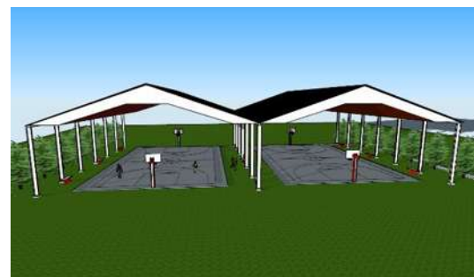
Figura 4(h) Sombra ejercida a las 5:00pm, cubierta a dos aguas
