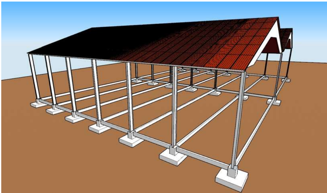
Figura 3(c) Esqueleto estructural y sistema de cimentación
