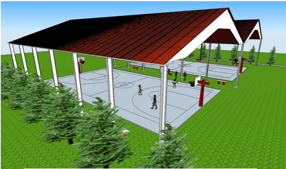
Figura 6(c) Estructura con cubierta de lámina galvanizada a dos aguas
