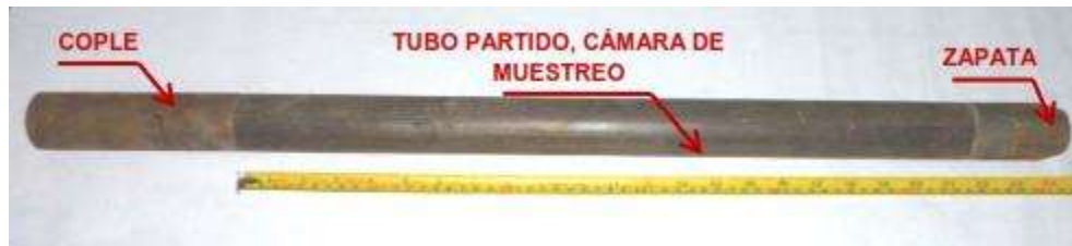
Figura 49 Penetrómetro estándar utilizado en México
