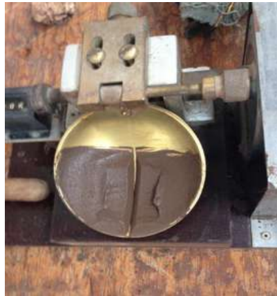
Figura 13 Copa de Casagrande con suelo homogenizado
