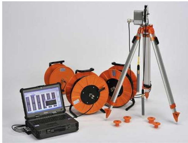
Figura 45 Equipo SCXT3000 Cross-Hole sonic logging system
