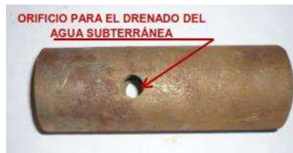
Figura 51 Drenado de agua
