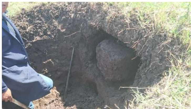
Figura 16 PCA o Muestra a cielo abierto
