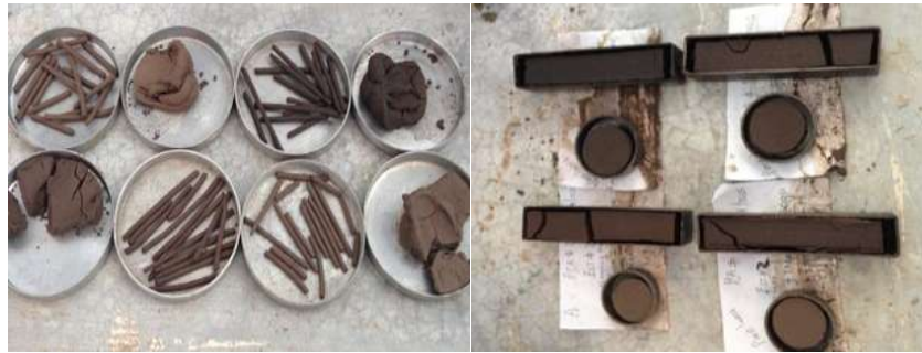
Figura 14 Limite Plástico y Contracción Lineal
