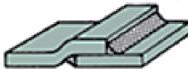
Fig. 7.9 Soldadura traslapada al ras.
