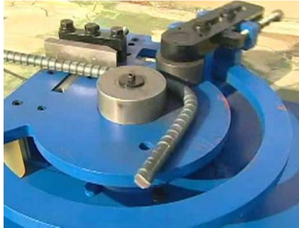
Fig. 3.5 Doblado de acero en la dobladora eléctrica.
