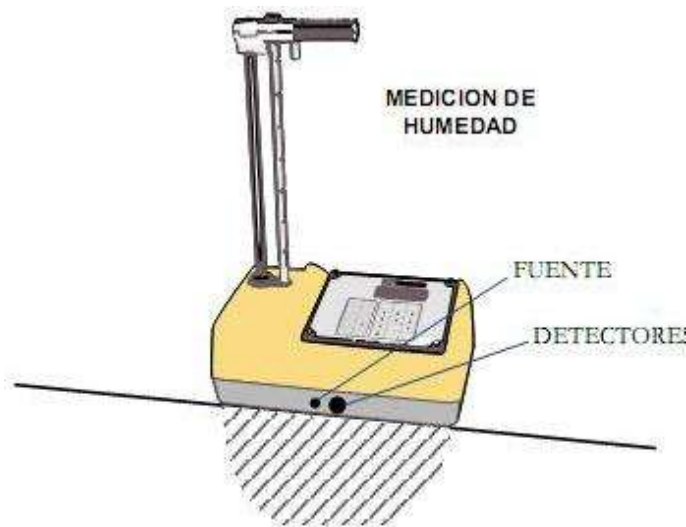
Fig. 2.12 Densímetro nuclear a modo de retrotransmisión.
